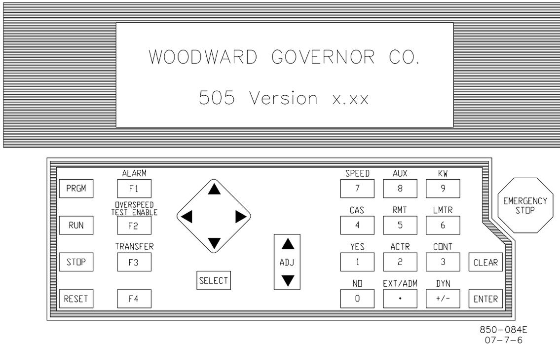
Figure 1-8. 505 Keypad and Display
