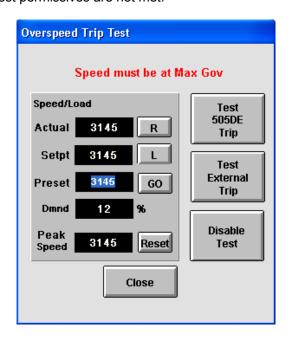
Figure 4-6. Overspeed Test Perms Not Met
