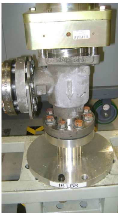
Abbildung 3-6. Stützflansch mit Auslassflansch verschraubt
