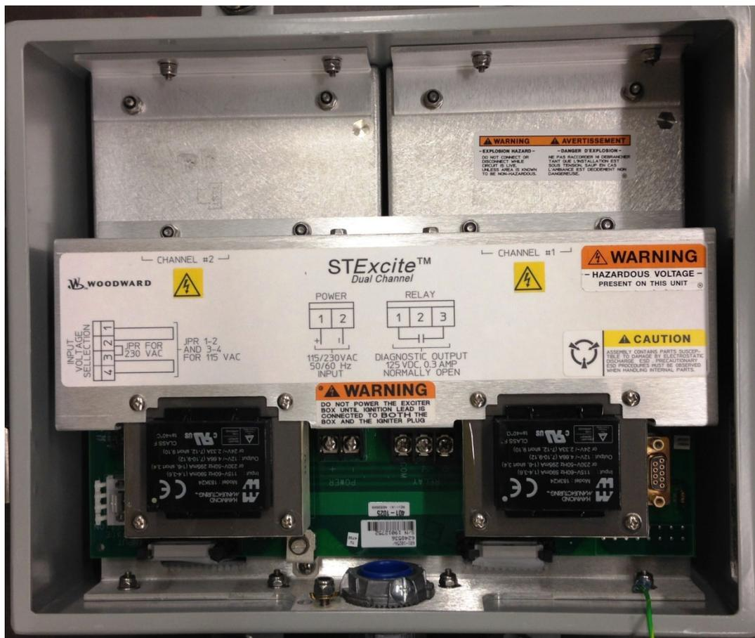
Figura 1-5. Control STExcite de canal doble (cubierta retirada)
