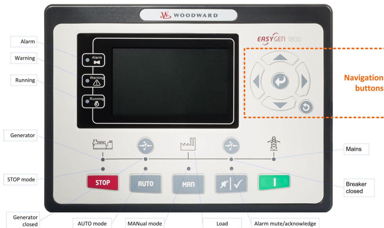
Fig. 2: HMI (pannello frontale) easYgen-1800
