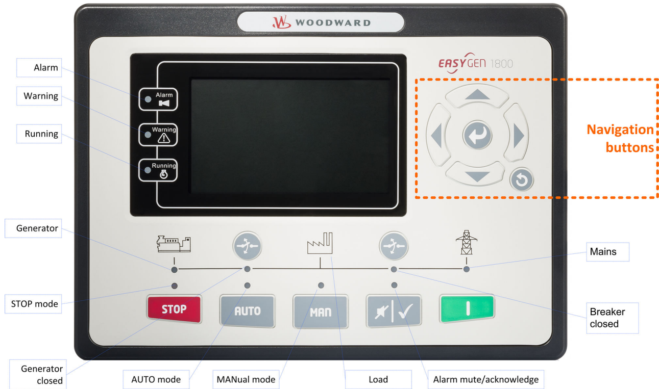
図 2: HMI (フロント パネル) easYgen-1800
