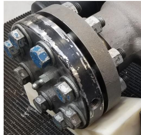
그림 3-2. Raised Face 스타일 분기 슬리브의 그림
