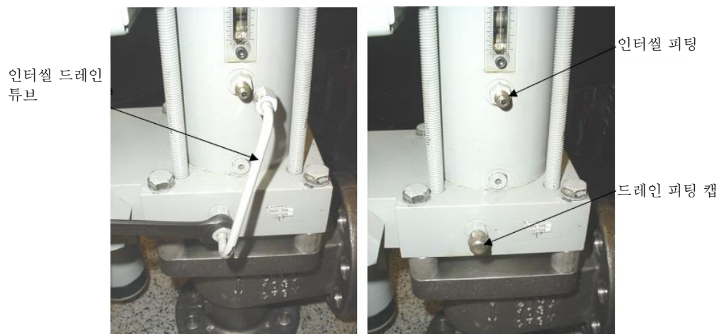
그림 4-2. 2 인치 밸브에 대해 유압 인터셀 드레인 및 캡의 위치
