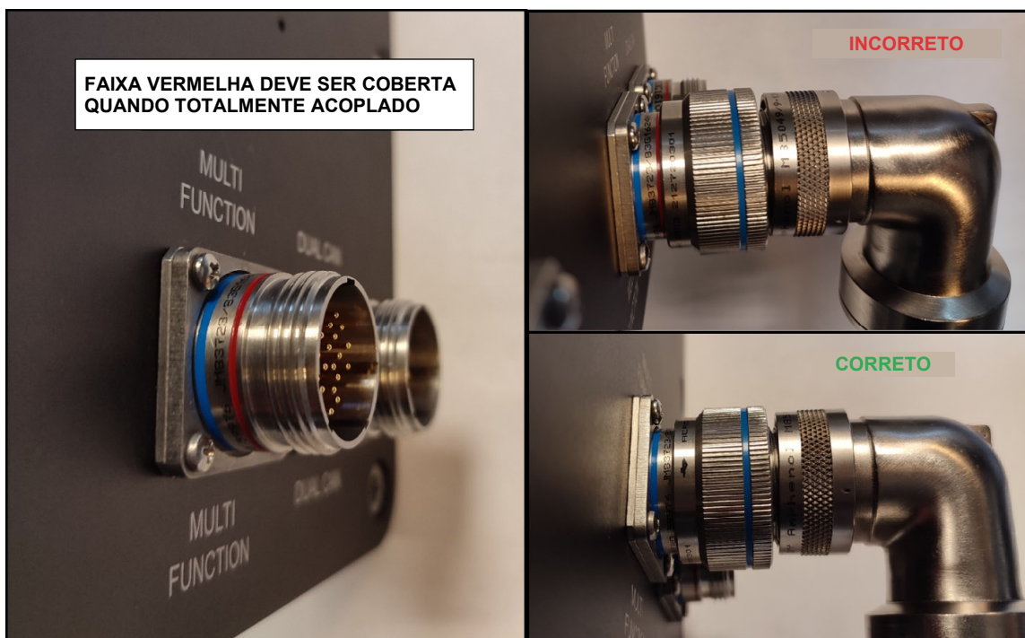
Figura 3-18. Conectores de sinal E/S e CAN
