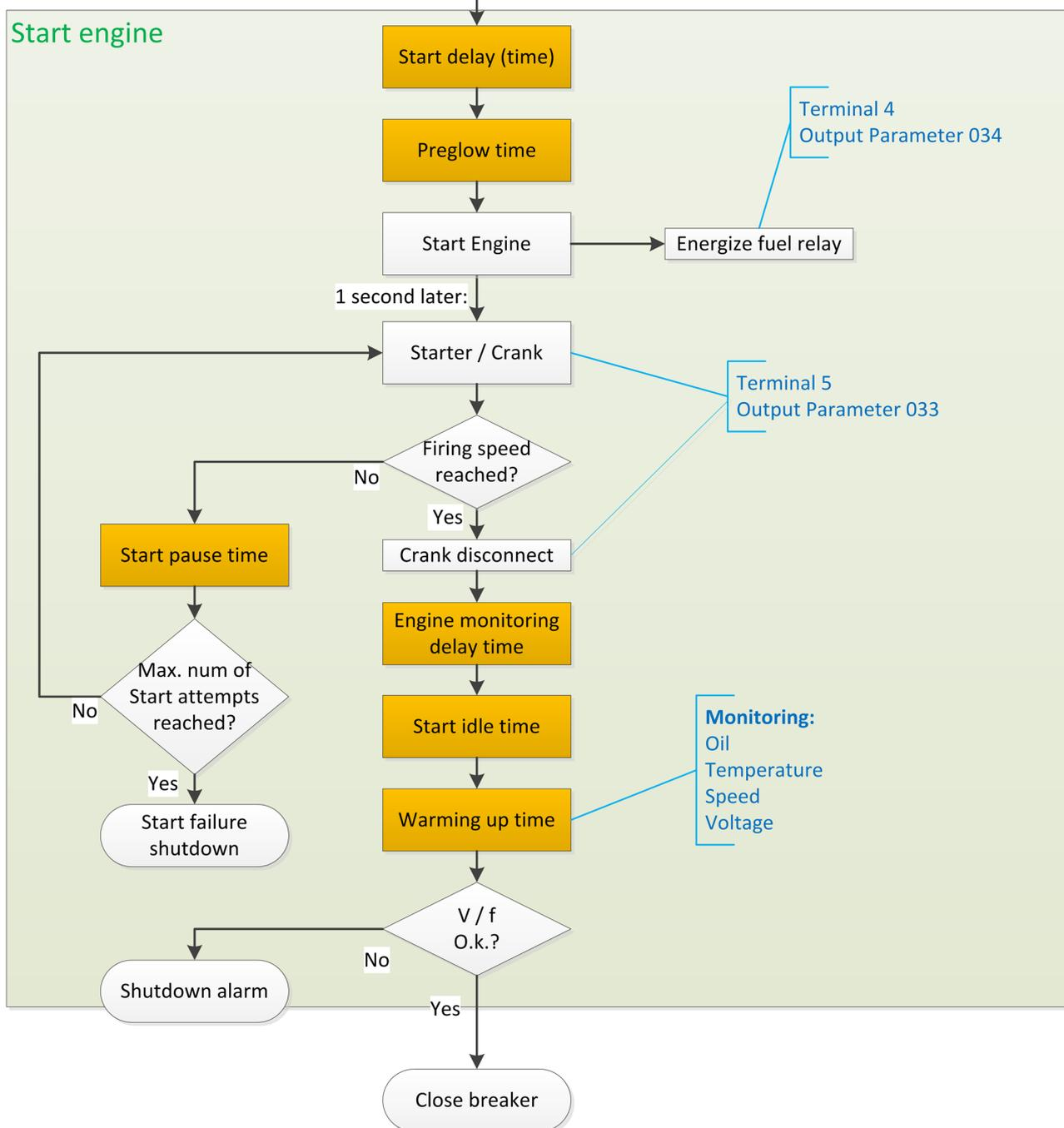
Fig. 3: Procedimento de partida do motor
