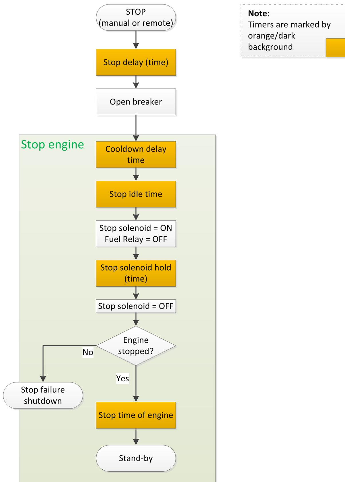
Fig. 4: Parada do motor/procedimento de espera
