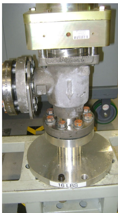
Hình 3-6. Mặt bích đỡ được bắt vít vào mặt bích đầu ra
