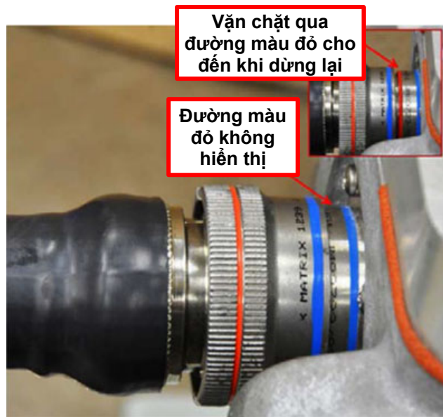
Hình 3-10. Đầu nối ID Module/bộ truyền động cảm biến trực
