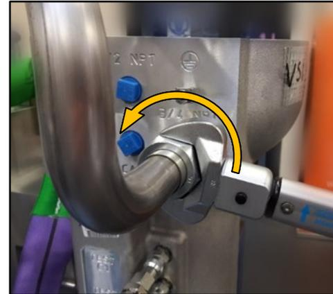
**Figure 2-21. VariStroke Conduit Nut Loosening**
