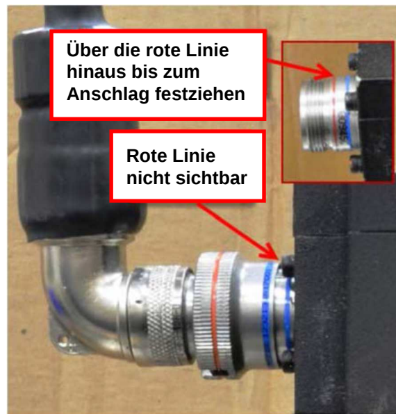
Abbildung 3-5. Motorresolver-Steckverbinder
