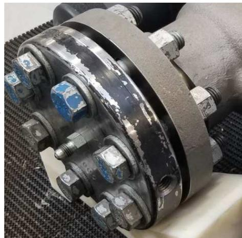
Abbildung 3-2. Abbildung der Umlenkchülse mit Dichtleiste
