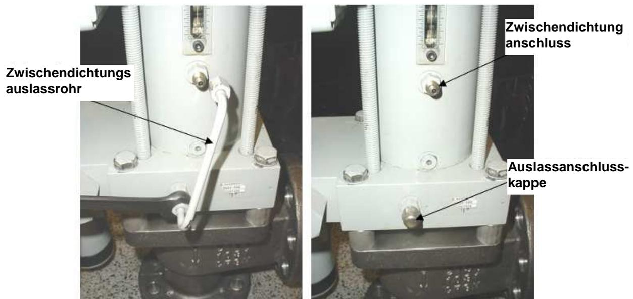
Abbildung 4-2. Lage des Hydraulik-Zwischendichtungsauslasses und der Kappe von 2-Zoll-Ventilen
