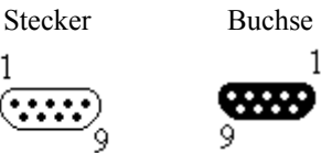
Abbildung 9-1: CAN-Bus Stiftbelegung - D-SUB DE9 Steckverbinder
