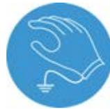
**2.** Erden Sie sich vor Wartungsarbeiten an der Steuerung, indem Sie ein geerdetes Metallobjekt greifen und halten (Rohre, Gehäuse, Gerät usw.), um eventuelle statische Elektrizität zu entladen.
