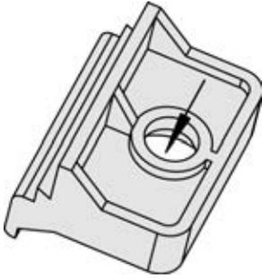
Abb. 12: Schrauben in die Klammern einsetzen
