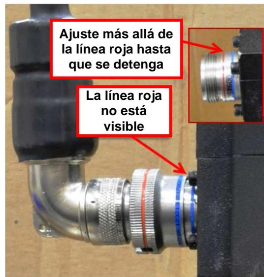
Figura 3-7. Conector de acoplamiento de resolutor del motor
