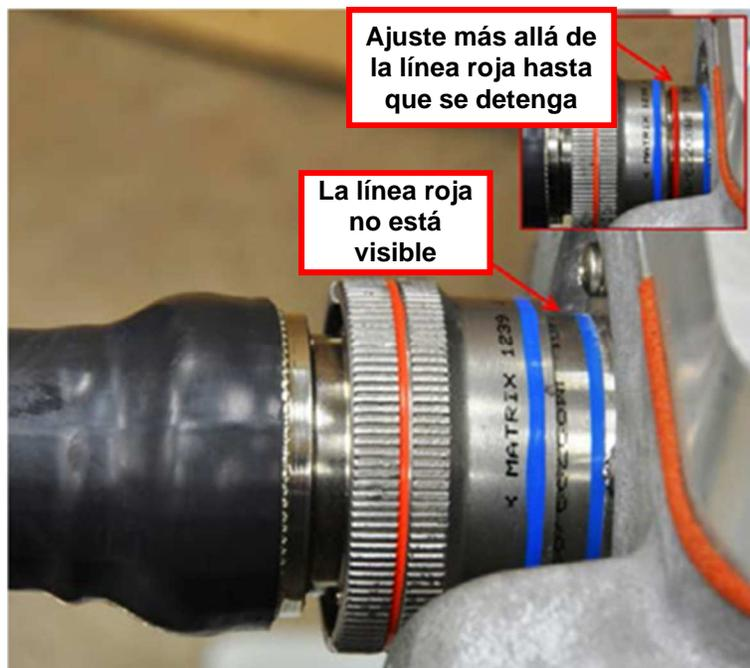
Figura 3-8. Módulo de identificación/Conector de acoplamiento de resolutor de eje
