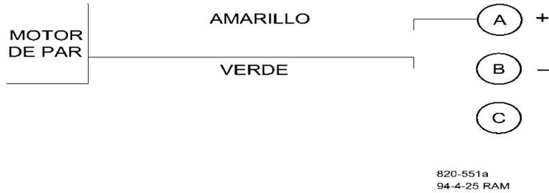
Figura 2-7a. Cableado para un Accionador UG
