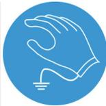
Avant d'intervenir sur les bornes de l'unité de contrôle, mettez-vous à la terre en touchant et en tenant un objet métallique relié à la terre (tuyaux, armoires, équipements, etc.) afin de vous décharger de toute électricité statique.
