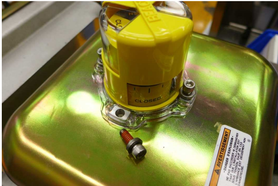
Εικόνα 2-17. Αφαίρεση δείκτη σε εξέλιξη (βαλβίδα με σήμανση IECEx)
