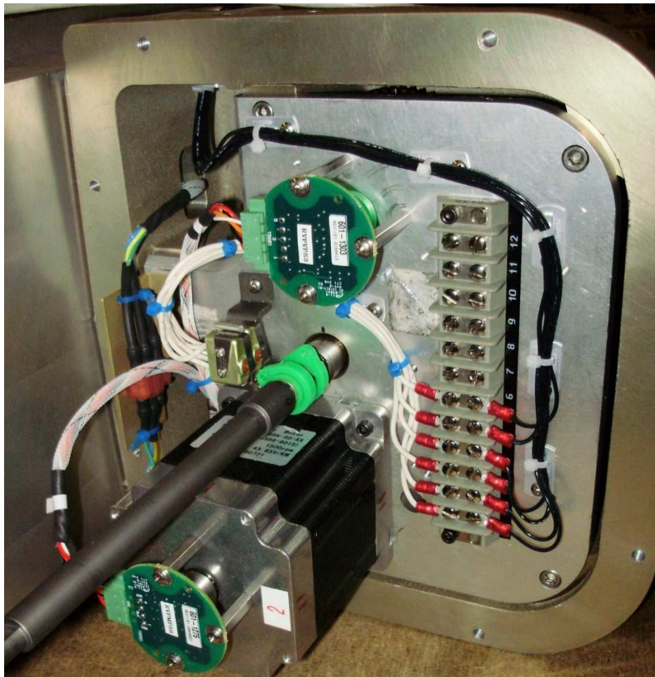
Εικόνα 2-18. Είσοδος αγωγού τερματικών διακοπών ενεργοποιητή: Επάνω αριστερά
