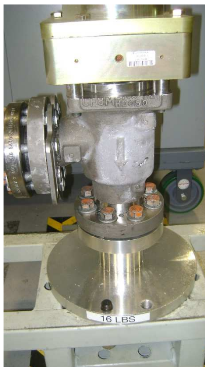
Εικόνα 3-6. Φλάντζα υποστήριξης βιδωμένη στη φλάντζα της πλευράς εξόδου
