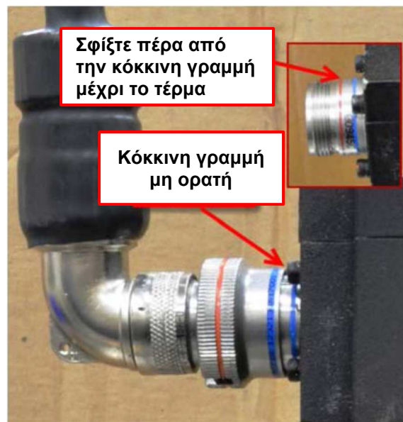
Εικόνα 3-9. Βύσματα μετατροπέα μοτέρ
