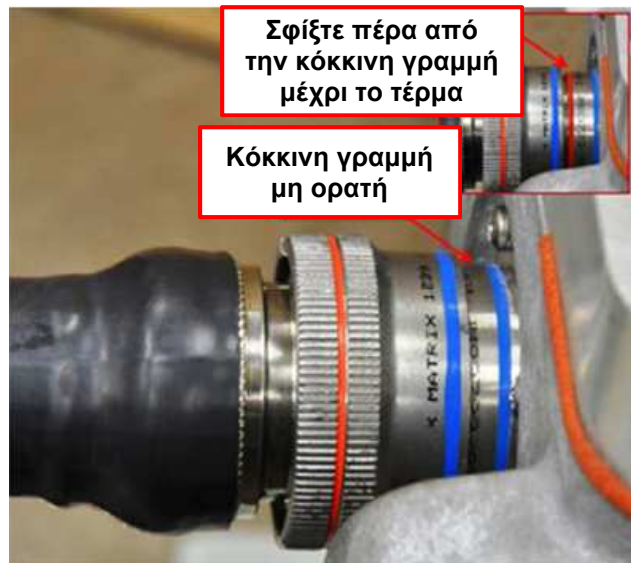
Εικόνα 3-10. Βύσμα ενεργοποιητή ηλεκτρονικής μονάδας ID/μετατροπέα άξονα
