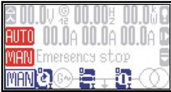
Durch das Drücken der Tasten **AUTO**, **MAN** oder **STOP** wird die Betriebsart ausgewählt. Entsprechend der ausgewählten Betriebsart werden auf dem Bildschirm unterschiedliche Softkeys aktiviert und deaktiviert. Weiterhin wird im Motor-Symbol die ausgewählte Betriebsart angezeigt. Wurde die Betriebsart STOP gewählt, leuchtet die LED rechts neben dem Taster auf.
