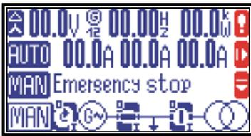
Zur Navigation zwischen den Hauptbildschirmen werden die Softkeys auf der rechten Bildschirmseite verwendet. Die Softkeys werden in Abhängigkeit des aktiven Bildschirms mit unterschiedliche Funktionen belegt.
