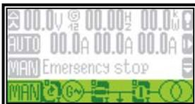
Die "Bedienung"-Ebene zeigt ein Blindschaltbild des Systems mit den aktuellen Zuständen des Motors und der Leistungsschalter an. Diese Ebene wird ebenfalls zur Direktbedienung der Anlage verwendet.
