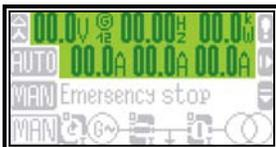
Die "Meßwerte"-Ebene zeigt alle Meßwerte inkl. Spannungen, Frequenzen und Leistungen an.
