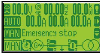
Dieser Bildschirm erscheint nach dem Einschalten des Gerätes. An dem Generatorsymbol (G) können Sie erkennen, daß in dieser Ansicht Generatorwerte angezeigt werden.
