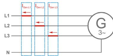
Abbildung 5-14: Strommessung - Generator, L1 L2 L3
