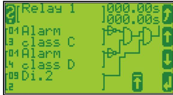
Abbildung 3-54: *LogicsManager* - Anzeige im LC-Display
