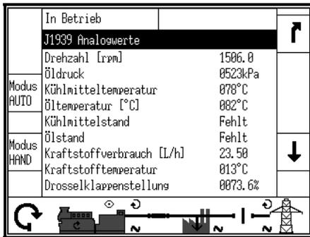
Dieser Bildschirm erscheint nach dem Drücken des Softkeys "J1939 Schnittstelle" im Bildschirm "Messwerte". Hier werden die von der angeschlossenen ECU übermittelten Werte angezeigt. Wird ein Wert nicht übermittelt, erscheint die Anzeige "Fehlt".
