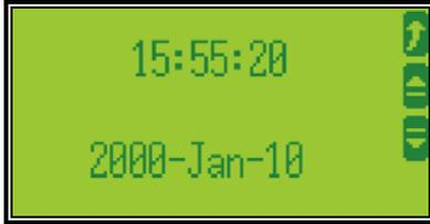
Dieser Bildschirm informiert über die aktuelle Uhrzeit sowie das aktuelle Datum. Die Uhr ist als Echtzeituhr ausgeführt. Bei einem Spannungsausfall (Versorgungsspannung) stellt eine interne Batterie sicher, daß die Informationen nicht verloren gehen. Die Daten bedeuten:
