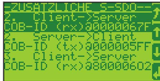
Abbildung 6-9: Anzeige - Server SDOs konfigurieren
