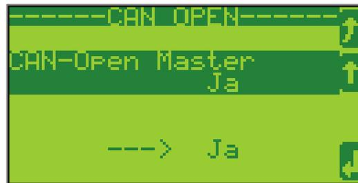
Abbildung 6-5: Anzeige - CAN-Schnittstelle konfigurieren
