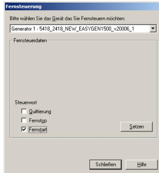
Abbildung 2-2: Datentelegramme - Fernsteuerung über CAN
