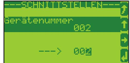
Abbildung 6-7: Anzeige - Gerätenummer konfigurieren
