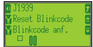
Lange Blinksignale (ca. 1 s) geben Zehnerstellen, kurze Blinksignale (ca. 0,4 s) geben Einerstellen an. Dazwischen ist jeweils eine ca. 0,5 s lange Pause. Nachfolgendes Beispiel stellt Blinkcode 14, Kühlmitteltemperatur-Sensor, dar (lang-kurz-kurz-kurz-kurz = 10+1+1+1+1):
