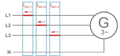
Abbildung 6-32: Strommessung - Generator, L1 L2 L3
