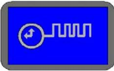
SEQUENCE ステータス・キーを押すと、自動併入を行う多重ユニット・システムでの自動シーケンス機能の情報を表示します。シングル・ユニット・システムや AUTO モードで運転されていないシステムでは、この画面で何の情報も表示されません。
