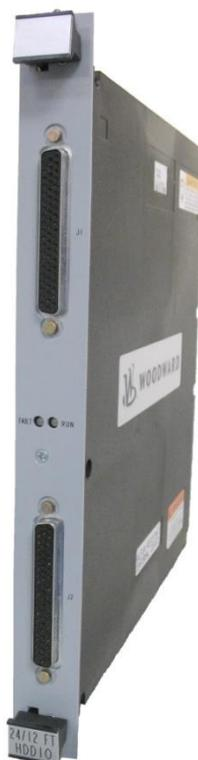
図 7-2. MicroNet TMR ディスクリート I/O Smart-Plus モジュール
