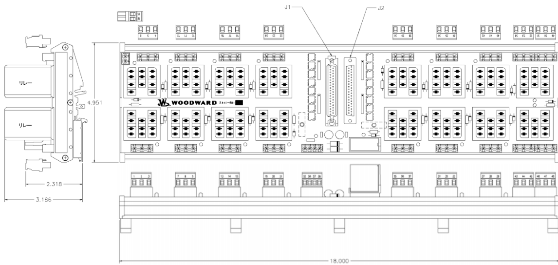
図 12-58. 16 チャンネルリレーモジュール(フェニックスコンタクト)外形寸法
