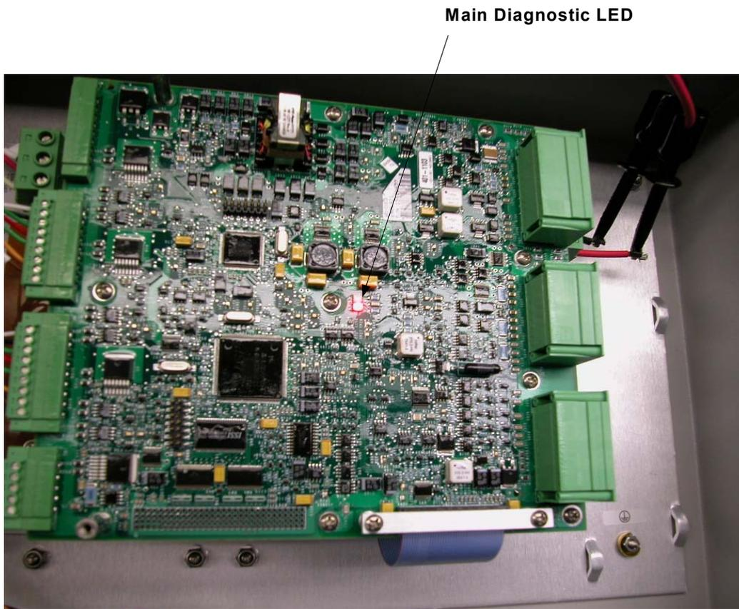
図 4-3 DVP IP56 エンクロージャのメイン診断 LED
