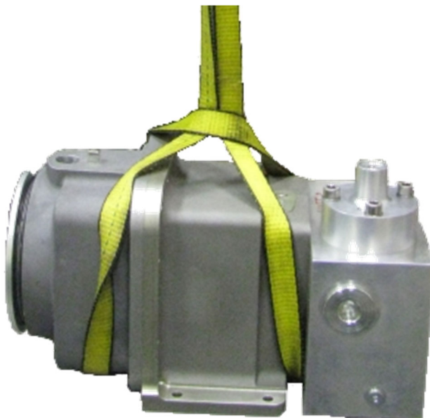
図 2-2. 弁を吊り上げる時はスリングを使う
