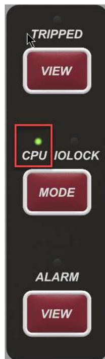
図 17-5. フロントパネルの CPU SYCON/BACKUP LED 表示
