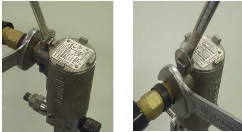
그림 2-10. 도관 피팅 또는 케이블 글랜드를 조일 때 솔레노이드를 지탱하는 모습 (Maxseal ICO3S IOM 지침, MI0294 참조)
