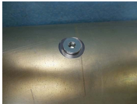
그림 7-5. 플러그가 설치된 액추에이터 본체 그리스 포트
