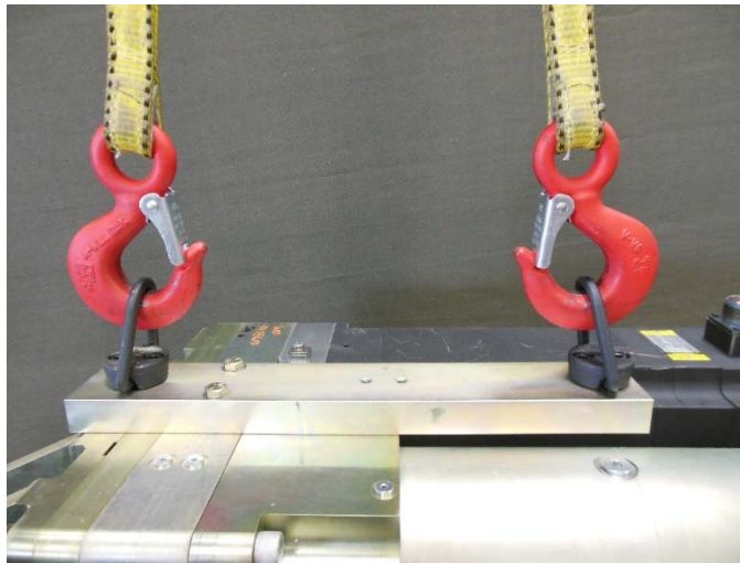
그림 3-4. 수평 리프트를 위해 부착된 리프팅 장치
