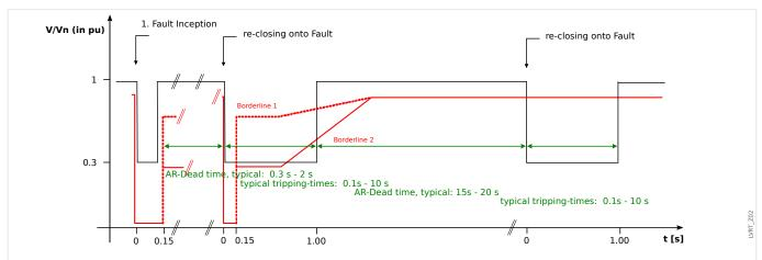
Fig. 78: Run of voltage curve during an unsuccessful two-shot auto reclosure; source: Technische Richtlinie, Erzeugungsanlagen am Mittelspannungsnetz, Ausgabe Juni 2008, BDEW Bundesverband der Energie- und Wasserwirtschaft e.V. (Page 89).
