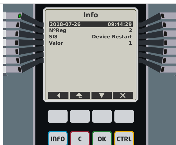
Fig. 172: Ejemplo de mensaje de reinicio.
