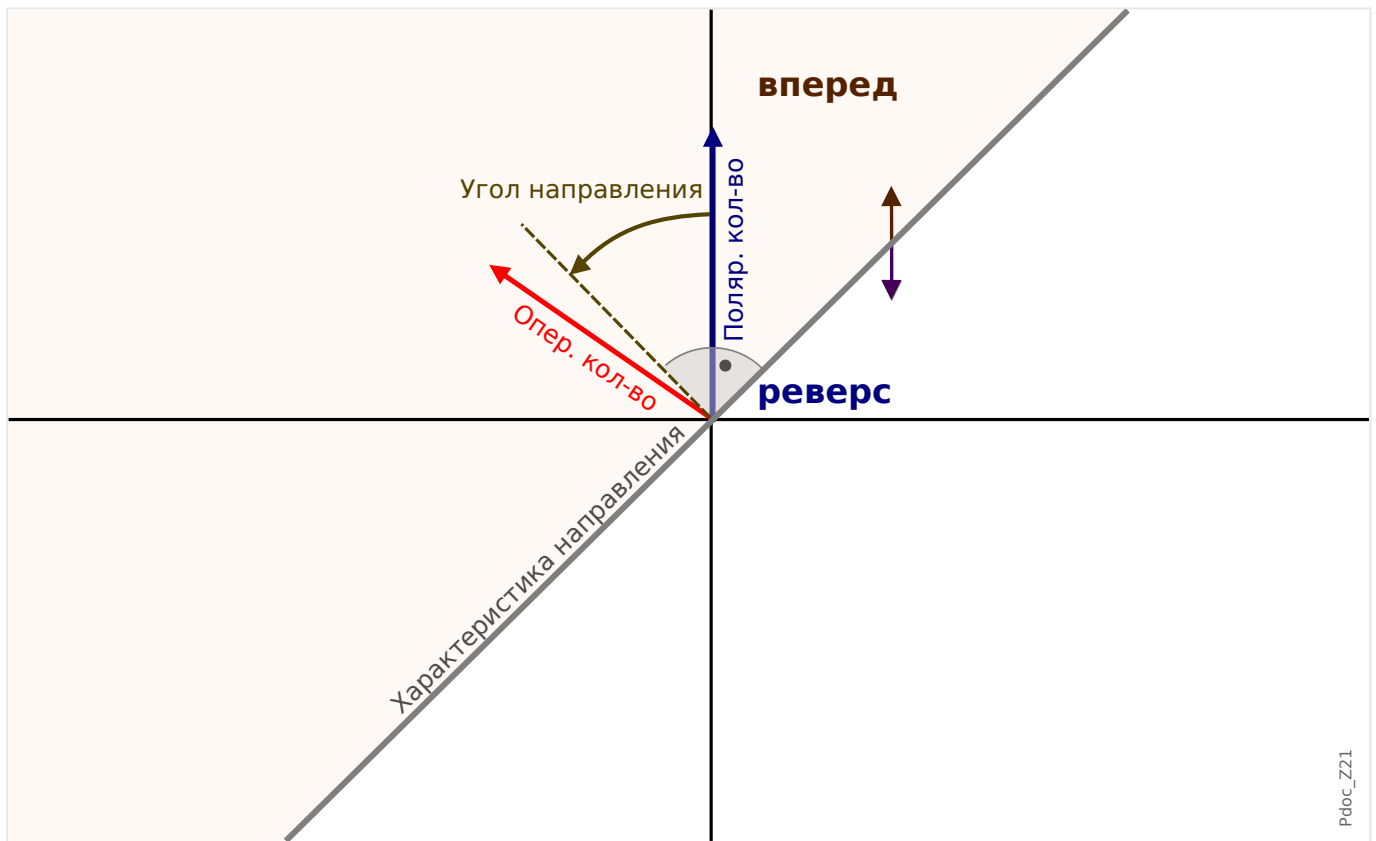
Рис. 65: Принцип определения направления межфазного короткого замыкания.
