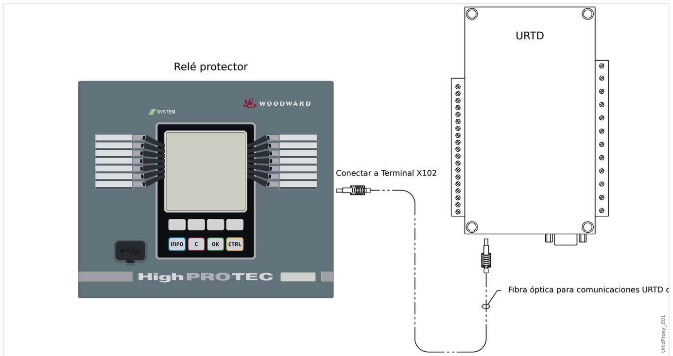
La figura anterior muestra las conexiones de fibra óptica entre el módulo URTDII y el dispositivo de protección. El dispositivo de protección es compatible con la conexión de fibra óptica.
