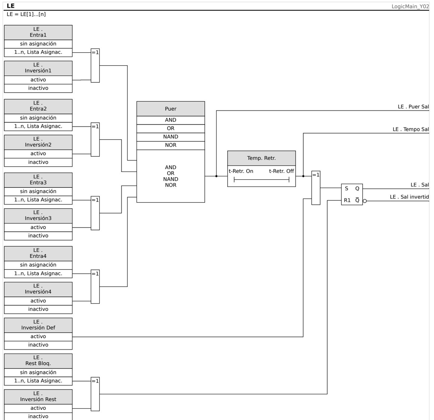
Fig. 75: Descripción detallada - Diagrama de lógica general.
