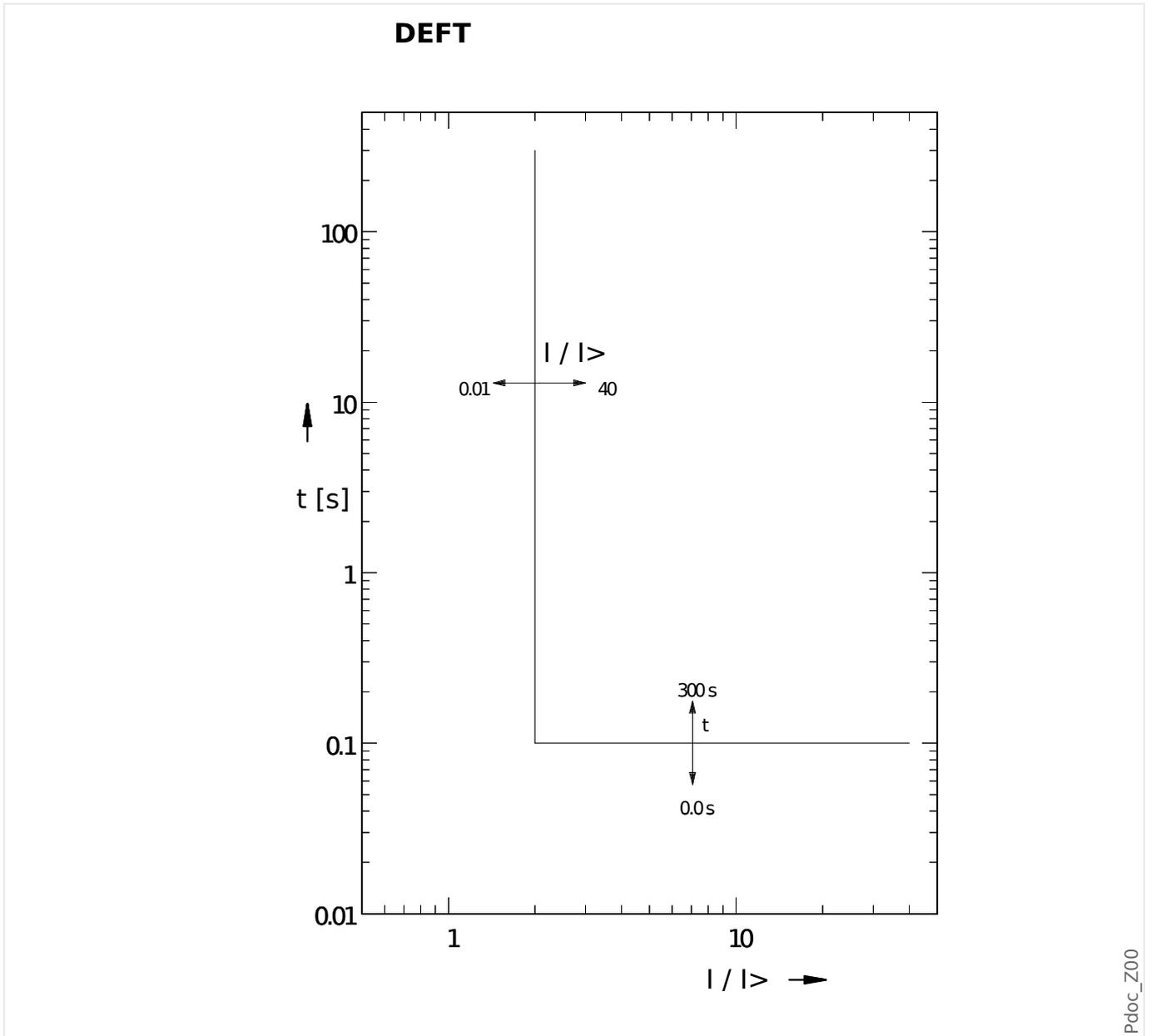
Retraso de desconexión de  $I > I >$ , configurable mediante [Parám protec / Def 1...4 / I-Prot / I[x]] »t«.
