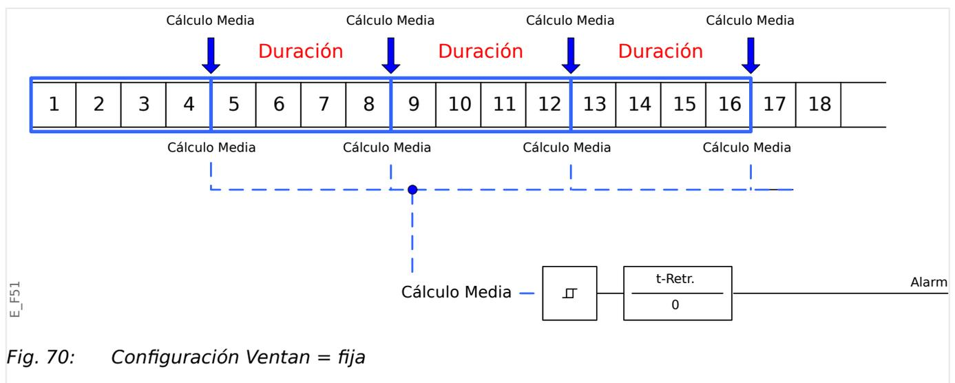
Fig. 70: Configuración Ventan = fija
