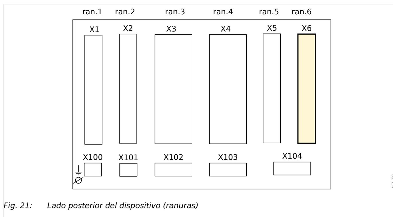
Fig. 21: Lado posterior del dispositivo (ranuras)
