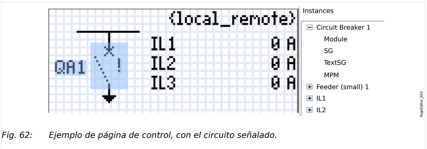
Aunque siempre aparece un conmutador usando una representación fija en el *Editor de página*, con un signo de exclamación “!” a un lado, este símbolo incluye varias representaciones: una para el conmutador cerrado, otra para el conmutador abierto, y otra para las posiciones intermedia y de fallo.
