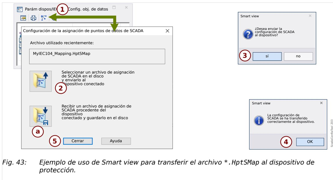
Fig. 43: Ejemplo de uso de Smart view para transferir el archivo \*.HptSMap al dispositivo de protección.
