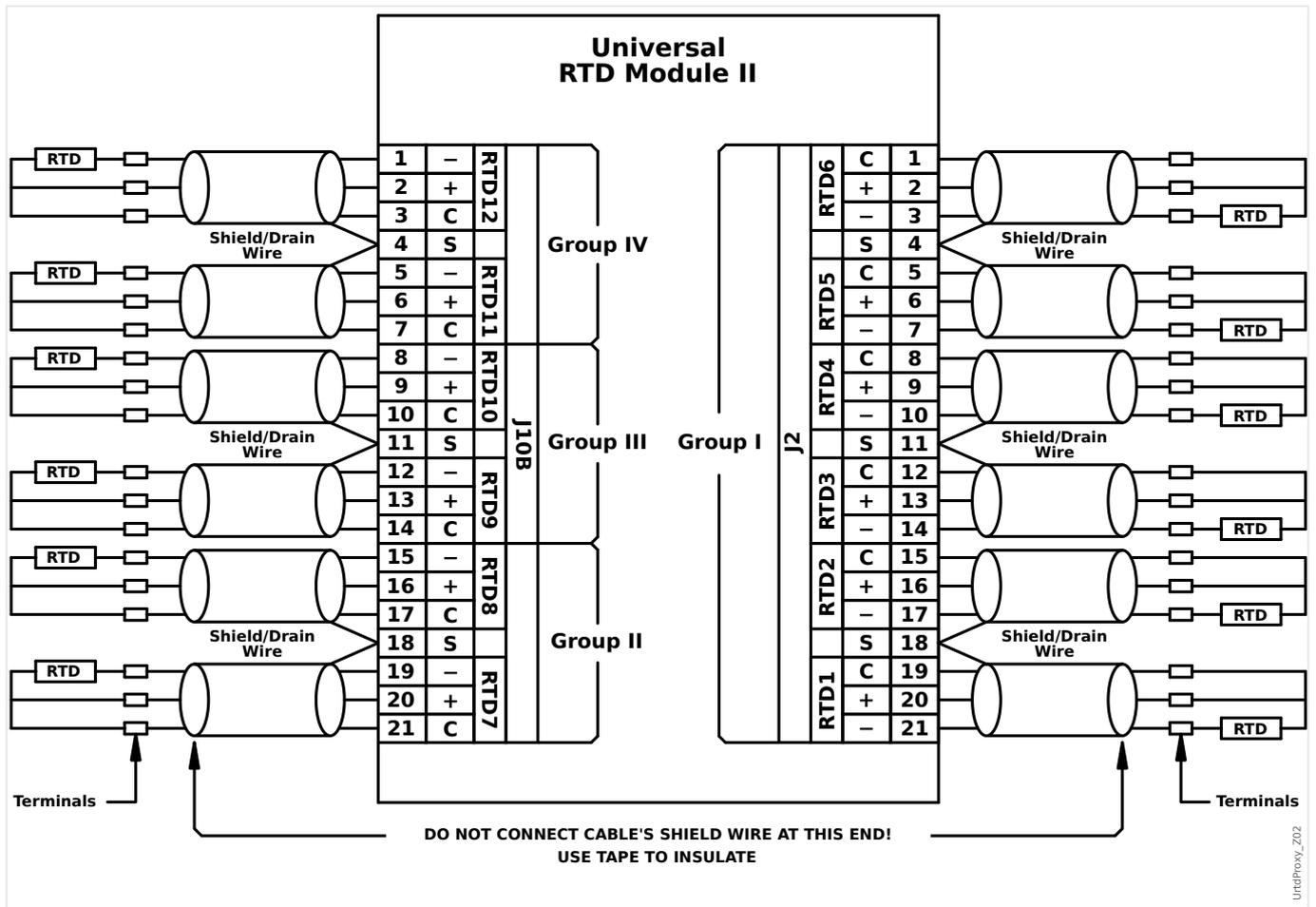
Consulte la figura anterior para el ver el cableado de los RTD a las entradas URTD. Utilice cable blindado de tres conductores. Tenga en cuenta las reglas de conexión de la figura. Al hacer las conexiones a un RTD de dos derivaciones, conecte dos de los conductores del cable a una de las derivaciones RTD tal y como se muestra. Realice esta conexión lo más cerca posible del objeto que desee proteger. Conecte el tercer conductor del cable a la derivación RTD restante.
