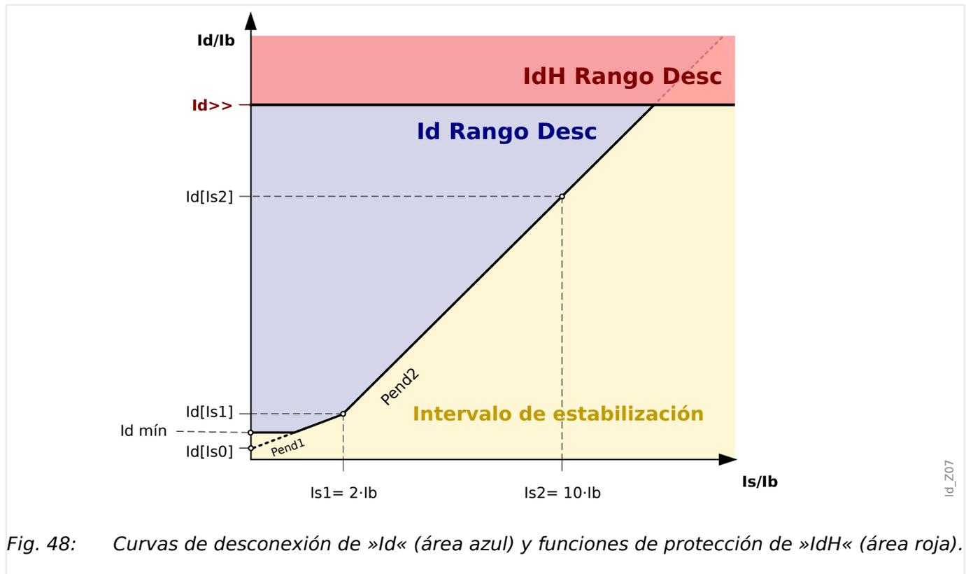
Fig. 48: Curvas de desconexión de »Id« (área azul) y funciones de protección de »IdH« (área roja).
