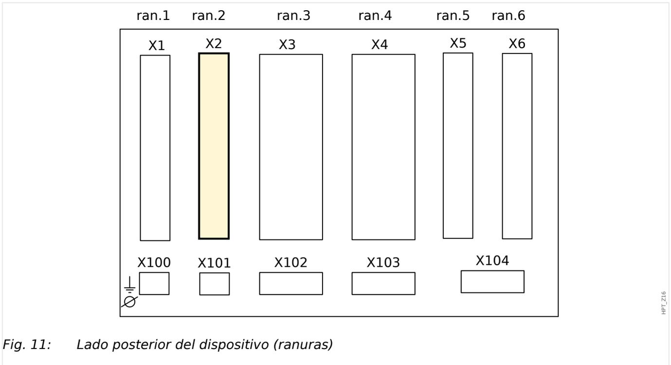
Fig. 11: Lado posterior del dispositivo (ranuras)
