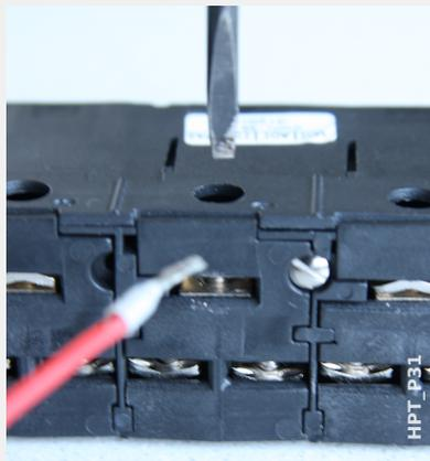
Para una conexión de terminal de clave, inserte los cables y ajústelos con los tornillos del lateral de la tarjeta de entrada.
