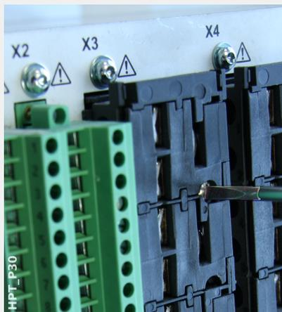
Para cada tipo de conexión, el primer paso es eliminar los terminales del dispositivo desatornillando los tornillos.
