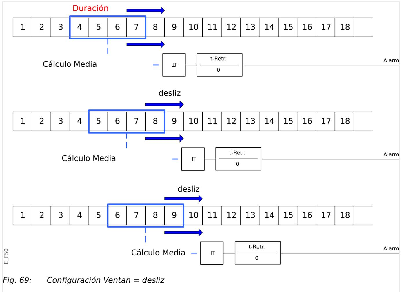
Fig. 69: Configuración Ventan = desliz
