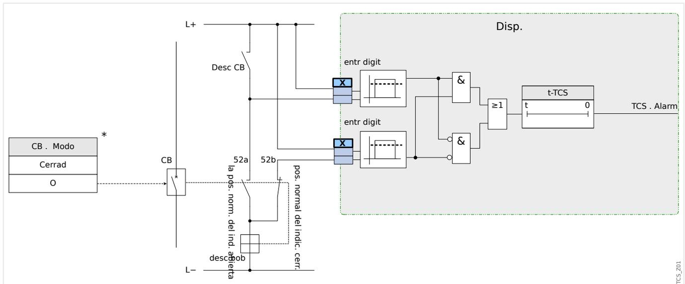
Fig. 60: Ejemplo de conexión: Supervisión del circuito de desconexión con dos contactos auxiliares CB »Aux ON« (52a) and »Aux OFF« (52b).
