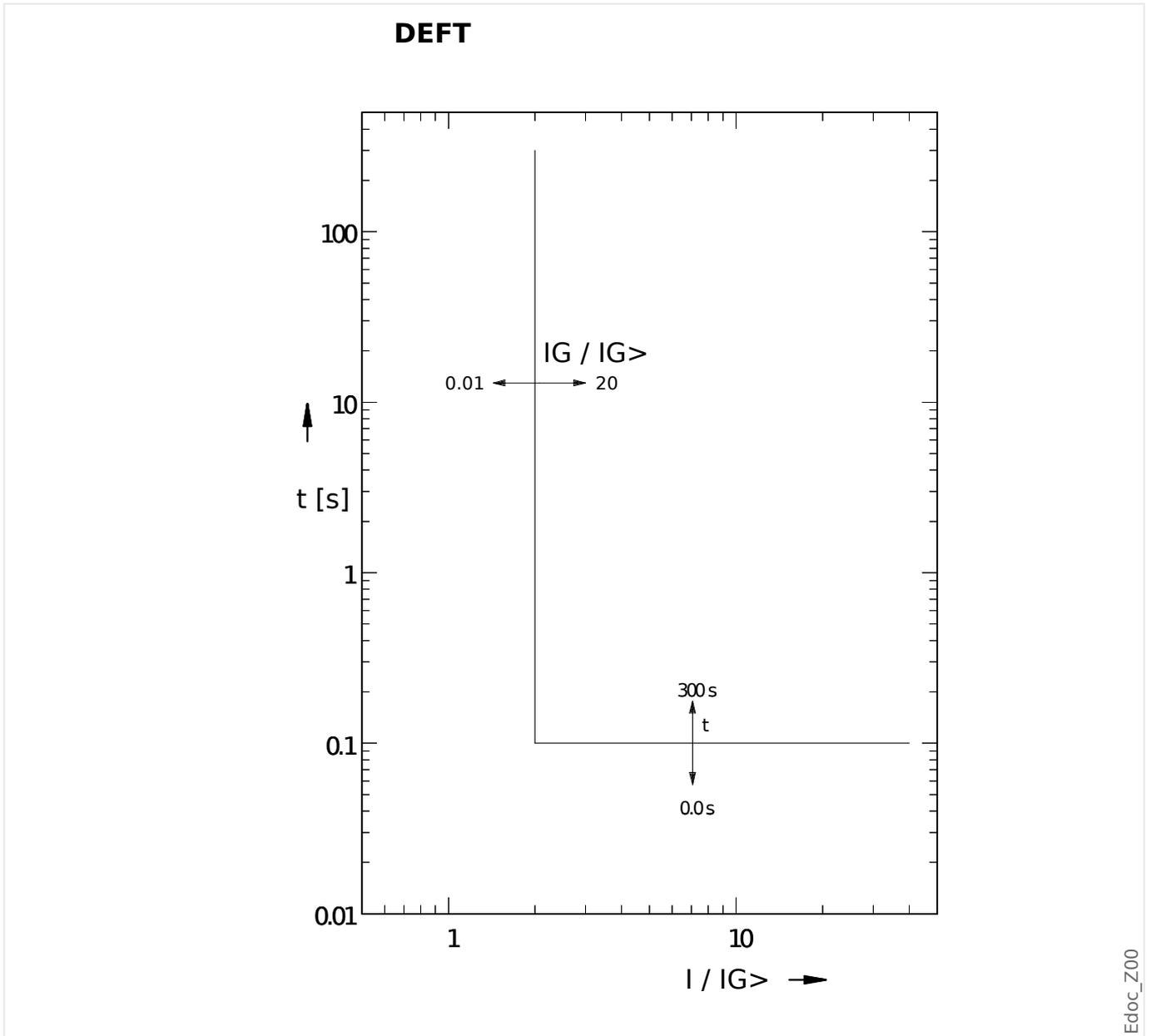
Retraso de desconexión de  $I_G > I_{G>}$ , configurable mediante [Parám protec / Def 1...4 / I-Prot / IG[x]] »t«.
