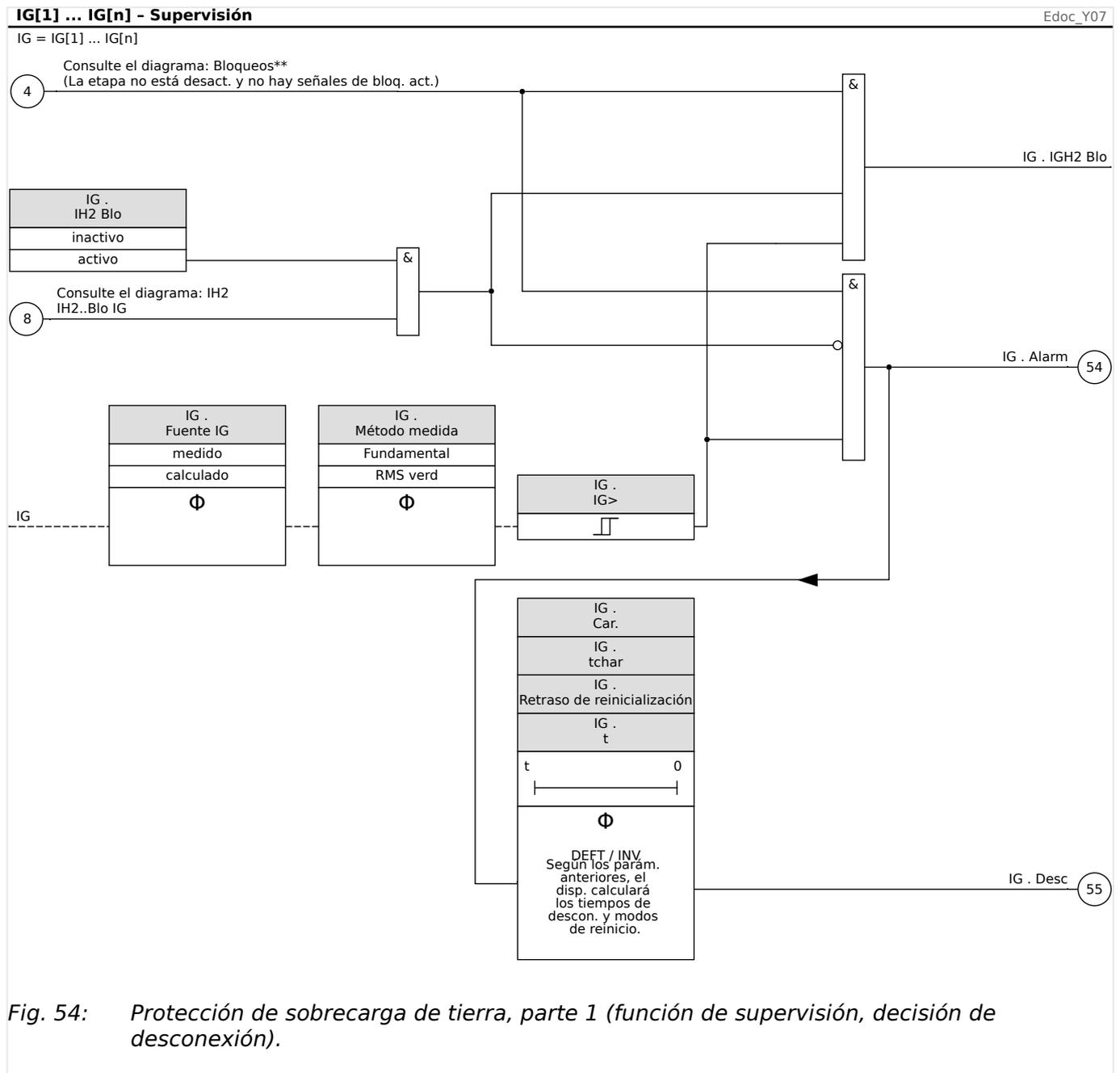
Fig. 54: Protección de sobrecarga de tierra, parte 1 (función de supervisión, decisión de desconexión).
