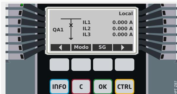
La nueva posición del conmutador se muestra en la pantalla (en cuanto se haya alcanzado, según la indicación de posición, o una vez transcurrido el tiempo que se haya configurado para la conmutación).
