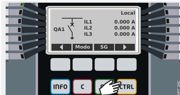
Al presionar la tecla »CTRL«, accederá a una pantalla con la línea única, y tendrá acceso directo a las funciones de control y los valores de medición relacionados.
