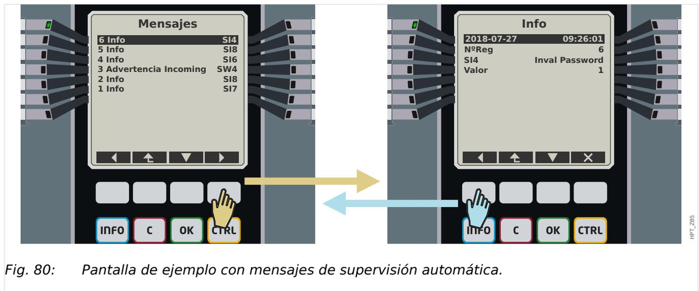
Fig. 80: Pantalla de ejemplo con mensajes de supervisión automática.
