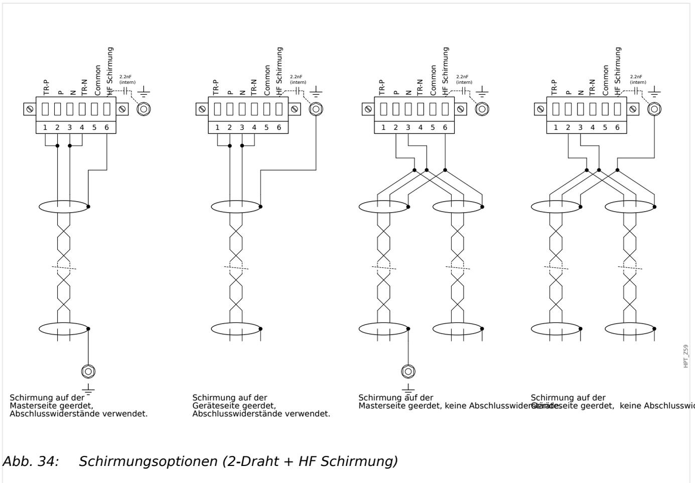
Abb. 34: Schirmungsoptionen (2-Draht + HF Schirmung)
