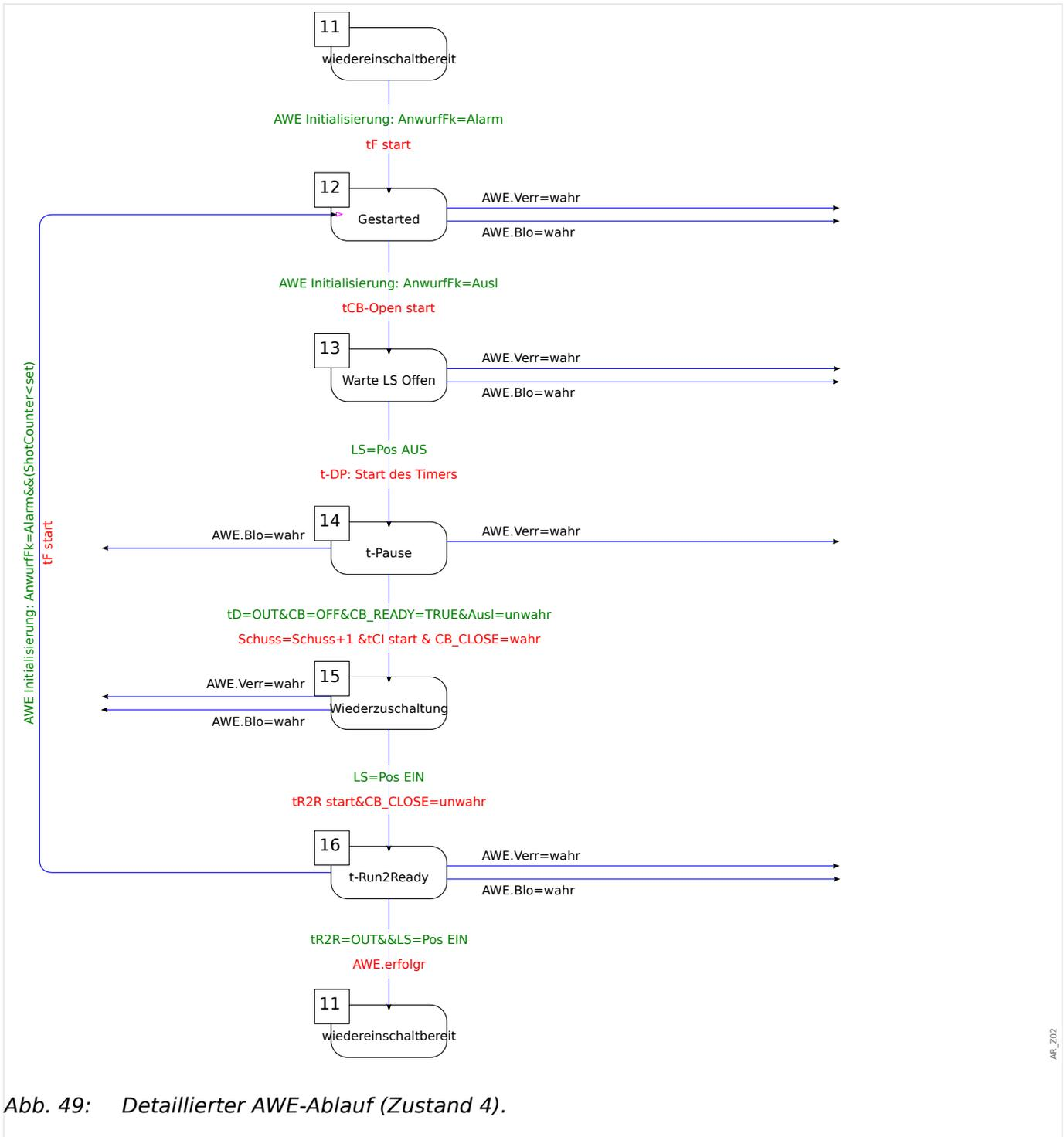
Abb. 49: Detaillierter AWE-Ablauf (Zustand 4).
