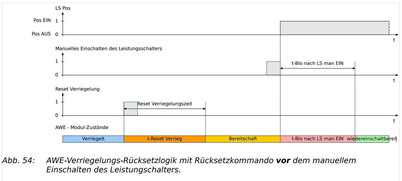
Abb. 54: AWE-Verriegelungs-Rücksetzlogik mit Rücksetzkommando **vor** dem manuellem Einschalten des Leistungsschalters.
