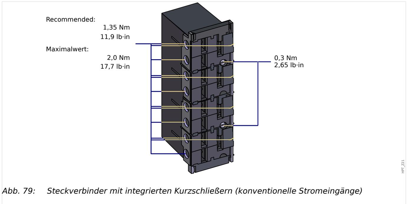
Abb. 79: Steckverbinder mit integrierten Kurzschließern (konventionelle Stromeingänge)
