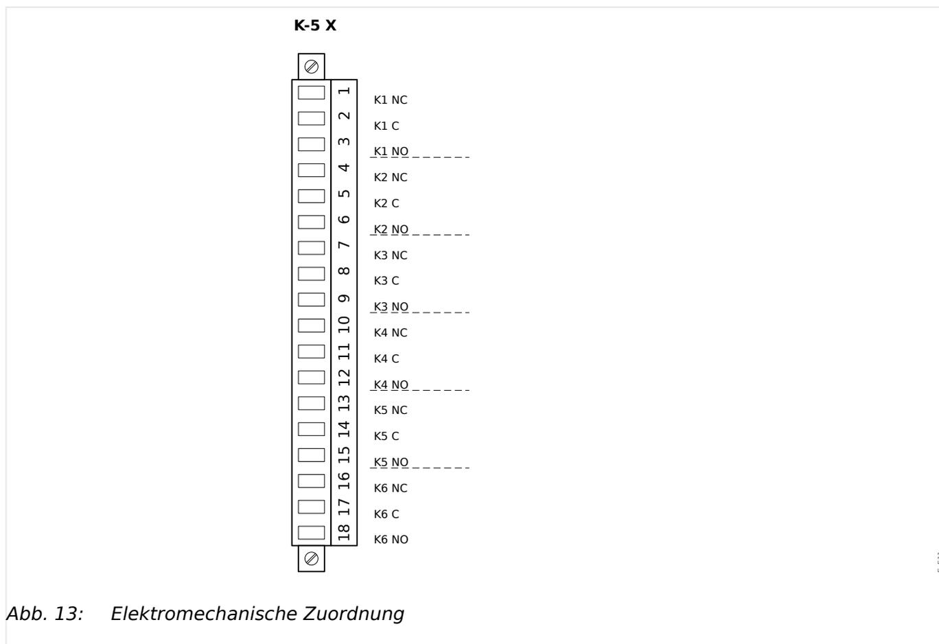
Abb. 13: Elektromechanische Zuordnung
