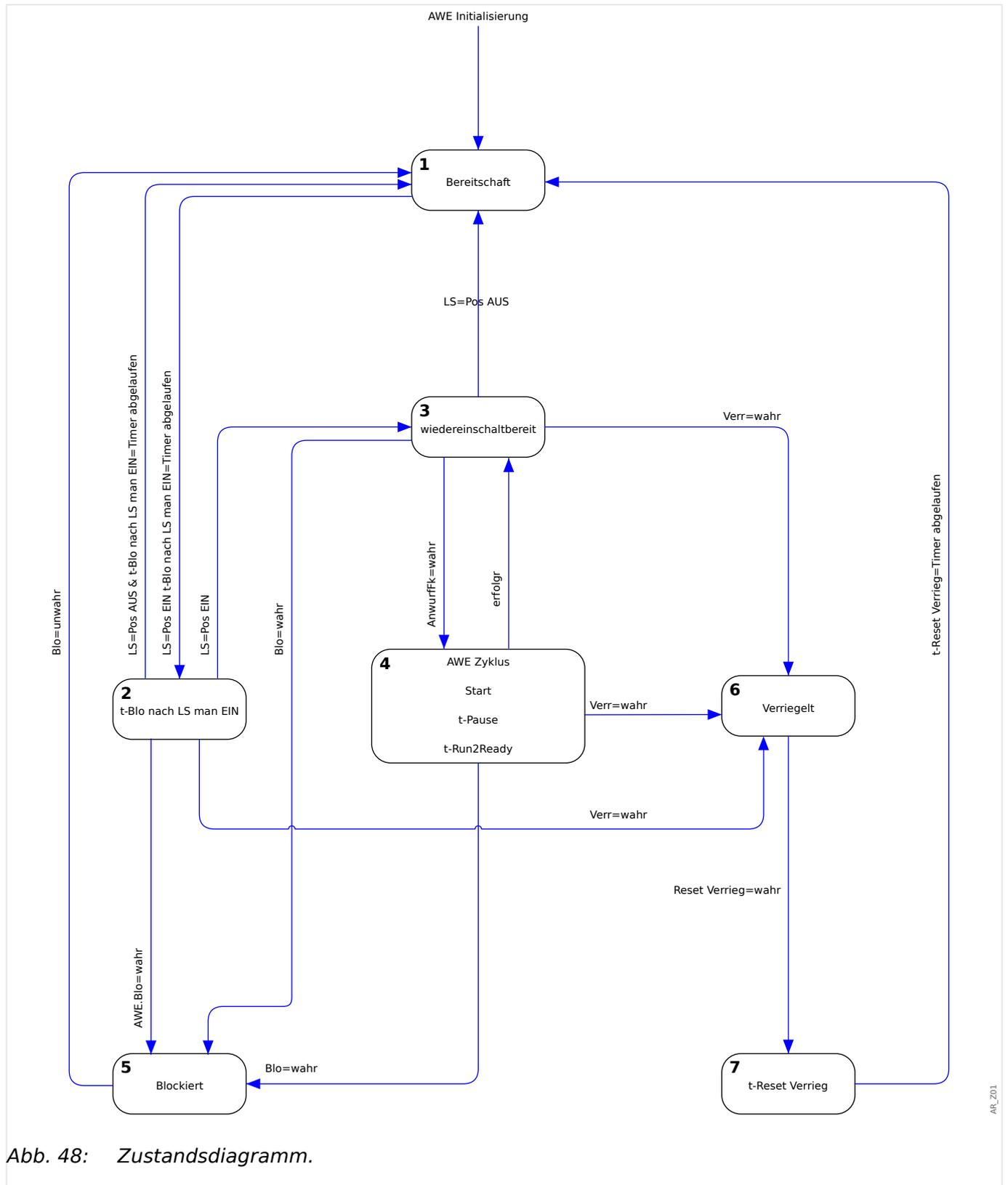
Abb. 48: Zustandsdiagramm.
