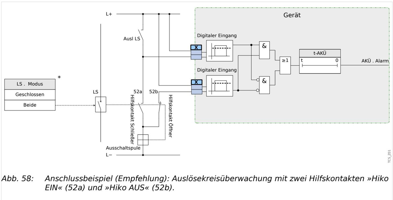
Abb. 58: Anschlussbeispiel (Empfehlung): Auslösekreisüberwachung mit zwei Hilfskontakten »Hiko EIN« (52a) und »Hiko AUS« (52b).
