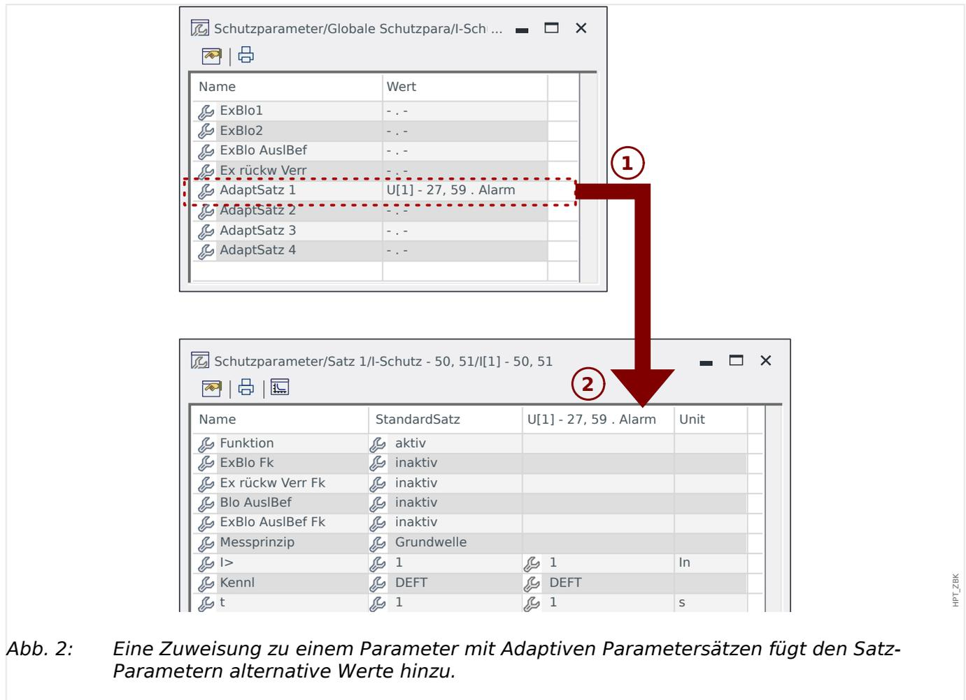
Abb. 2: Eine Zuweisung zu einem Parameter mit Adaptiven Parametersätzen fügt den Satz-Parametern alternative Werte hinzu.
