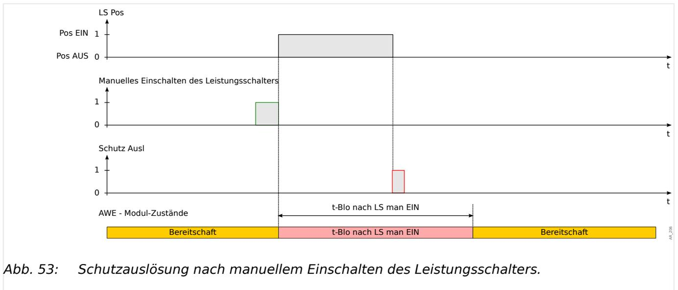
Abb. 53: Schutzauslösung nach manuellem Einschalten des Leistungsschalters.
