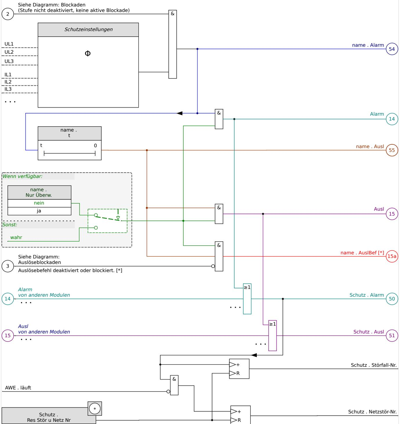
Abb. 43: Grobe Skizze der Funktionalität einer HighPROTEC-Schutzfunktion.
