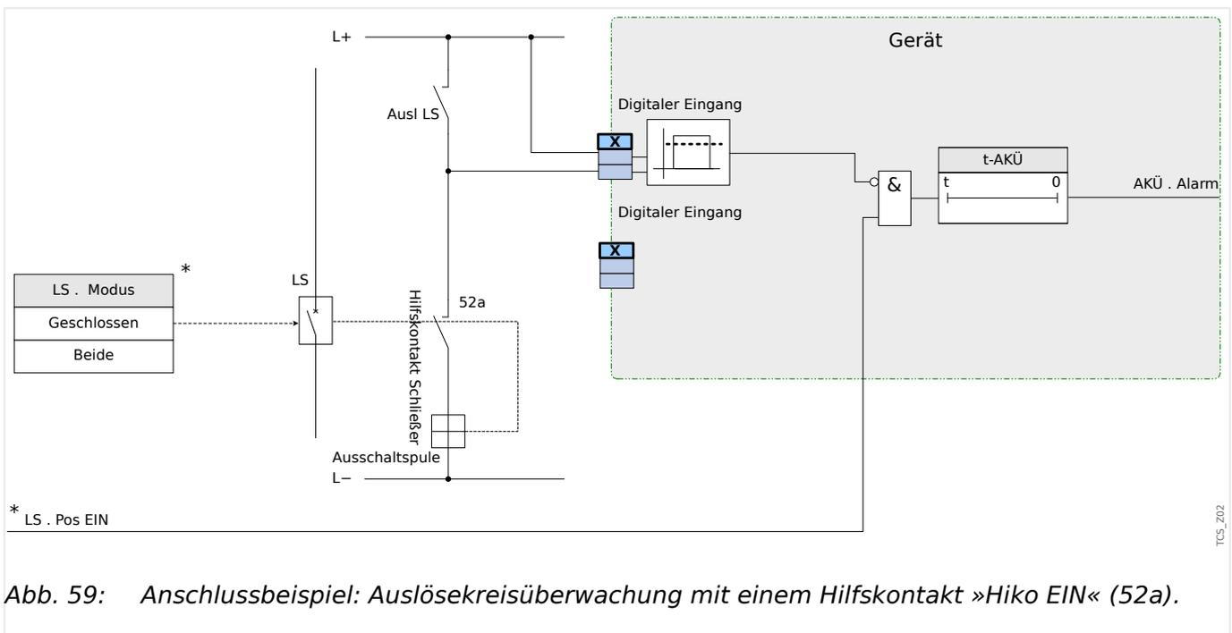
Abb. 59: Anschlussbeispiel: Auslösekreisüberwachung mit einem Hilfskontakt »Hiko EIN« (52a).
