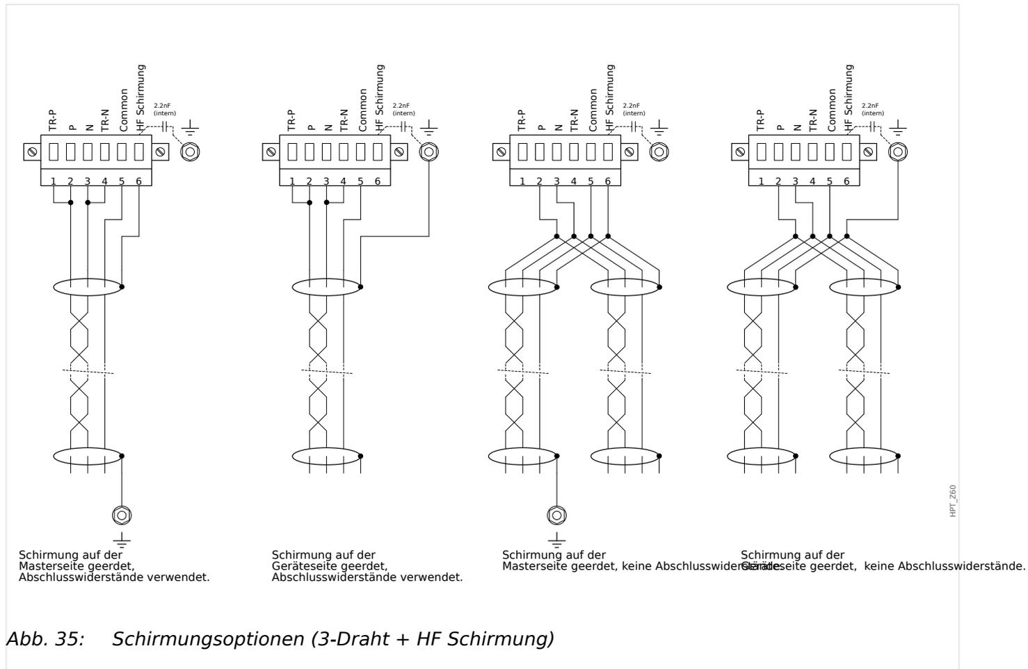
Abb. 35: Schirmungsoptionen (3-Draht + HF Schirmung)
