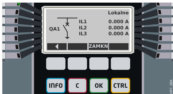
Rys. 63: Przykład strony sterowania z wyłącznikiem w pozycji otwartej.
