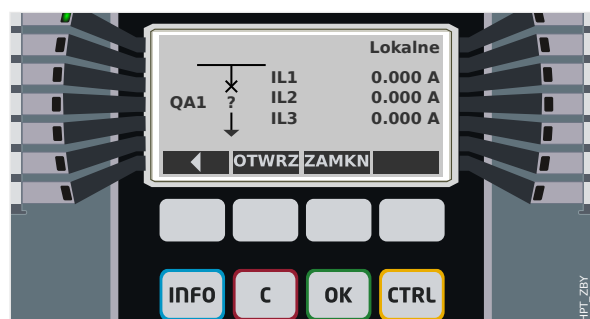
Rys. 62: Przykład strony sterowania z wyłącznikiem w pozycji zakłóconej (lub nieprawidłowej).
