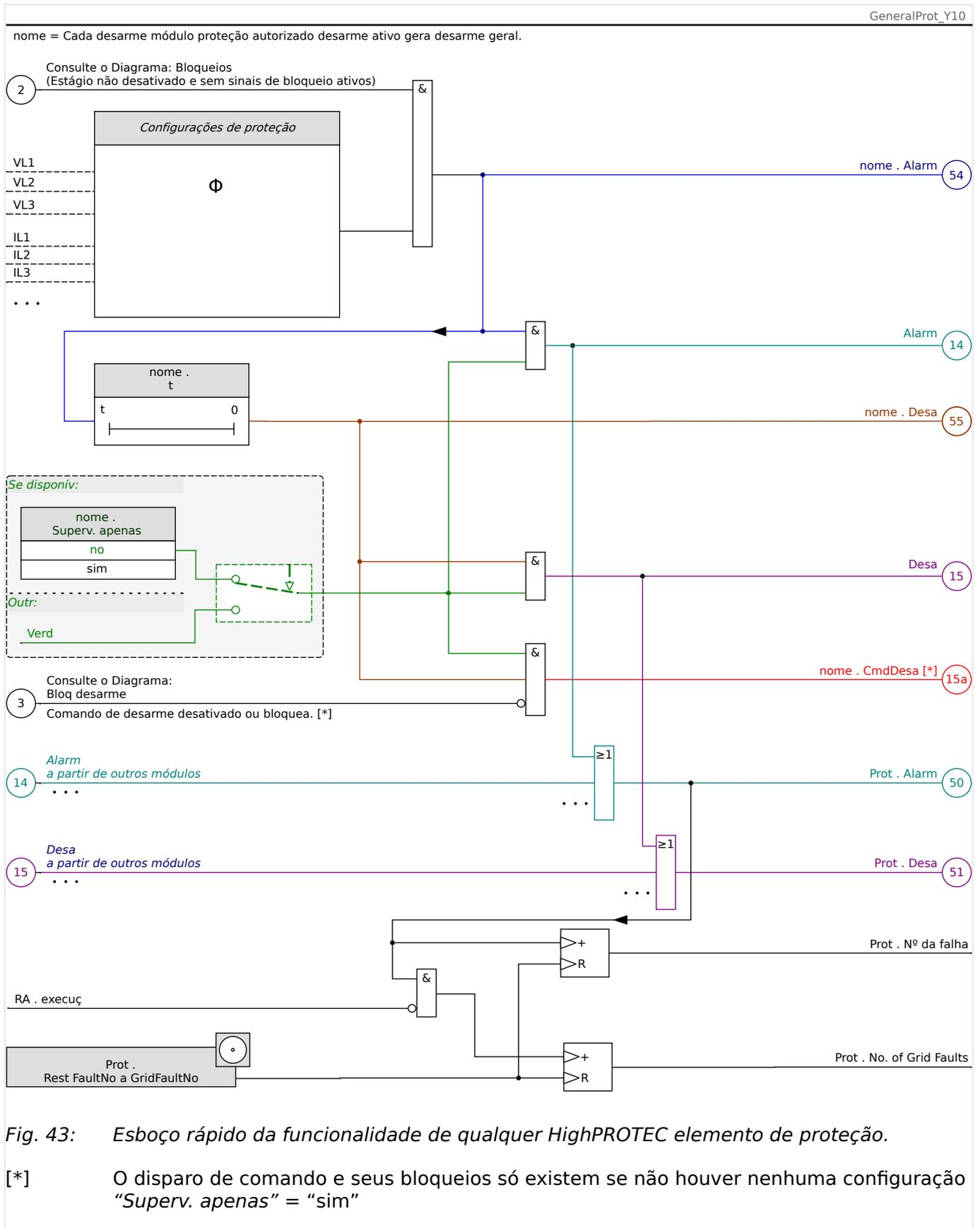
Este diagrama mostra a ideia básica por trás de um elemento de proteção. (No entanto, tenha em mente que são possíveis os desvios específicos da proteção ou do dispositivo: Alguns dispositivos não possuem medição de tensão, outros não apresentam a medição de corrente; para alguns elementos de proteção, são necessários outros temporizadores
