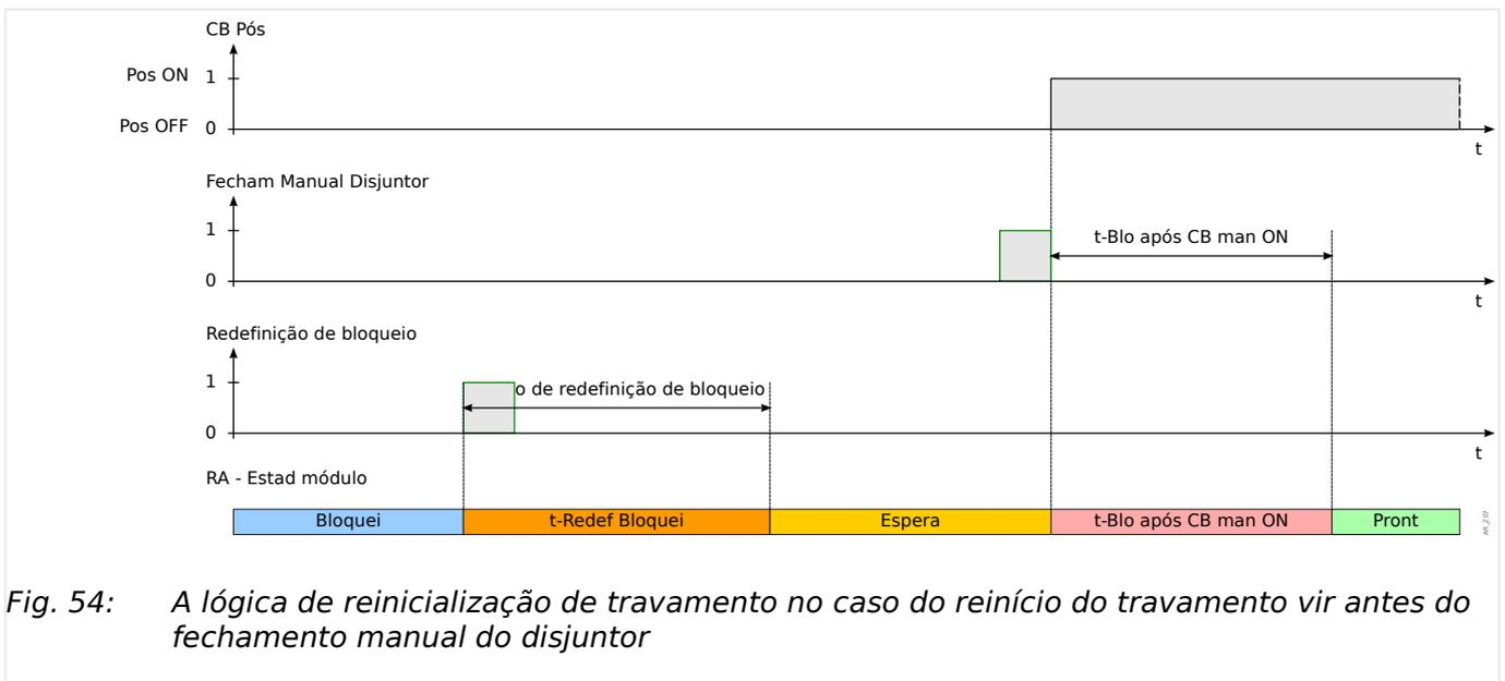
Fig. 54: A lógica de reinicialização de travamento no caso do reinício do travamento vir antes do fechamento manual do disjuntor
