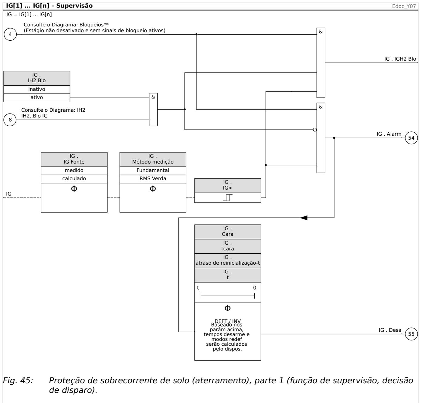
Fig. 45: Proteção de sobrecorrente de solo (aterramento), parte 1 (função de supervisão, decisão de disparo).
