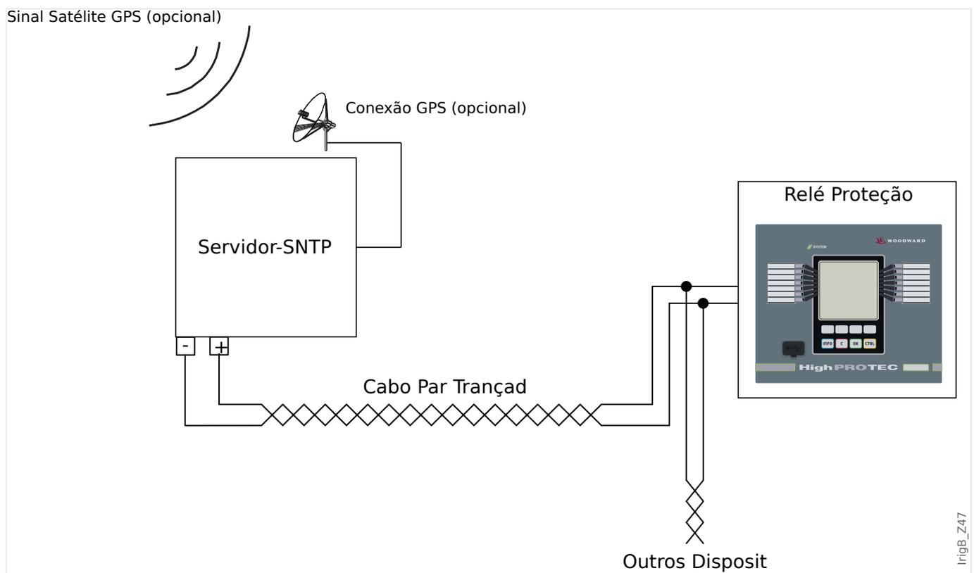
A localização da interface IRIG-B depende do tipo de dispositivo. Por favor, consulte o diagrama de cabeamento oferecido com o dispositivo de proteção.
