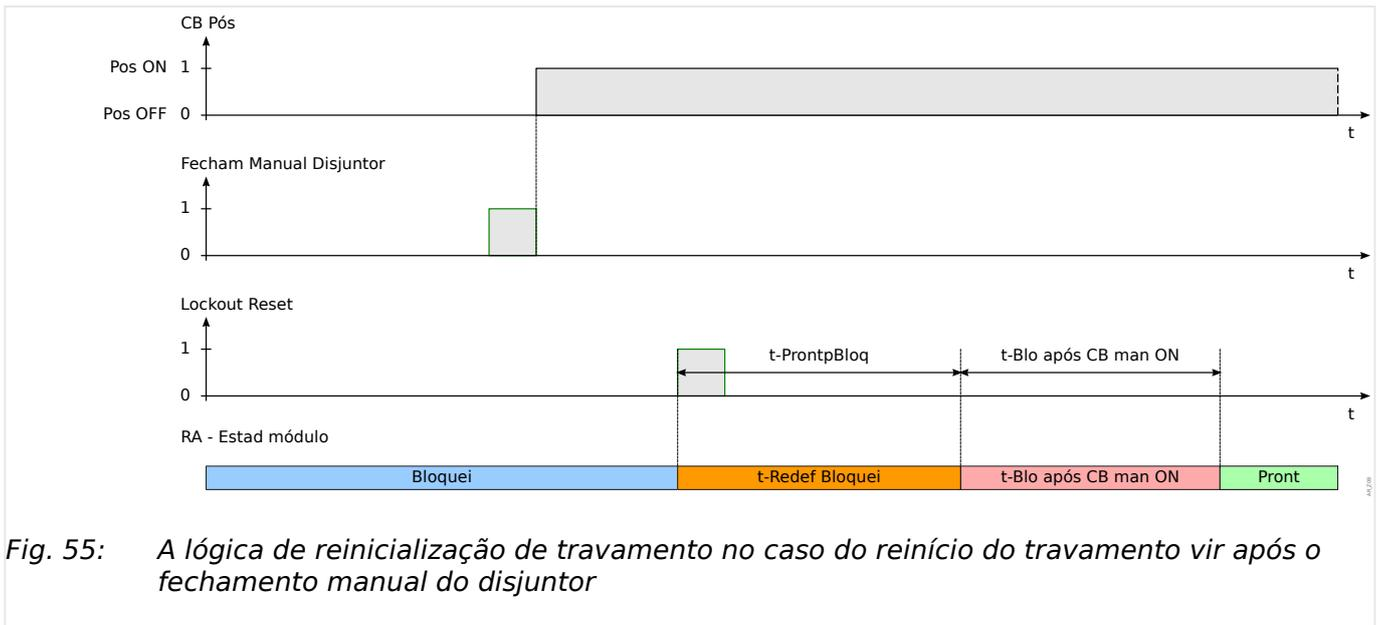
Fig. 55: A lógica de reinicialização de travamento no caso do reinício do travamento vir após o fechamento manual do disjuntor
