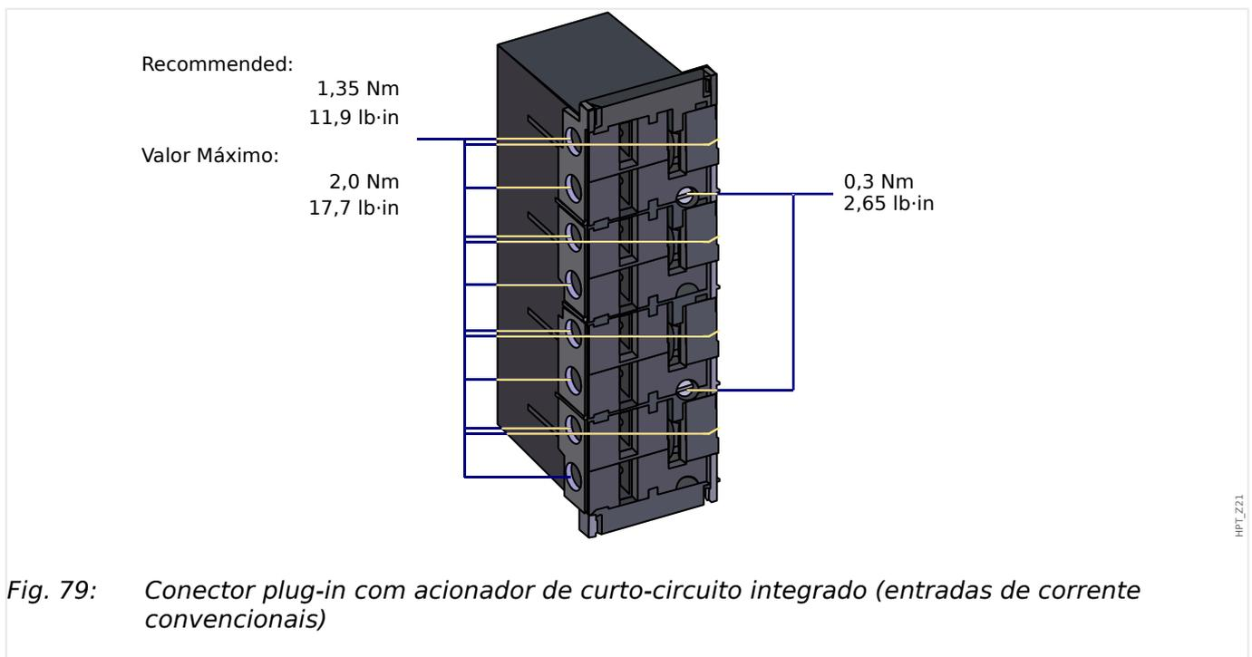
Fig. 79: Conector plug-in com acionador de curto-circuito integrado (entradas de corrente convencionais)
