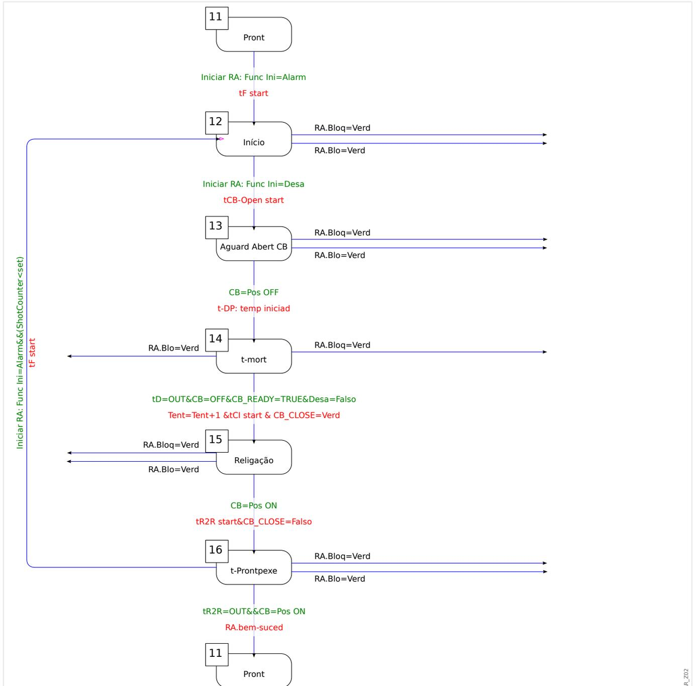
Fig. 49: Ciclo de execução de RA (estado 4).
