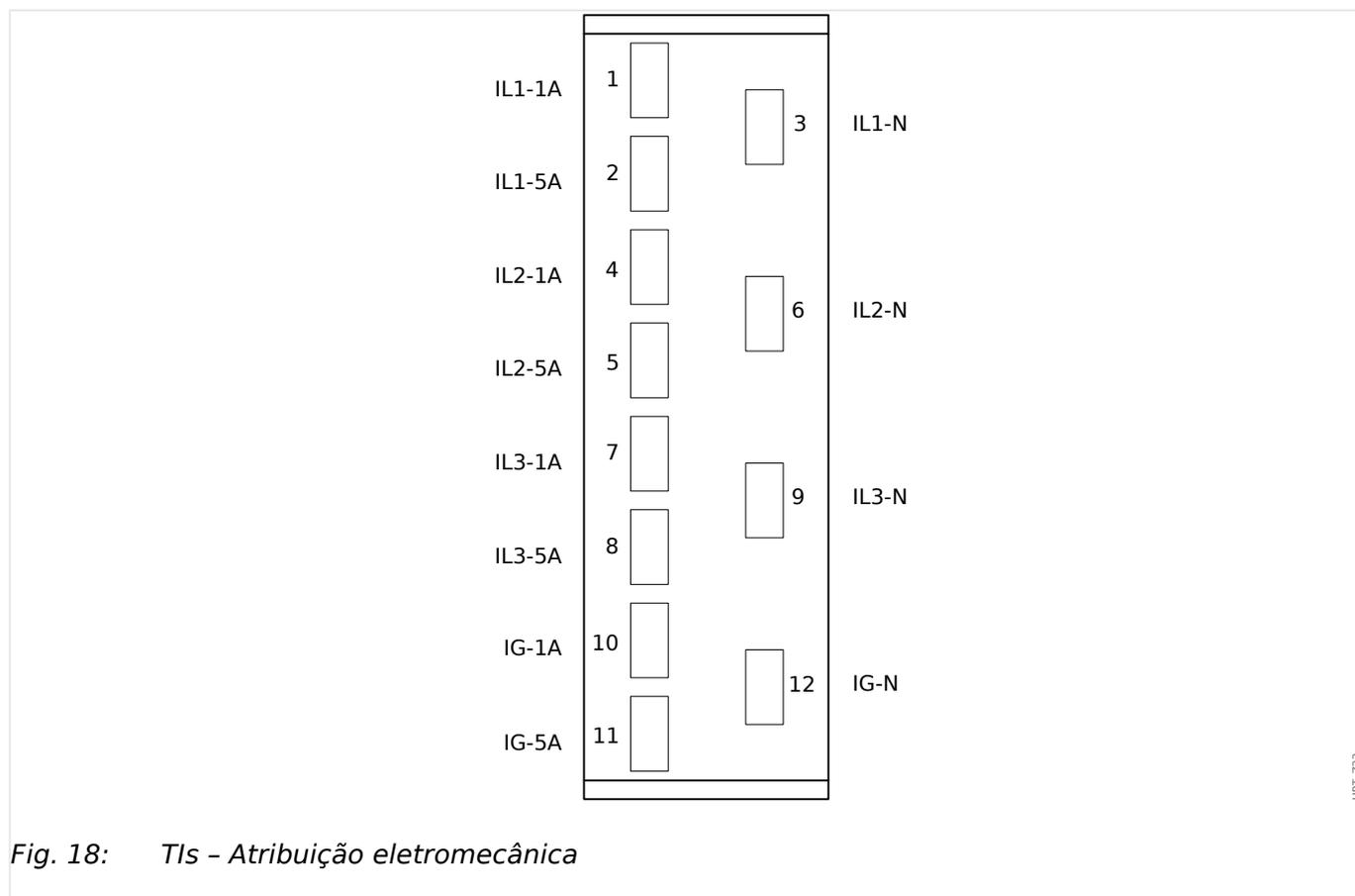
Fig. 18: TIs - Atribuição eletromecânica
