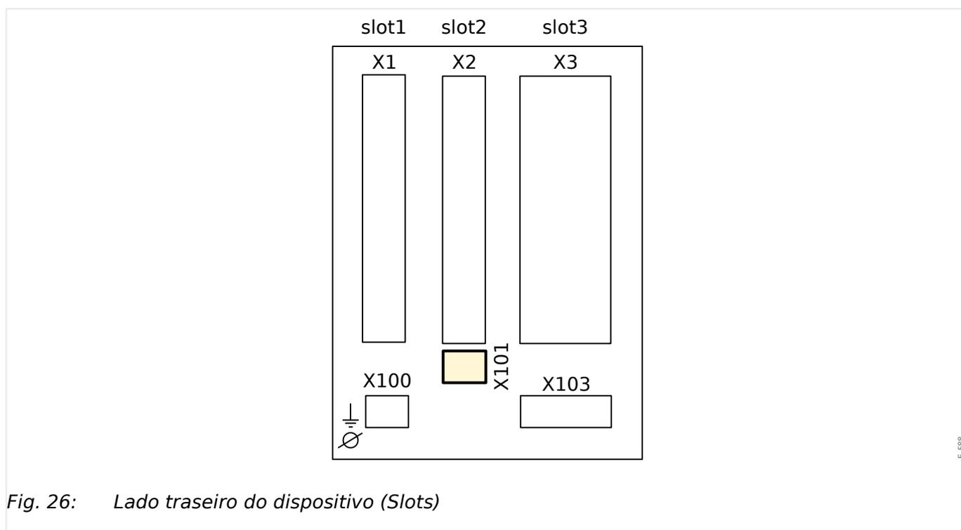
Dependendo do **tipo de dispositivo solicitado** este slot pode ser equipado com uma interface IRIG-B.
