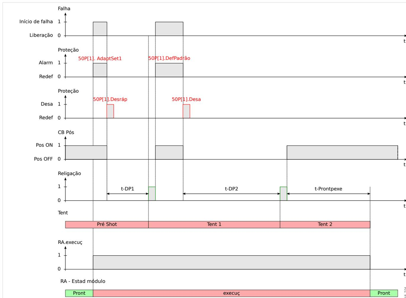
Fig. 51: Diagrama de temporização de religamento automático para esquema de religamento de 2 tentativas **bem-sucedidas** com aceleração na pré tentativa
