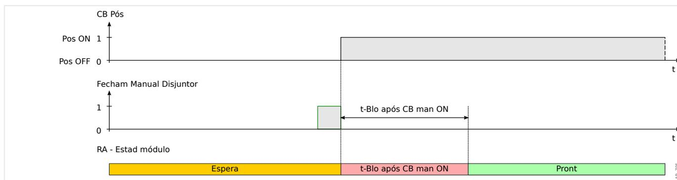
Fig. 52: Estados de religamento automático durante fechamento manual do disjuntor
