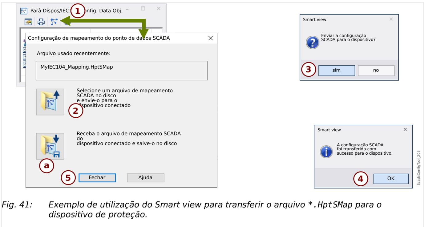
Fig. 41: Exemplo de utilização do Smart view para transferir o arquivo \*.HptSMap para o dispositivo de proteção.
