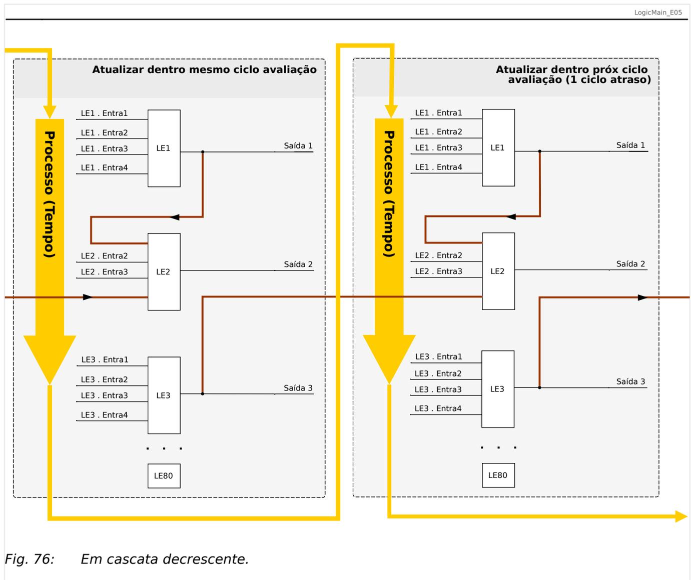
No exemplo mostrado em Fig. 76 acima, a “Equação Lógica 2” usa os estados de saída de duas outras equações, “Equação Lógica 1” e “Equação Lógica 3”. O resultado da “Equação Lógica 1” é usado em ordem ascendente e, portanto, foi avaliado dentro do mesmo ciclo do processo. O resultado da “Equação Lógica 3” é usado em ordem decrescente e, portanto, foi avaliado dentro do ciclo de processo anterior.
