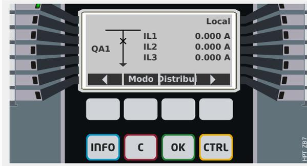
A nova posição do dispositivo comutador é mostrada na tela (assim que é alcançada de acordo com o feedback da indicação de posição, ou após o tempo de troca configurado ter passado).
