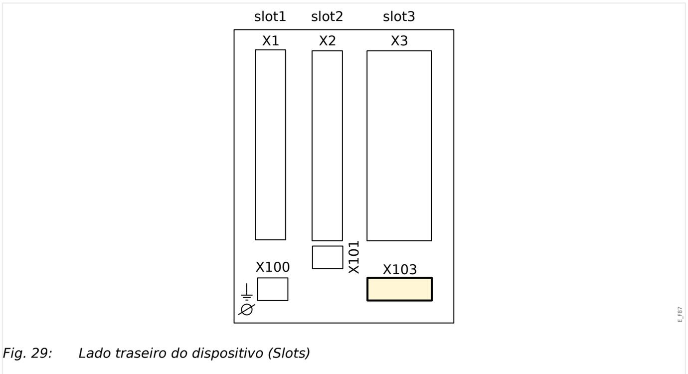
Fig. 29: Lado traseiro do dispositivo (Slots)
