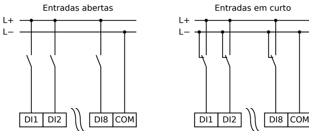
Fig. 80: Estado seguro das entradas digitais
