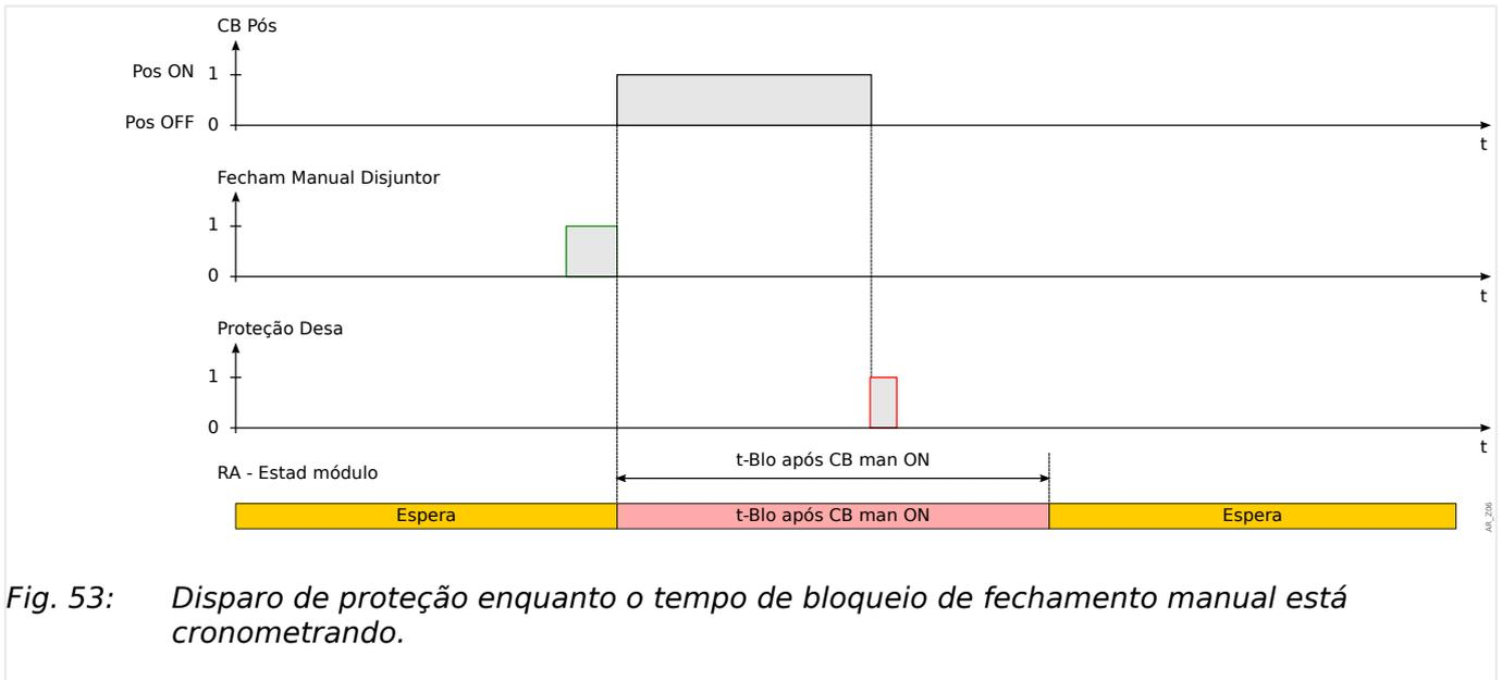
Fig. 53: Disparo de proteção enquanto o tempo de bloqueio de fechamento manual está cronometrando.
