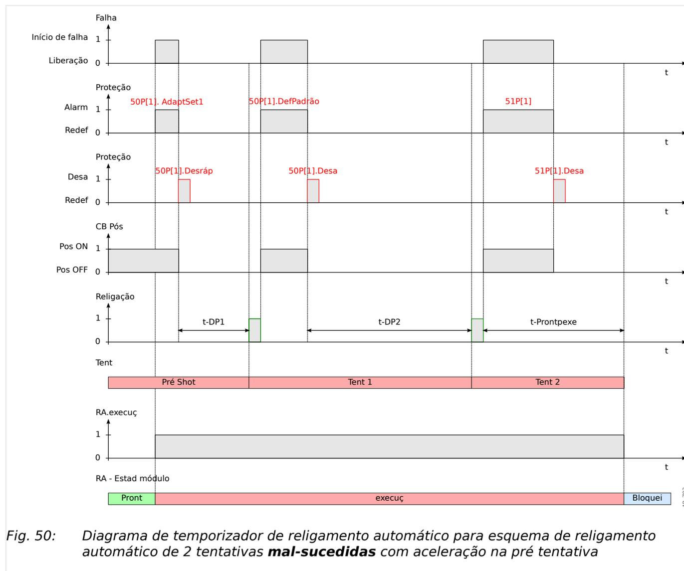
Fig. 50: Diagrama de temporizador de religamento automático para esquema de religamento automático de 2 tentativas **mal-sucedidas** com aceleração na pré tentativa
