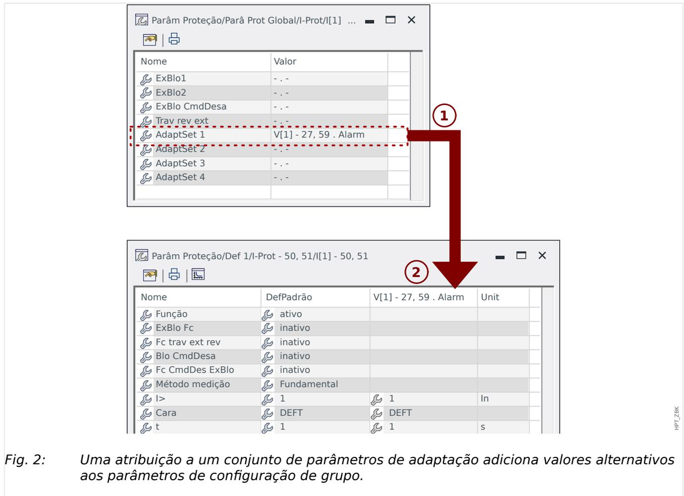
Fig. 2: Uma atribuição a um conjunto de parâmetros de adaptação adiciona valores alternativos aos parâmetros de configuração de grupo.
