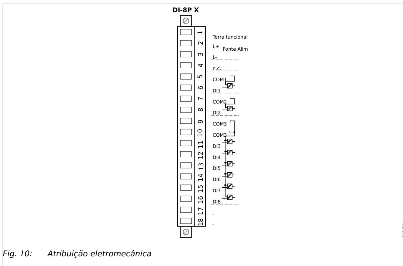
Fig. 10: Atribuição eletromecânica
