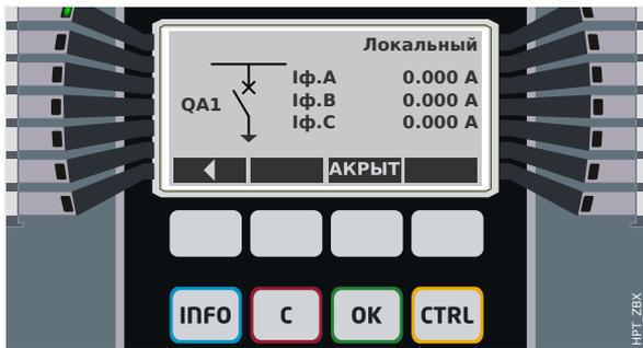
Рис. 71: Пример страницы управления, выключатель в разомкнутом положении.
