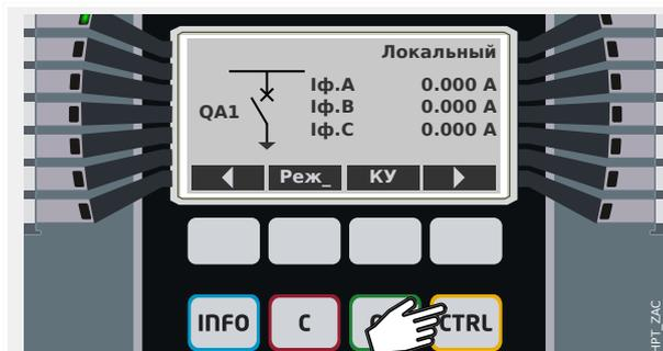
При нажатии клавиши «CTRL» отображается на экран с одной строкой, кроме того, вы получаете прямой доступ к связанным значениям измерения и функциям управления.
