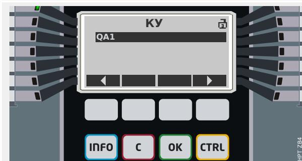
При нажатии программной кнопки «КУ» отображается экран со списком всех подключенных коммутационных устройств.
