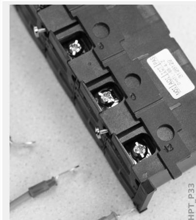
Передвиньте задвижку в сторону, чтобы винты и металлические контакты стали полностью доступными.
