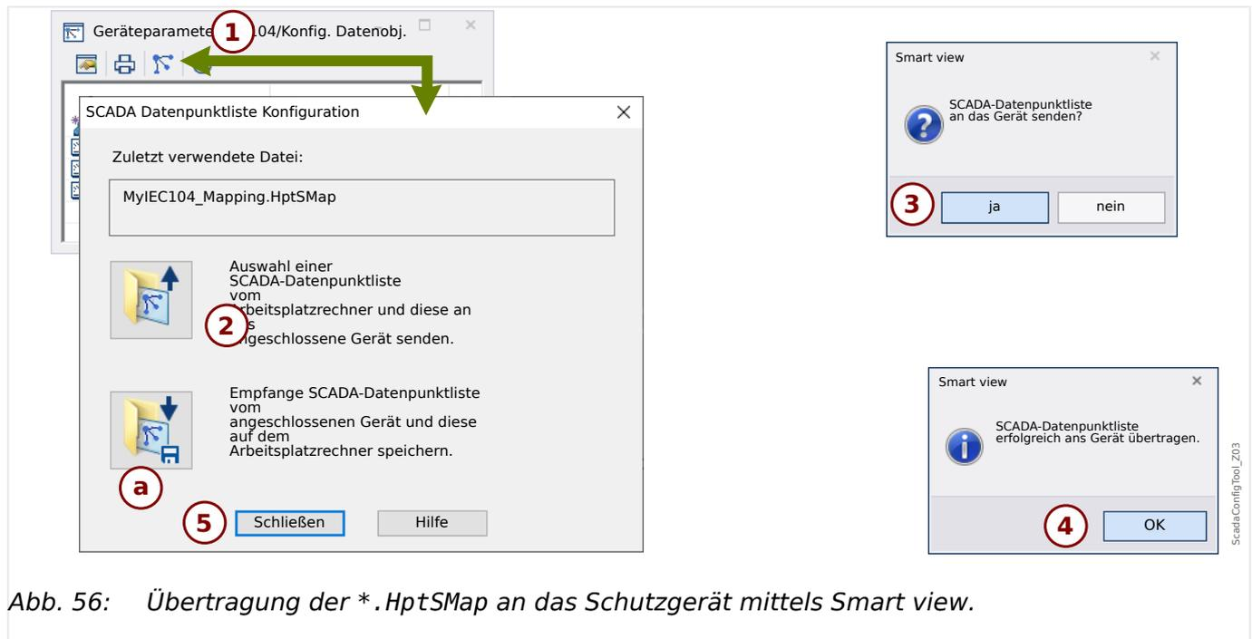
Abb. 56: Übertragung der \*.HptSMap an das Schutzgerät mittels Smart view.
