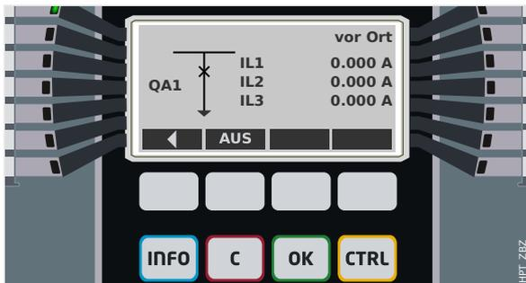
Abb. 91: Beispiel einer Steuer-Seite mit geschlossenem „Leistungsschalter“.
