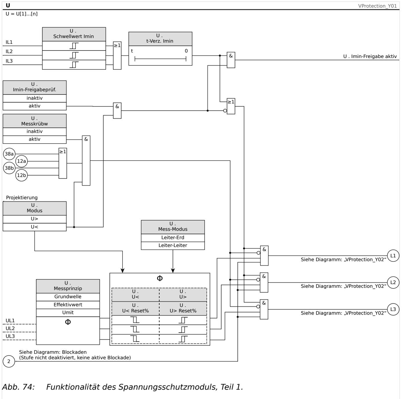
Abb. 74: Funktionalität des Spannungsschutzmoduls, Teil 1.
