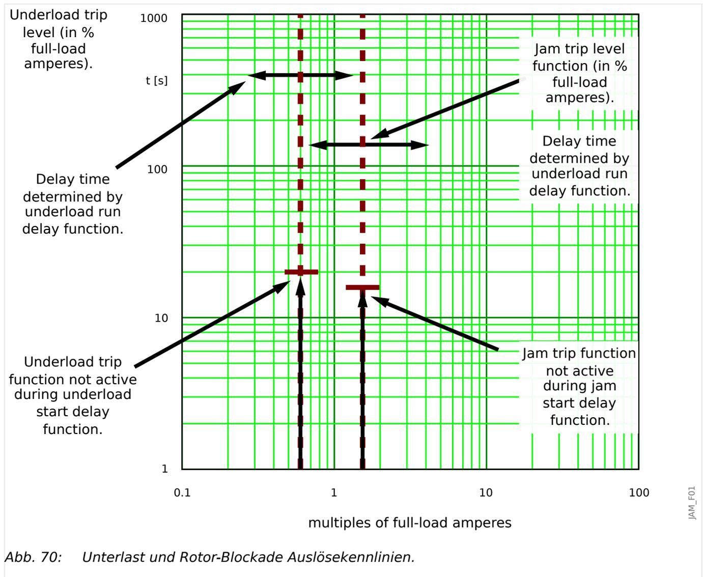
Wenn der Ansprechwert überschritten wird, erfolgt ein Alarm. Nach Ablauf der eingestellten Auslöseverzögerung erfolgt die Auslösung.
