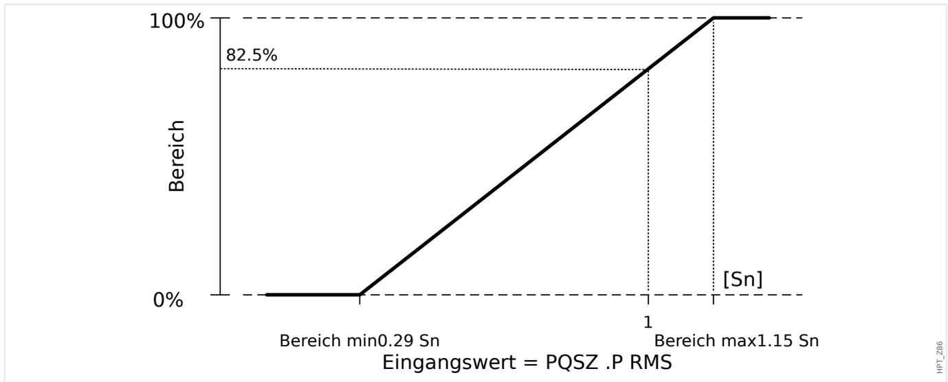
**Konfigurationsbeispiel: Leistungsfaktor über Analogausgang\***
