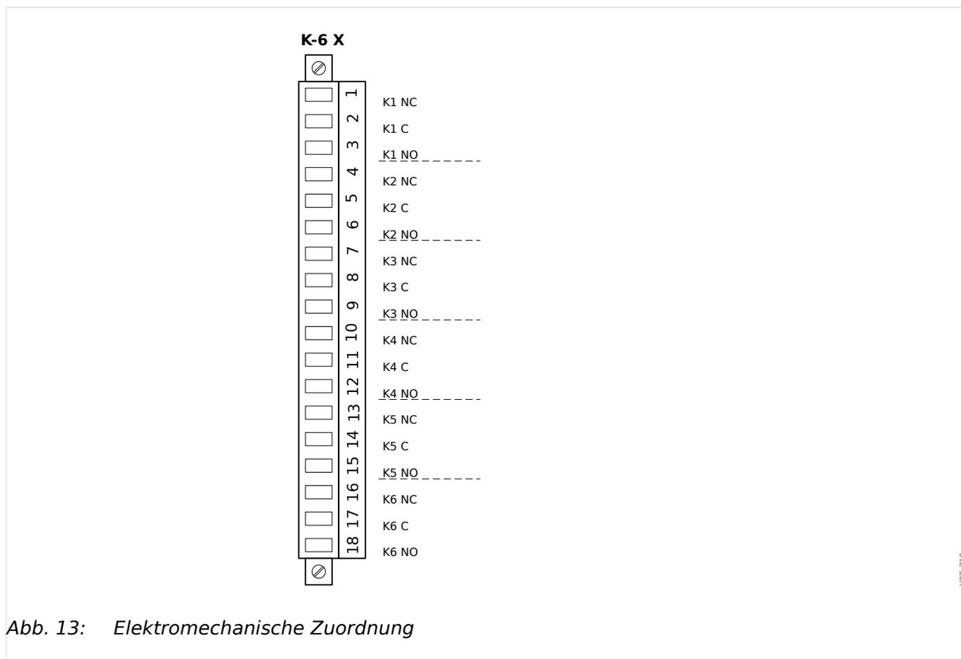
Abb. 13: Elektromechanische Zuordnung
