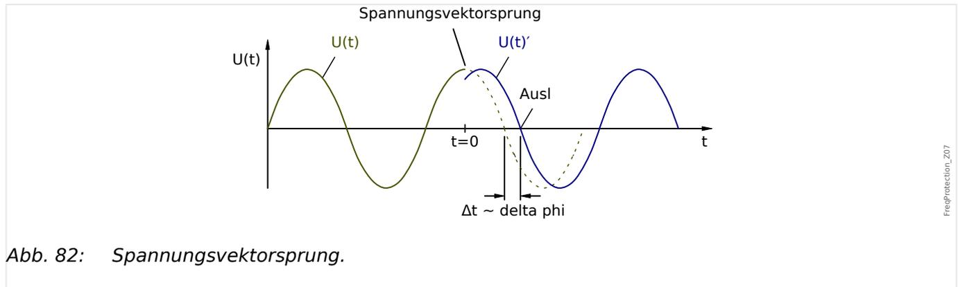
Abb. 82: Spannungsvektorsprung.
