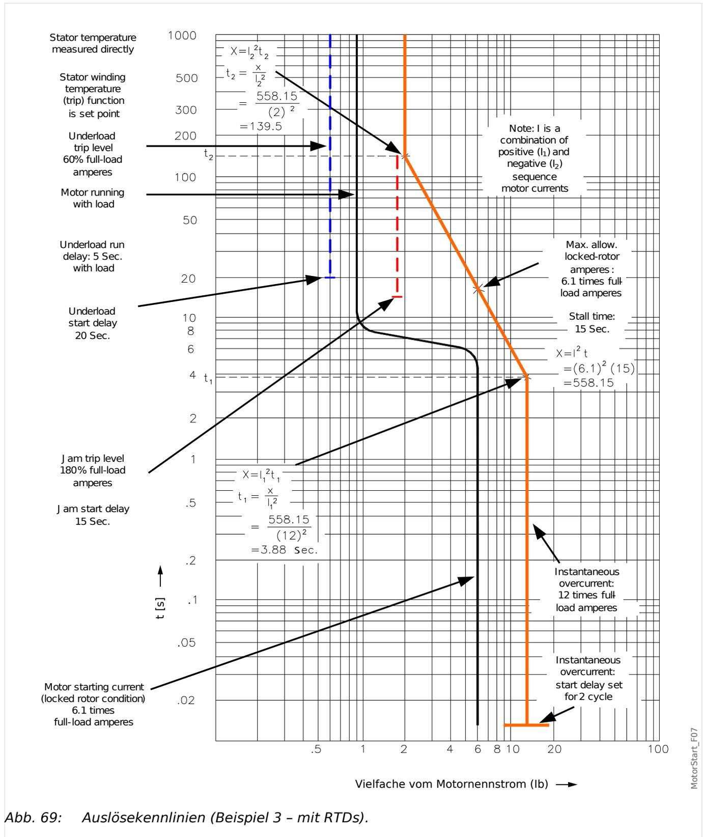
Abb. 69: Auslösekennlinien (Beispiel 3 - mit RTDs).
