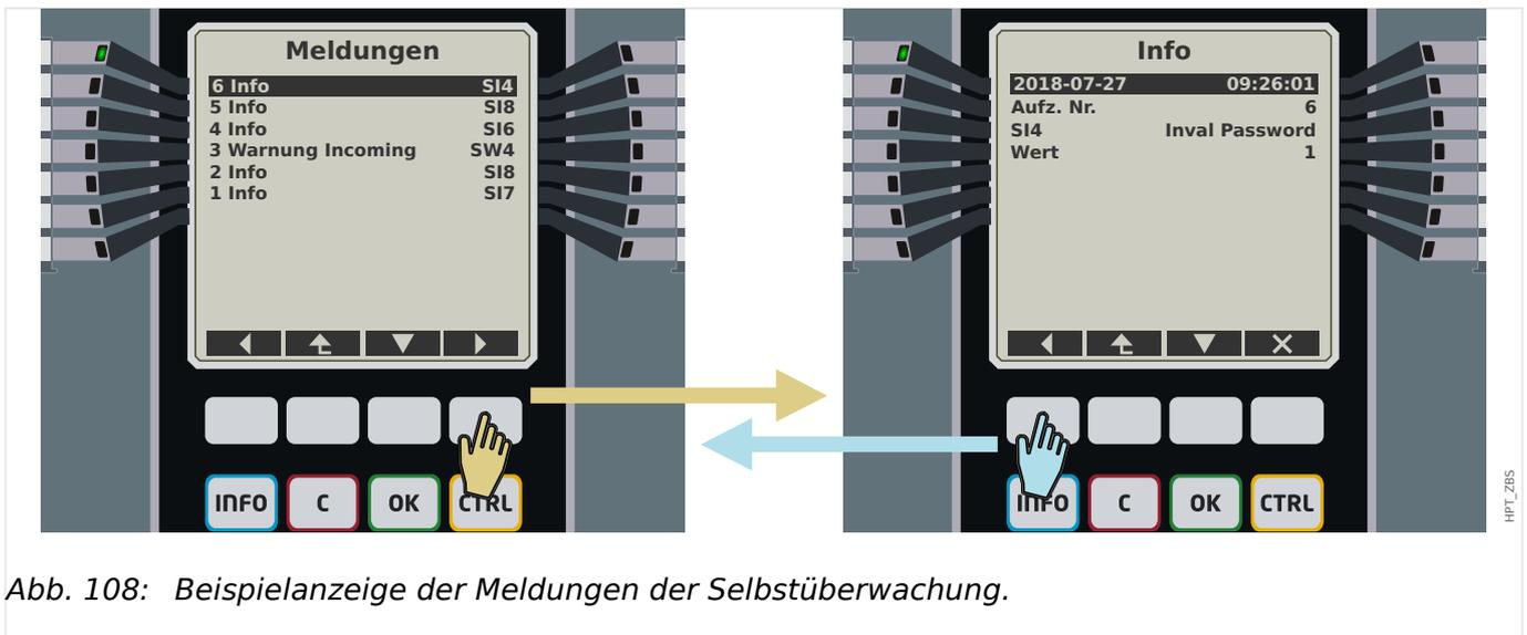
Abb. 108: Beispielanzeige der Meldungen der Selbstüberwachung.
