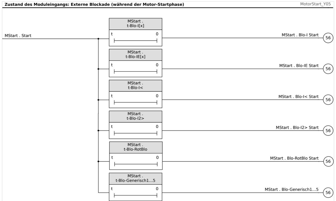
Abb. 60: Temporäre Blockade von Stromschutzfunktionen während Motorstarts.
