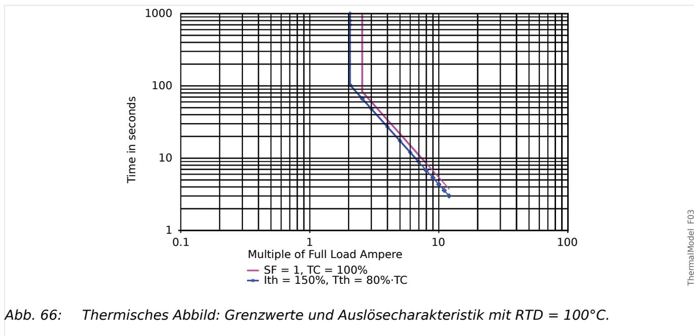
In beiden Diagrammen, mit und ohne Temperaturmessung über RTDs stellen die unmarkierten Linien das thermische Limit dar und die markierten Linien kennzeichnen die Auslösschwellen.
