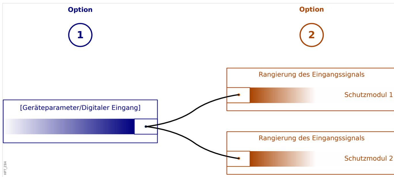
**Option 1** - Einen Digitalen Eingang (einem/mehreren) Modulen zuweisen.
