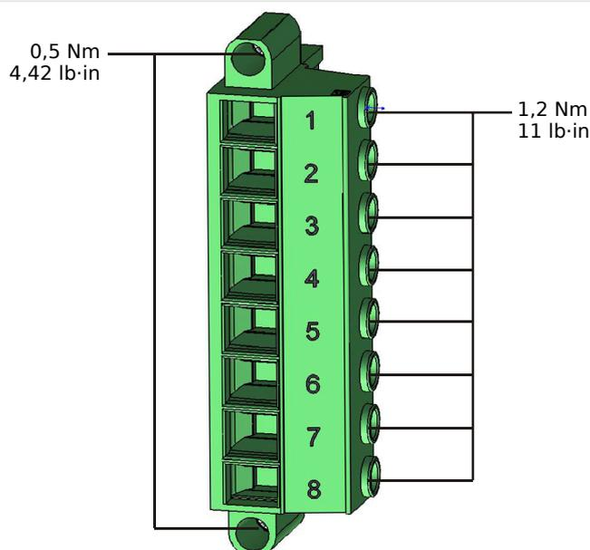
Abb. 110: Spannungsmessstecker der Spannungsmesskarte „TU“ (↳ „2.6.1 TU - Spannungsmesseingänge“).
