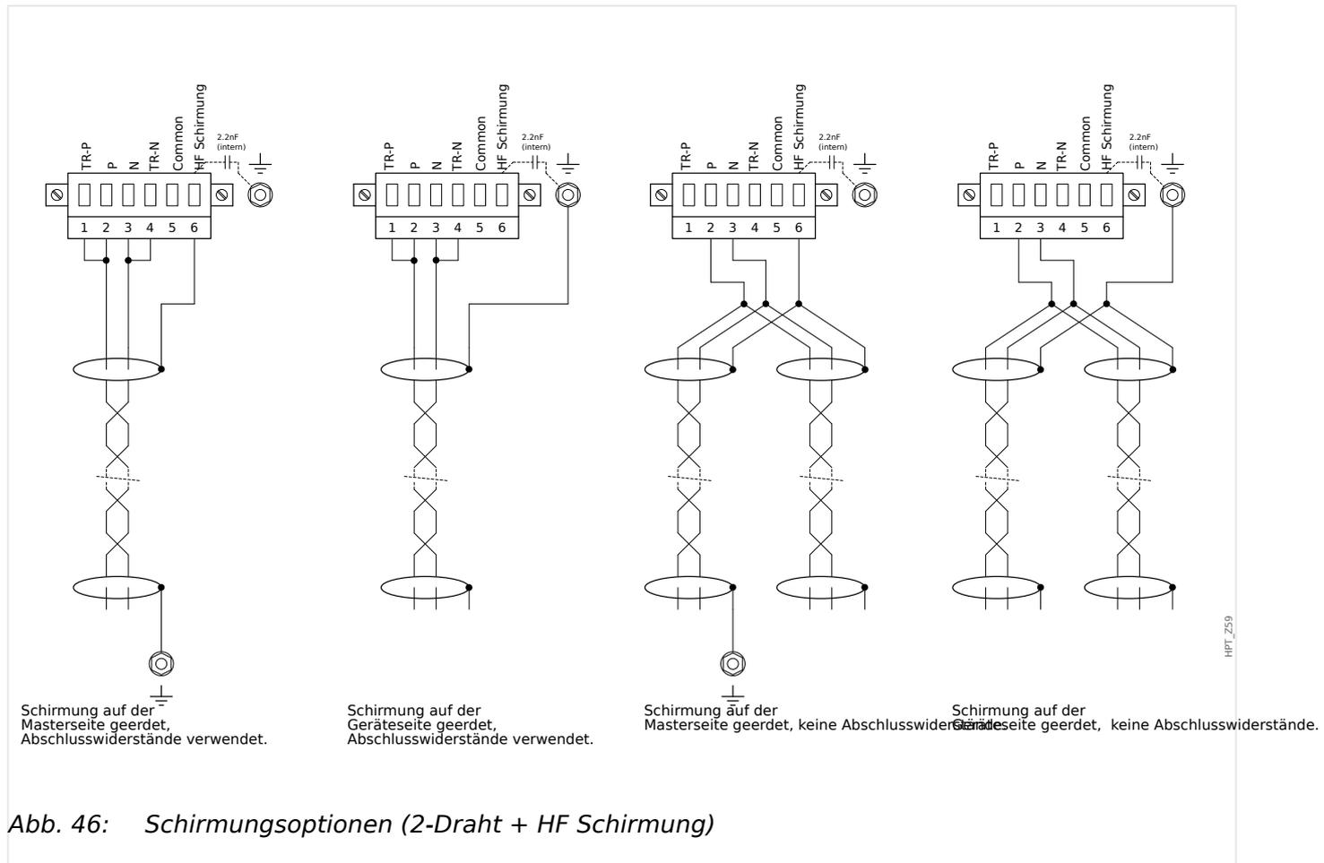
Abb. 46: Schirmungsoptionen (2-Draht + HF Schirmung)
