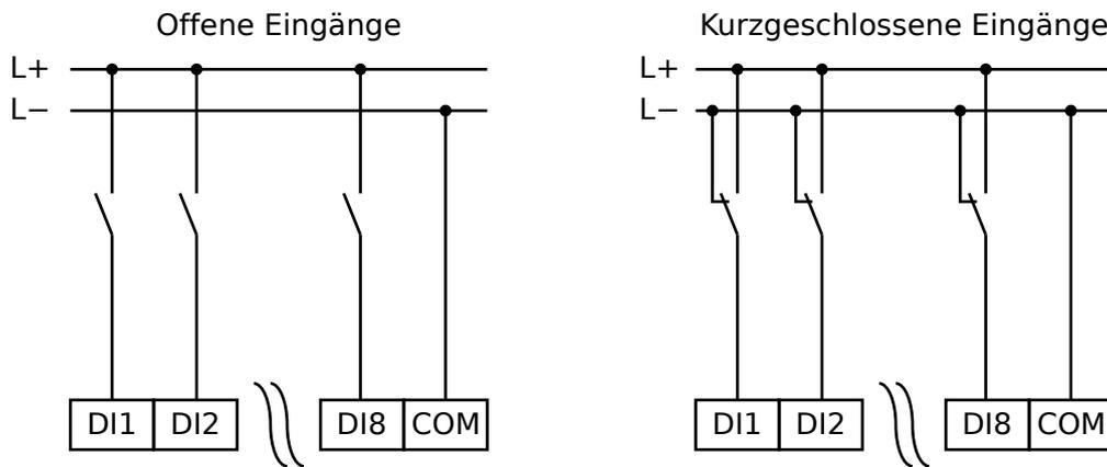
Abb. 111: Sicherer Zustand der digitalen Eingänge
