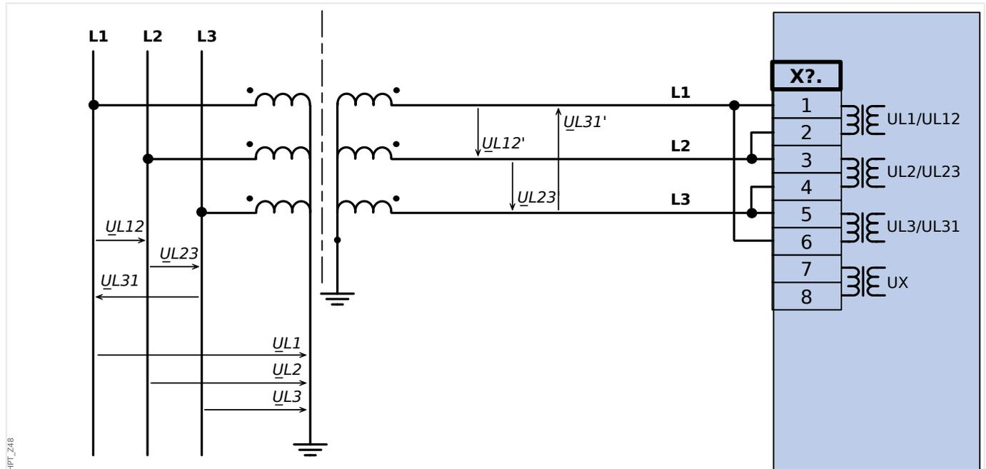
Abb. 30: Drei Spannungswandler mit Geräteanschluss in Dreieckschaltung
