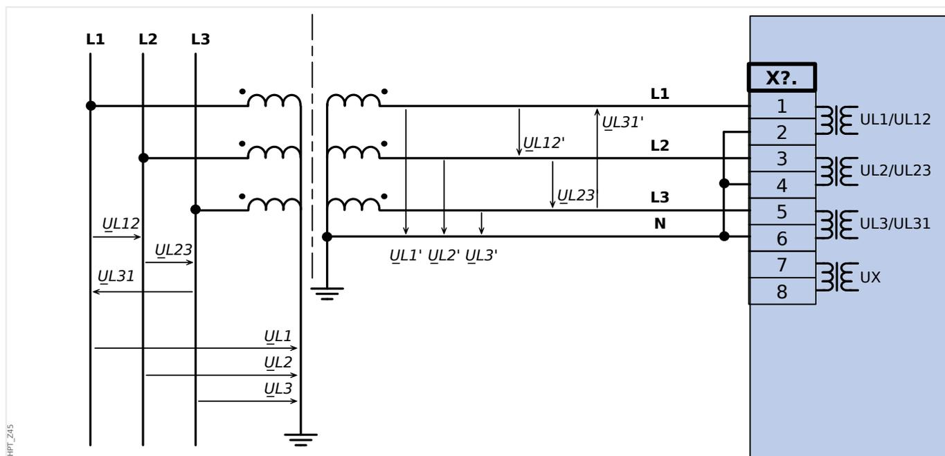
Abb. 28: Drei Spannungswandler mit Geräteanschluss in Sternschaltung
