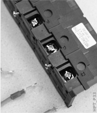
Die Schrauben sind mit einem Plastikschieber abgedeckt, der sich einfach nach hinten wegschieben lässt. Die Verschraubungen liegen nun völlig frei.
