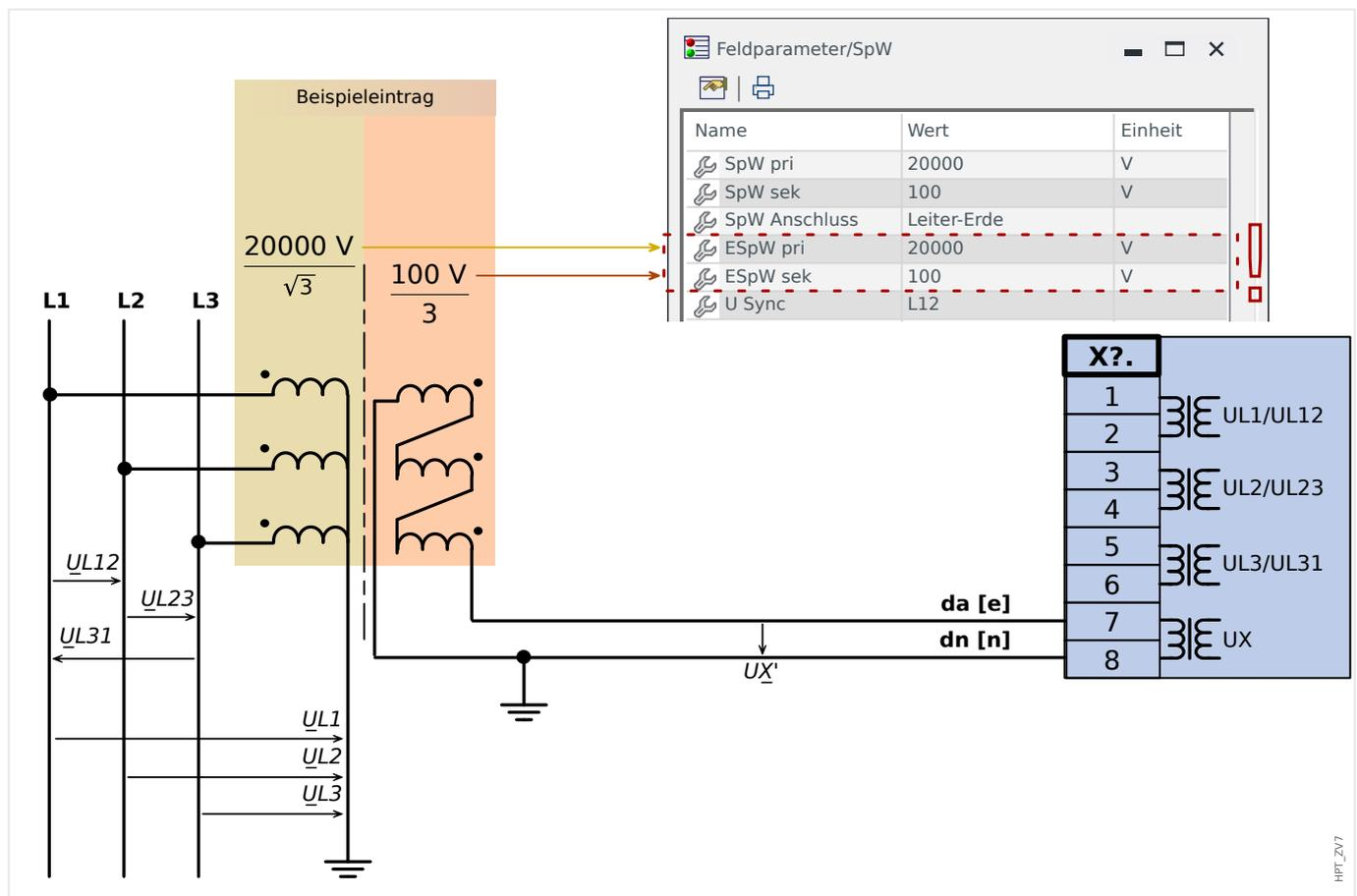
Nach korrektem Anschluss der Spannungsmesseingänge wird die Verlagerungsspannung bei folgender Einstellung gemessen:
