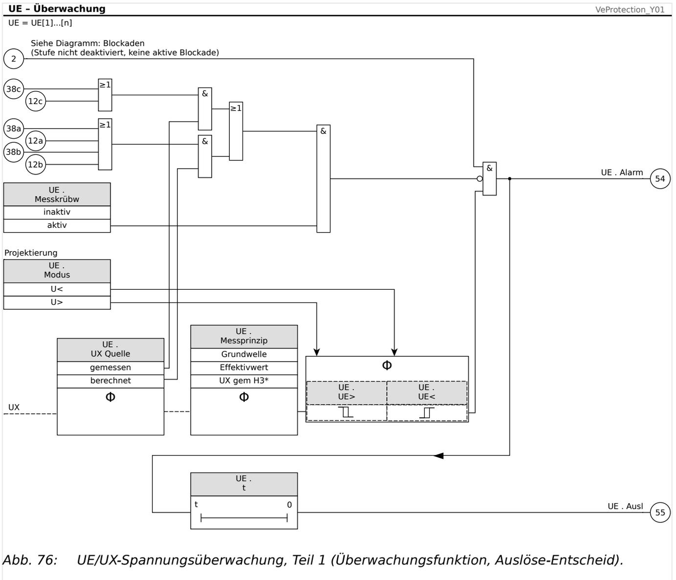
Abb. 76: UE/UX-Spannungsüberwachung, Teil 1 (Überwachungsfunktion, Auslöse-Entscheid).
