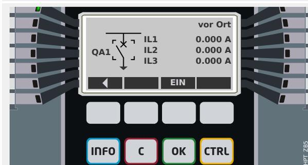
Über den Softkey „►“ (Enter) erreicht man ein erweitertes Abzweigsteuerbild (nachdem das Passwort für den Zugriffsbereich „Strg-Lv1“ eingegeben worden ist); hier ist nun ein Betriebsmittel durch kleine Ecken markiert und dadurch als „ausgewählt“ gekennzeichnet. Falls mehrere Betriebsmittel unterstützt werden, ist außerdem der Softkey „Ausw“ sichtbar, über den (zyklisch durchrotierend) ein anderes Betriebsmittel angewählt werden kann.
