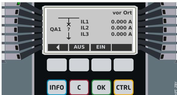
Abb. 92: Beispiel einer Steuer-Seite mit „Leistungsschalter“ in Störstellung (bzw. unplausiblem Zustand).
