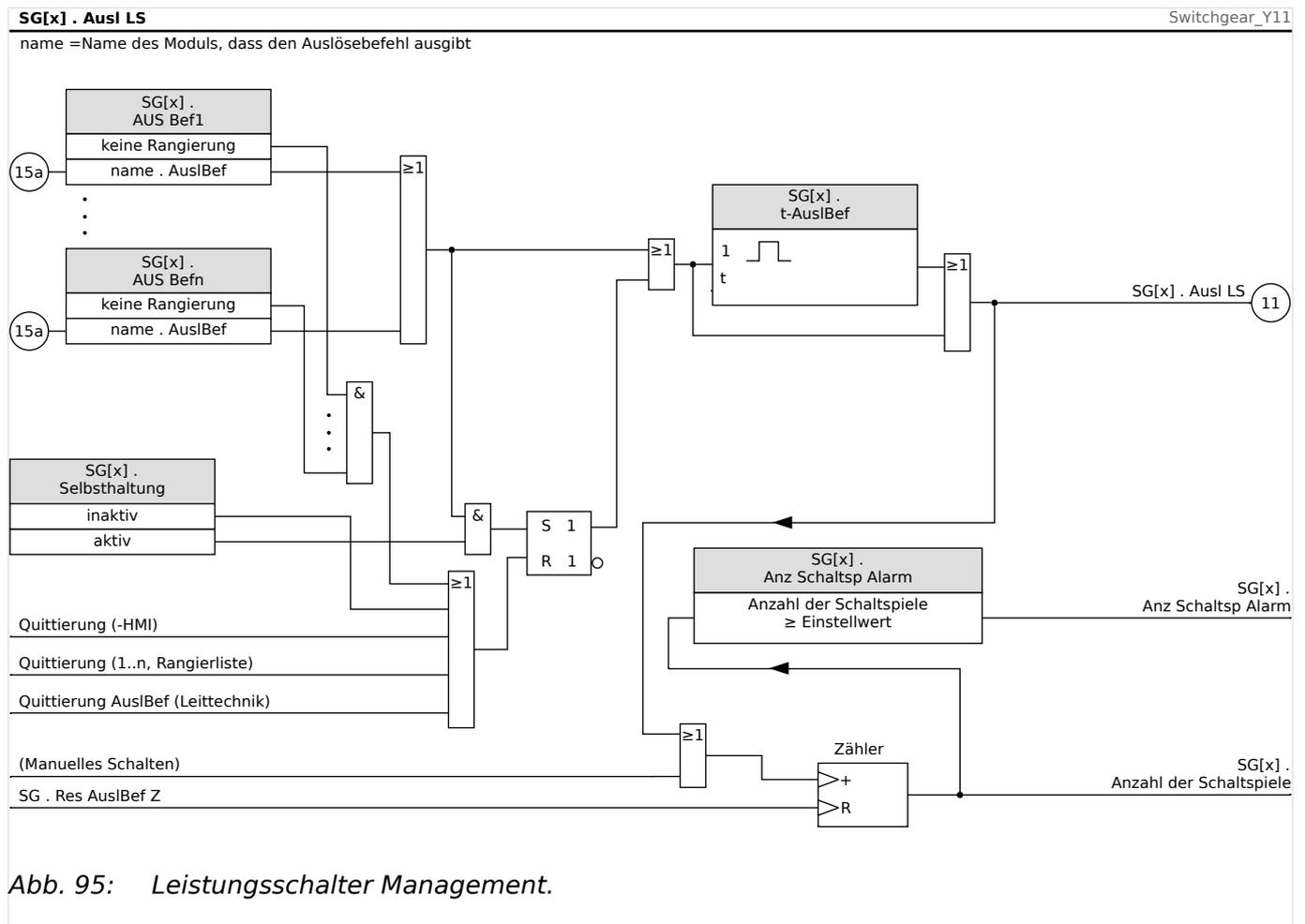
Anmerkung: In diesem Logikdiagramm steht „SG[x]“ für „Schaltgerät Nummer x“; die genaue Schaltgerätebezeichnung wird allerdings über das Abzweigsteuerbild (Single-Line-Diagramm) festgelegt. (Siehe auch
