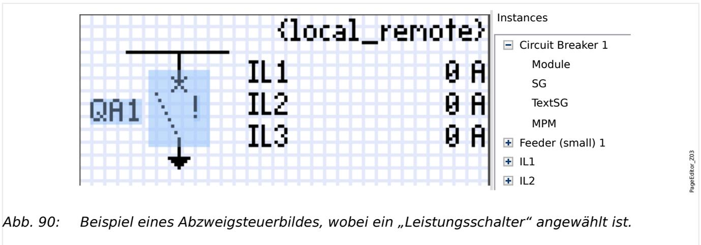
Abb. 90: Beispiel eines Abzweigsteuerbildes, wobei ein „Leistungsschalter“ angewählt ist.
