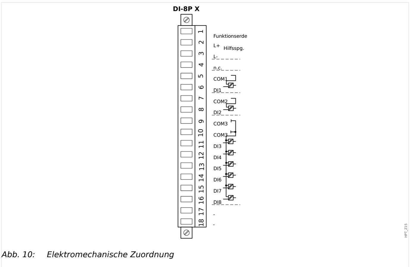
Abb. 10: Elektromechanische Zuordnung
