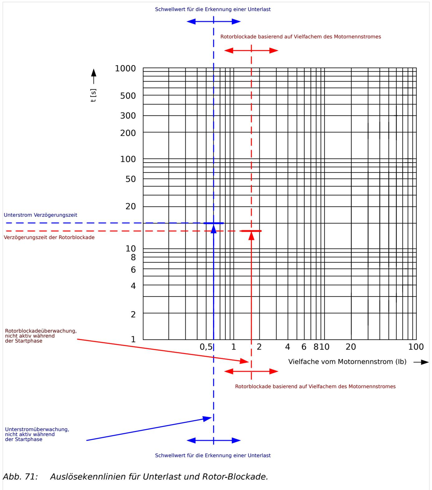
Dies würde durch zwei vertikale Linien dargestellt, welche beide unter dem Motornennstrom » $I_b$ « liegen. Es ist zu beachten, dass der Alarmwert *oberhalb* des Auslösewertes einzustellen ist. Alarm und Auslösung können dann mit einer Ansprechverzögerung versehen werden.
