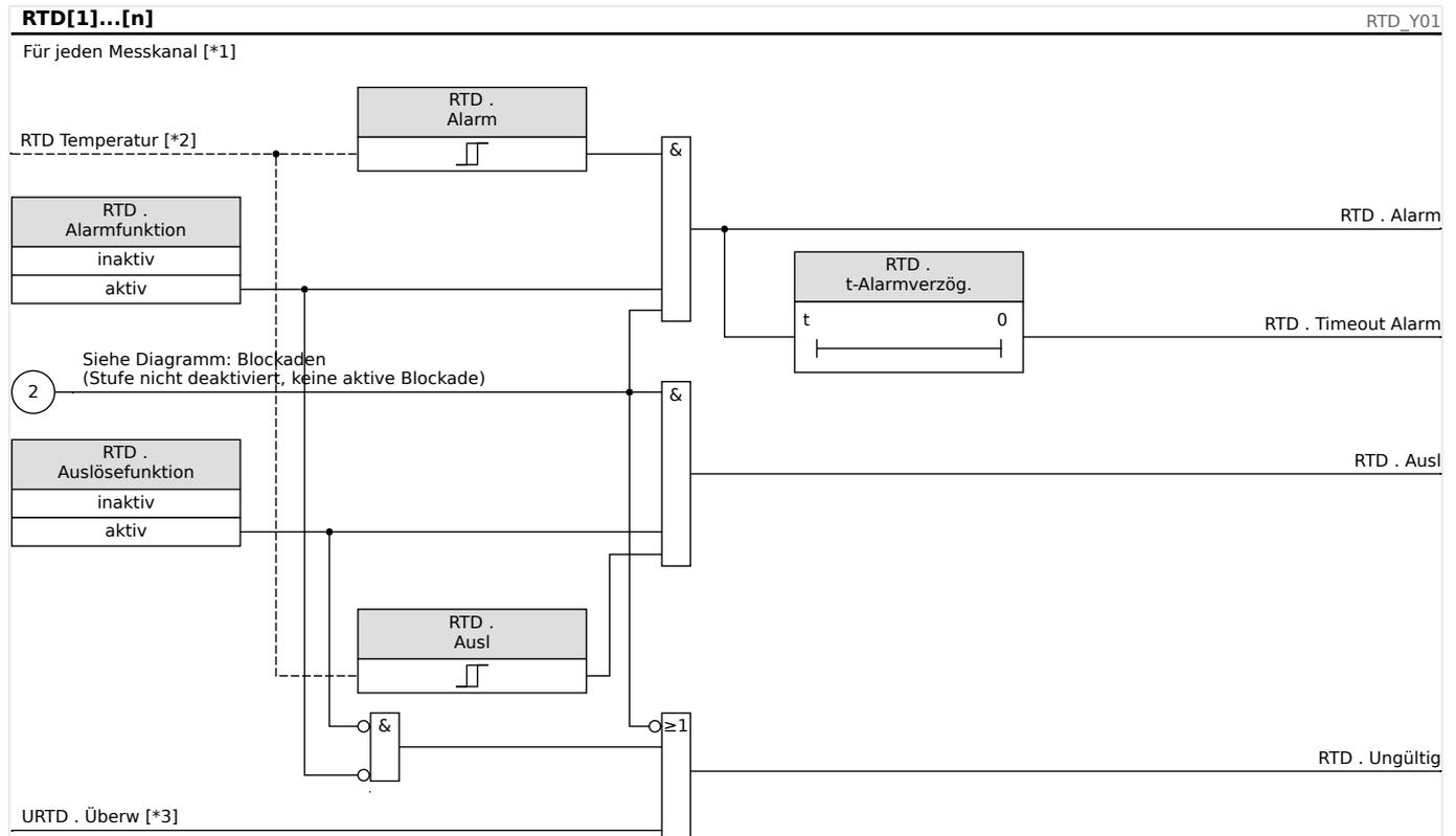
Abb. 86: Generelles RTD-Funktionsprinzip.
