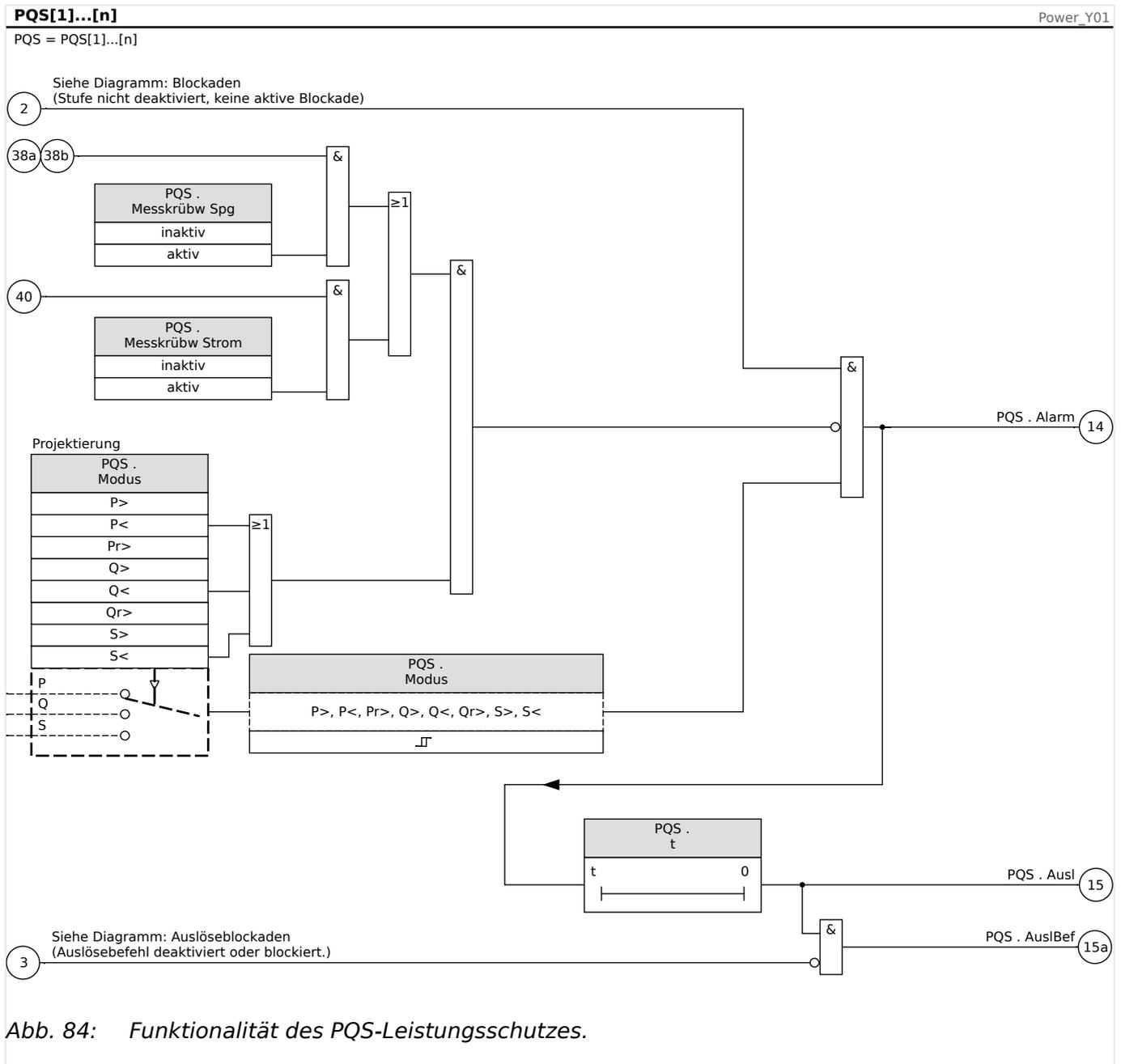
Abb. 84: Funktionalität des PQS-Leistungsschutzes.
