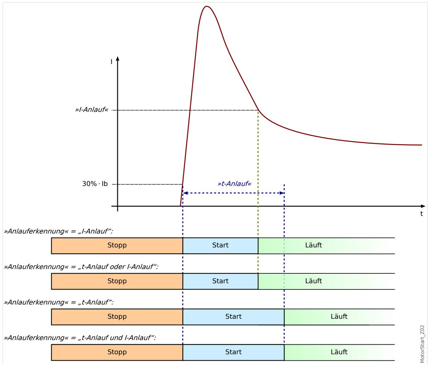
Die Parameter für die Startüberwachung müssen im Menü [Schutzparameter / Globale Schutzpara / MStart / Startmanager] eingestellt werden.
