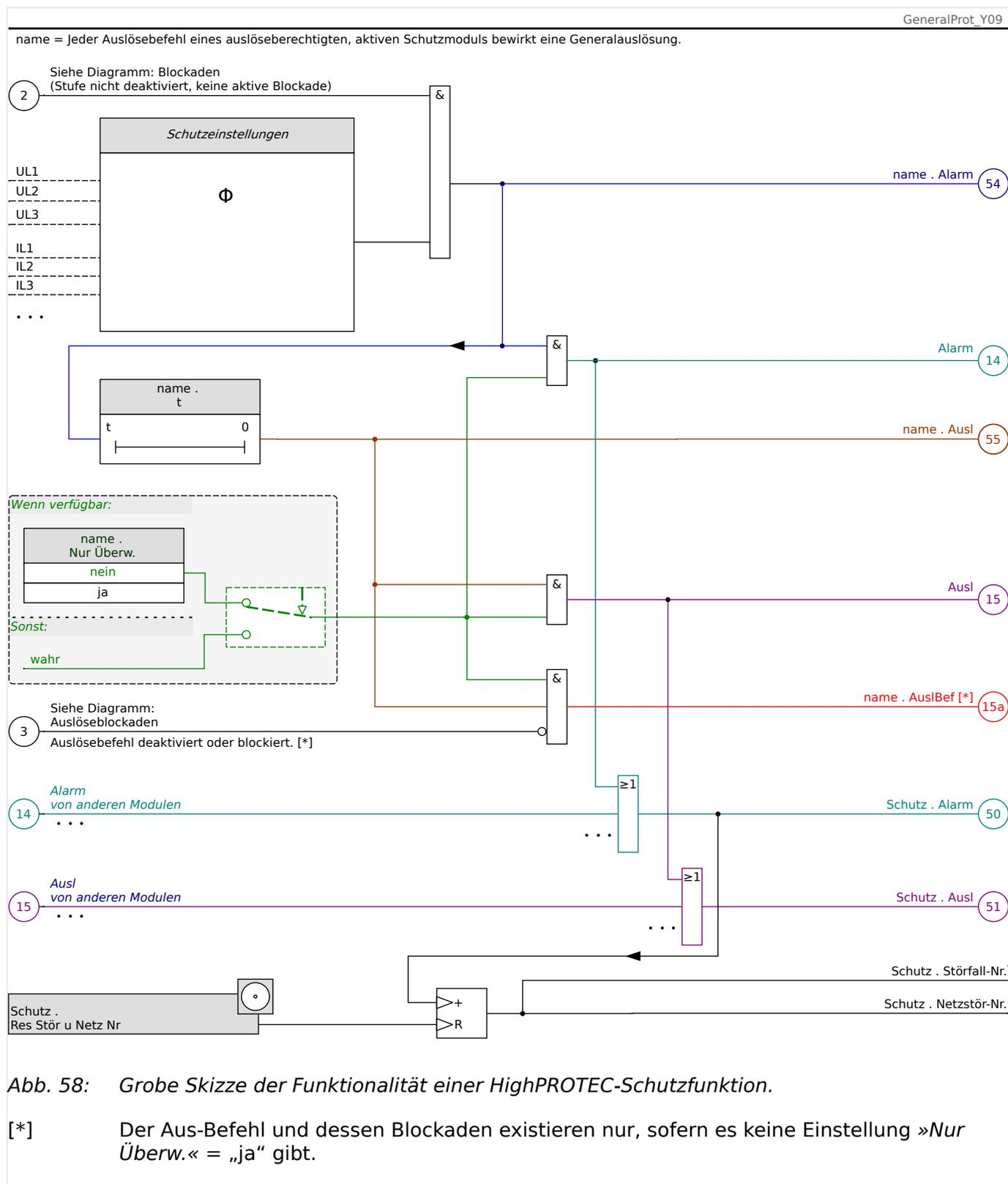
Das Diagramm zeigt das grundlegende Konzept hinter einer Schutzfunktion. (Beachten Sie dennoch, dass es bei den implementierten Schutzfunktionen gerätespezifische und auch schutzspezifische Unterschiede geben kann: Einige Gerätetypen haben keine Spannungsmessung, andere keine Strommessung, einige Schutzfunktionen verfügen über ein anderes Zeitstufenkonzept und/oder phasenspezifische Algorithmen, usw. Die exakte Funktionalität ist somit immer im jeweiligen Handbuchkapitel nachzusehen.)
