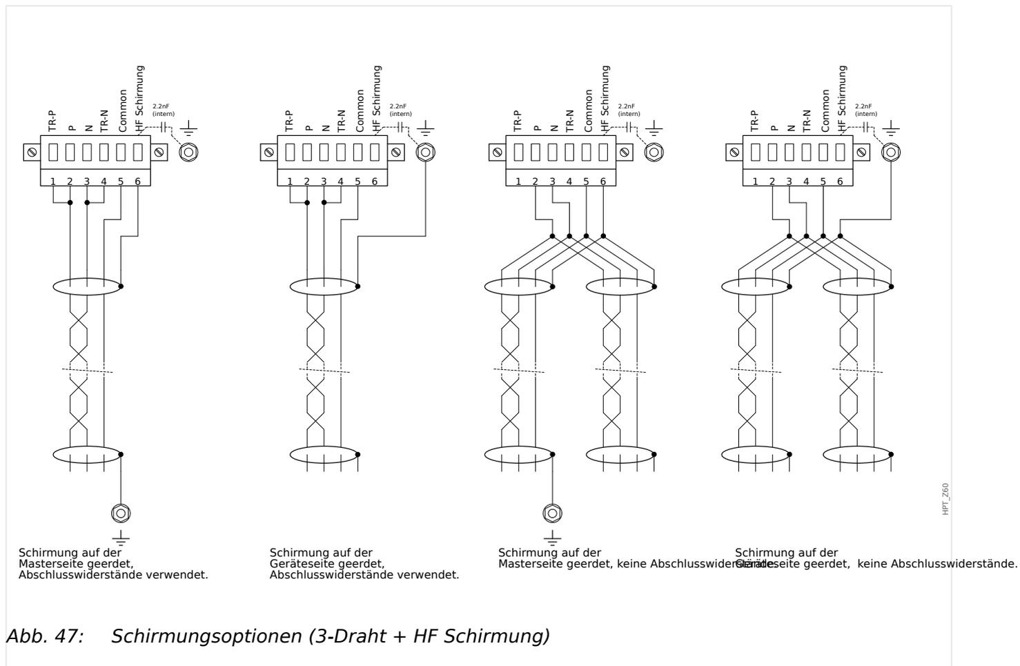
Abb. 47: Schirmungsoptionen (3-Draht + HF Schirmung)
