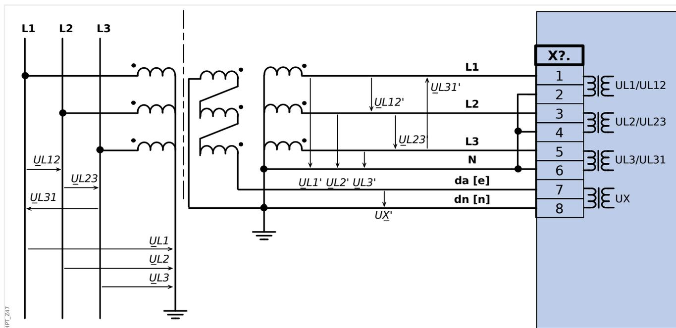
Abb. 29: Spannungswandler mit Geräteanschluss in offener Dreieckschaltung.
