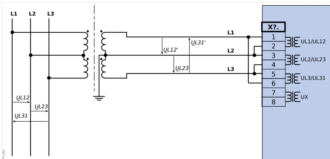
Abb. 32: Zwei Spannungswandler mit Geräteanschluss in V-Schaltung
