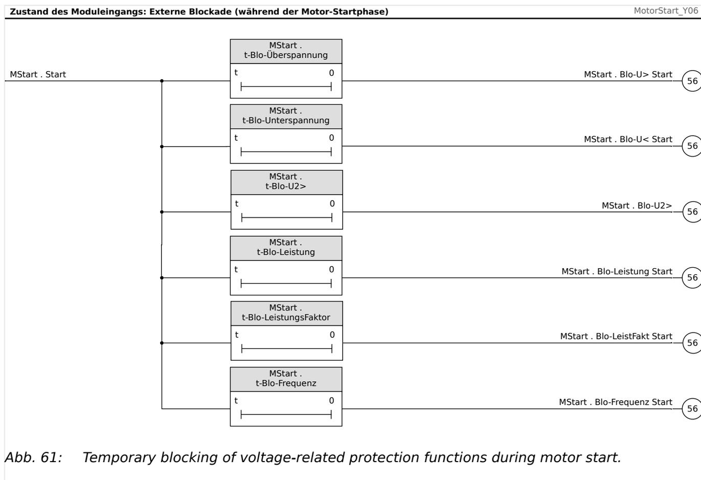
Die Einstellparameter für alle diese Zeitstufen sind im Menü [Schutzparameter / Globale Schutzpara / MStart / Startverzöger] verfügbar.
