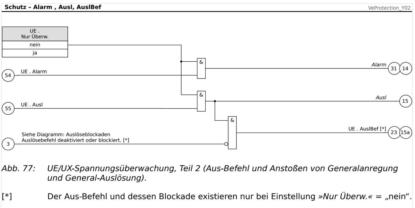
Abb. 77: UE/UX-Spannungsüberwachung, Teil 2 (Aus-Befehl und Anstoßen von Generalanregung und General-Auslösung).
