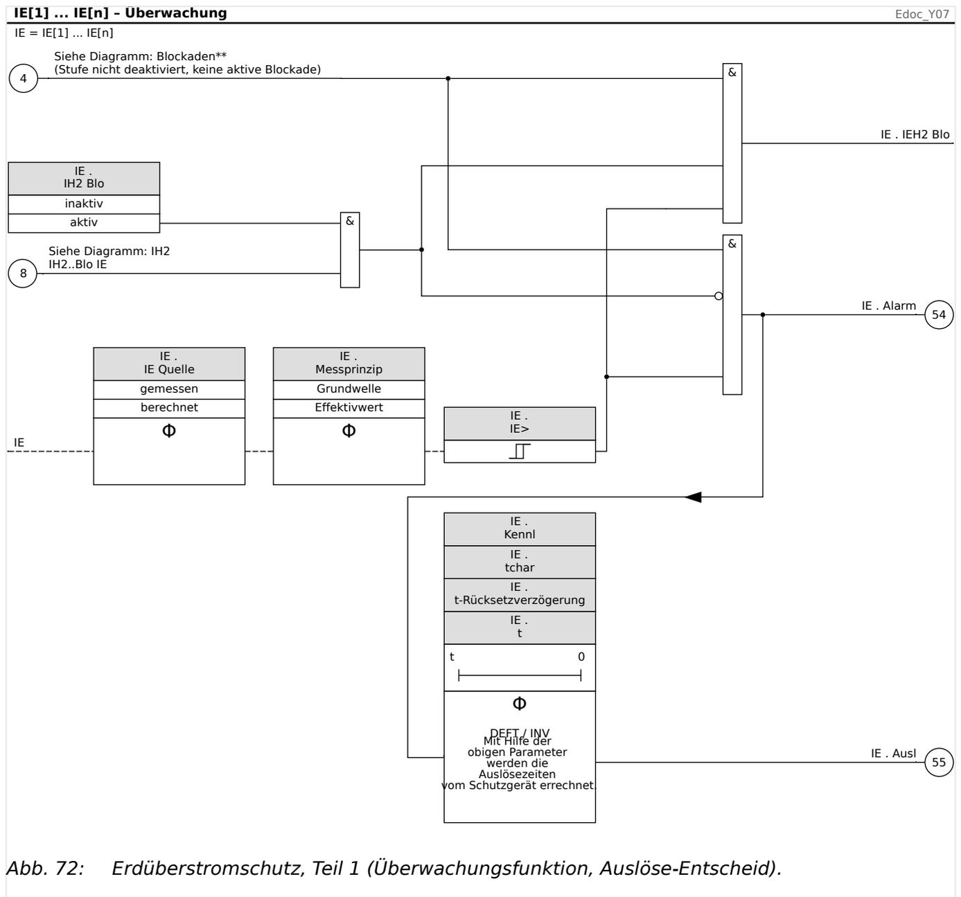
Abb. 72: Erdüberstromschutz, Teil 1 (Überwachungsfunktion, Auslöse-Entscheidung).
