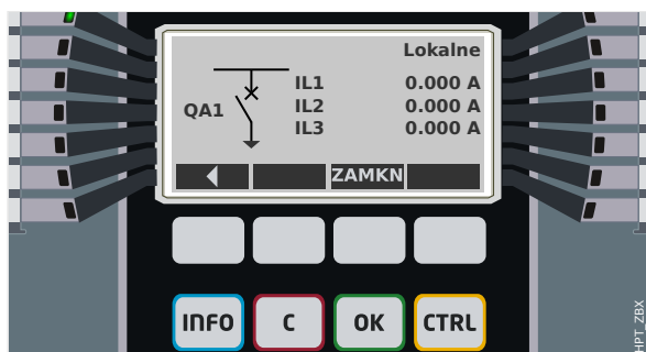
Rys. 93: Przykład strony sterowania z wyłącznikiem w pozycji otwartej.
