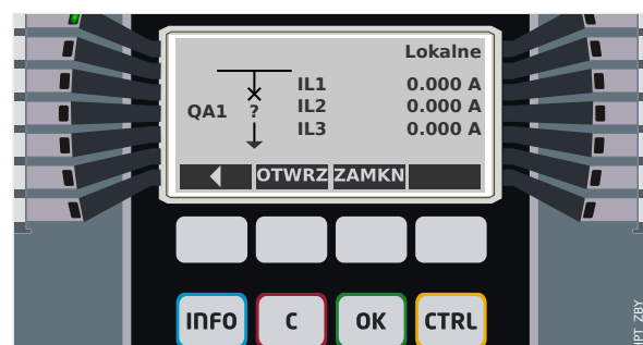
Rys. 92: Przykład strony sterowania z wyłącznikiem w pozycji zakłóconej (lub nieprawidłowej).
