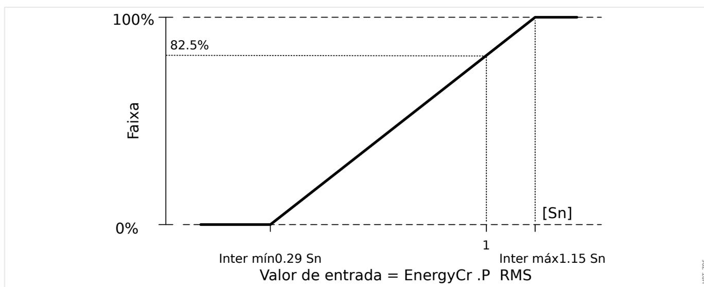
**Exemplo de configuração: Saída analógica com fator de energia PF\***
