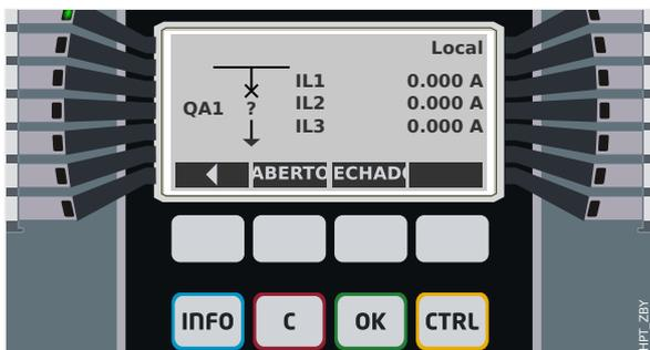
Fig. 92: Exemplo de página de controle, com o "Disjuntor" na posição de falha (ou implausível).
