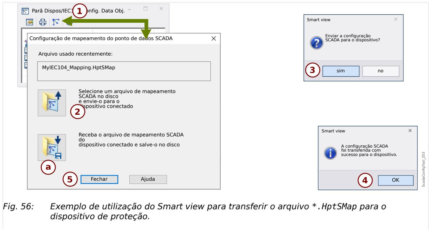
Fig. 56: Exemplo de utilização do Smart view para transferir o arquivo \*.HptSMap para o dispositivo de proteção.
