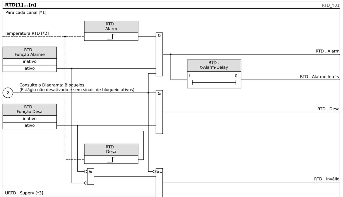
Fig. 86: O princípio geral de funcionamento (alarme atrasado, disparo sem atraso).
