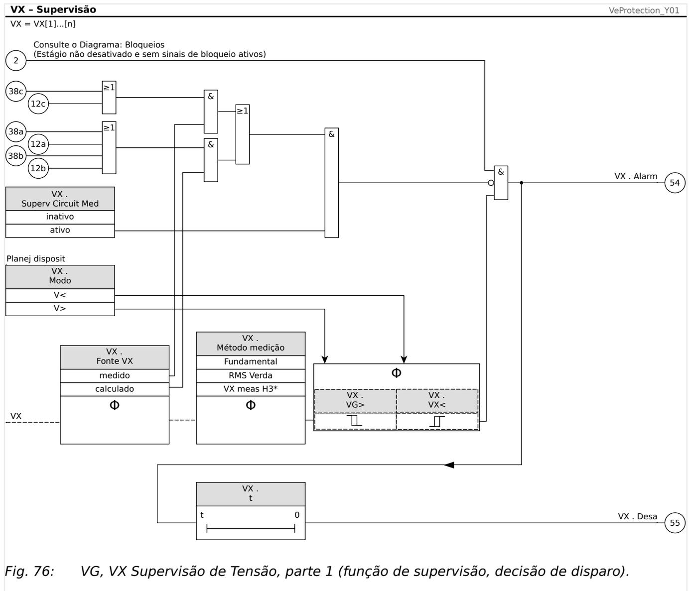
Fig. 76: VG, VX Supervisão de Tensão, parte 1 (função de supervisão, decisão de disparo).
