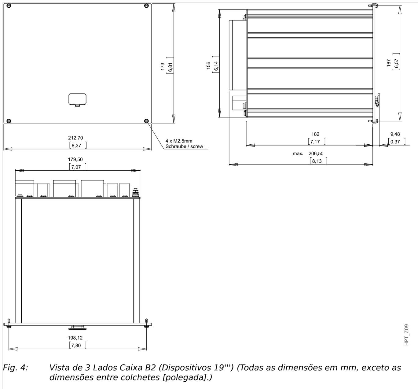
**Visão de três lados - Variante para montagem de porta****AVISO!**
