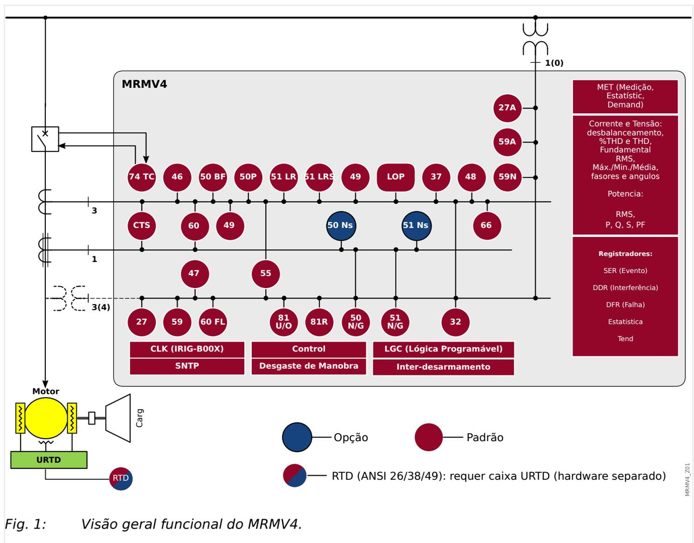
Fig. 1: Visão geral funcional do MRMV4.
