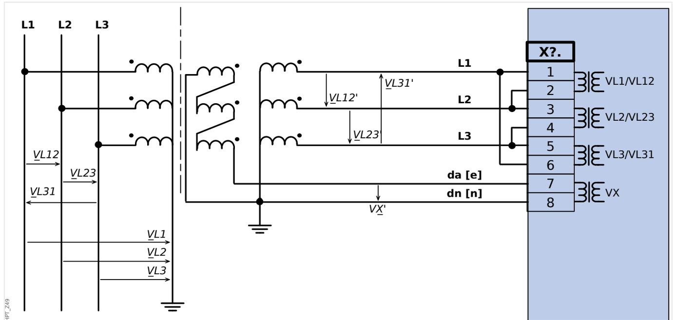
Fig. 31: Medição VG tensão residual por meio de "delta aberto" (e-n) de circuito auxiliar
