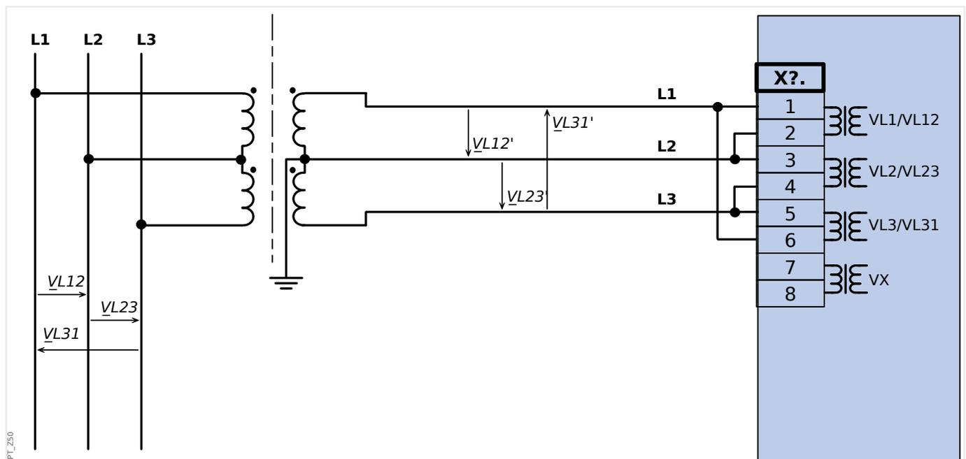
Fig. 32: Medição de tensão bifásica - fiação das entradas de medição: "Delta Aber"
