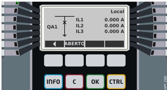
Fig. 91: Exemplo de página de controle, com o "Disjuntor" na posição fechada.
