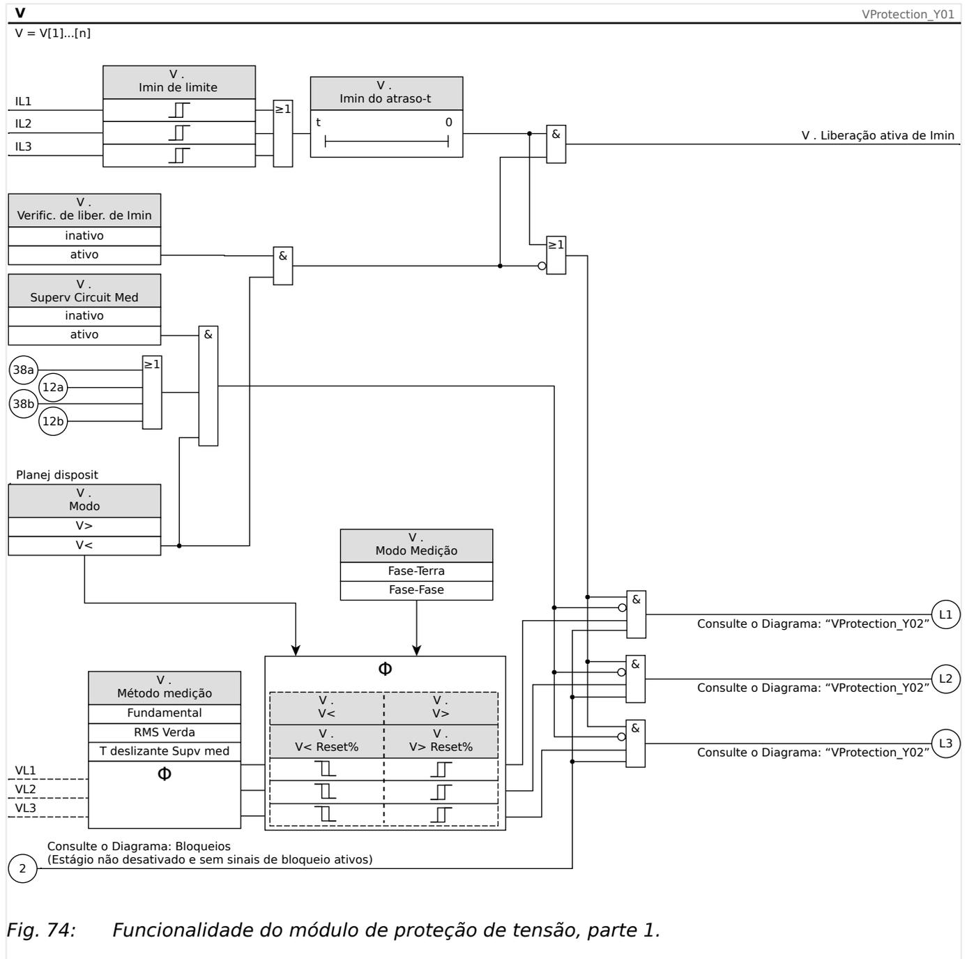
Fig. 74: Funcionalidade do módulo de proteção de tensão, parte 1.
