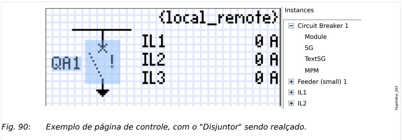
Fig. 90: Exemplo de página de controle, com o "Disjuntor" sendo realçado.
