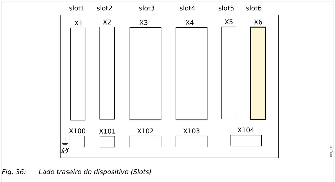
Fig. 36: Lado traseiro do dispositivo (Slots)
