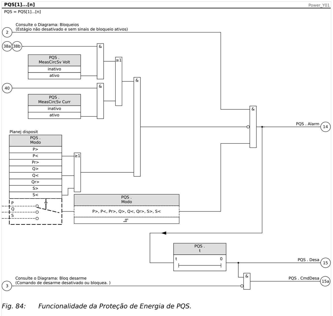
Fig. 84: Funcionalidade da Proteção de Energia de PQS.
