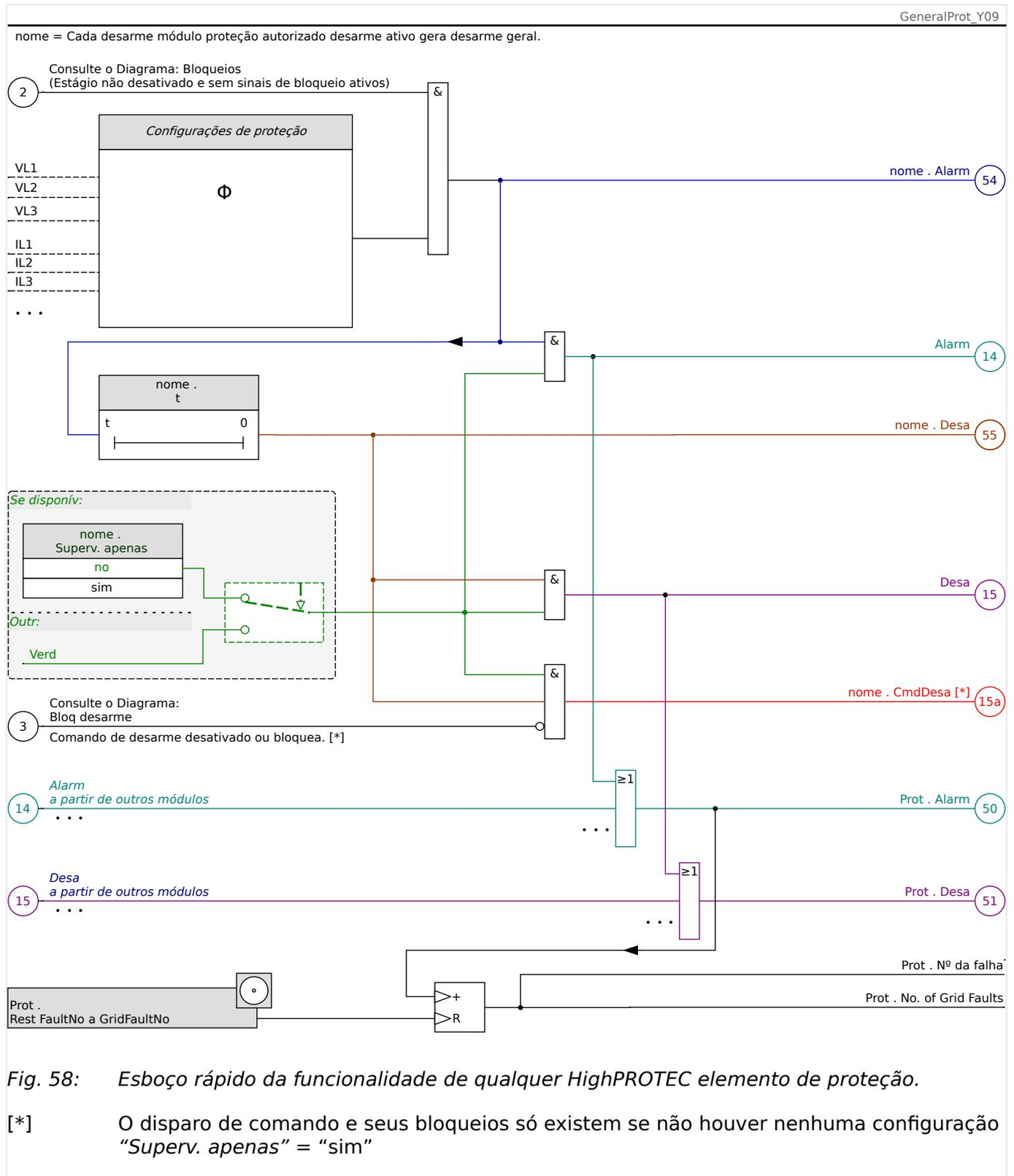
Este diagrama mostra a ideia básica por trás de um elemento de proteção. (No entanto, tenha em mente que são possíveis os desvios específicos da proteção ou do dispositivo: Alguns dispositivos não possuem medição de tensão, outros não apresentam a medição de corrente; para alguns elementos de proteção, são necessários outros temporizadores e/ou algoritmos específicos da fase, etc. Assim, para ver a funcionalidade exata de um módulo de proteção, consulte o respectivo capítulo).
