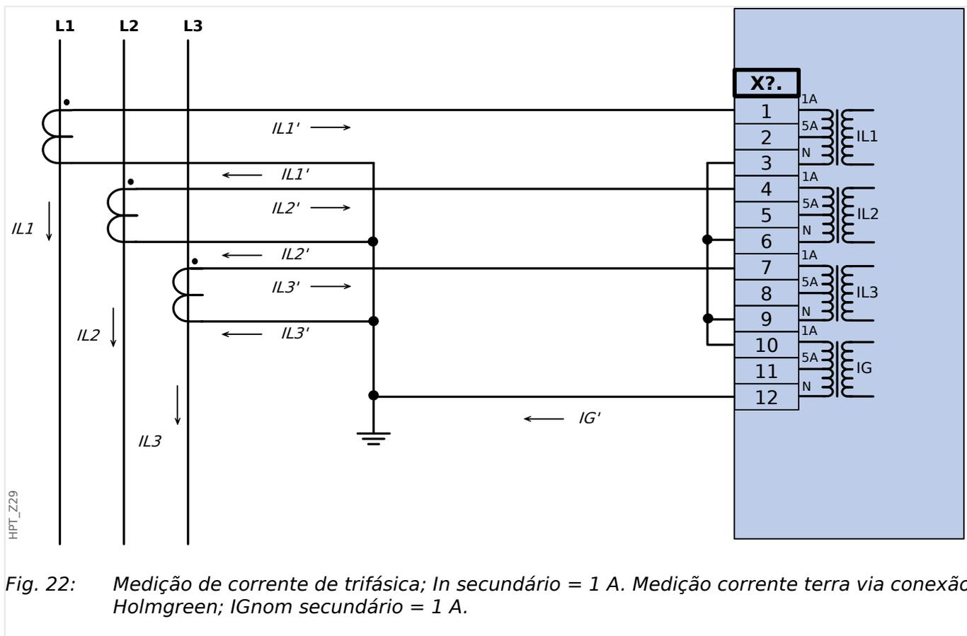
Fig. 22: Medição de corrente de trifásica;  $I_n$  secundário = 1 A. Medição corrente terra via conexão Holmgren;  $IG_{nom}$  secundário = 1 A.
