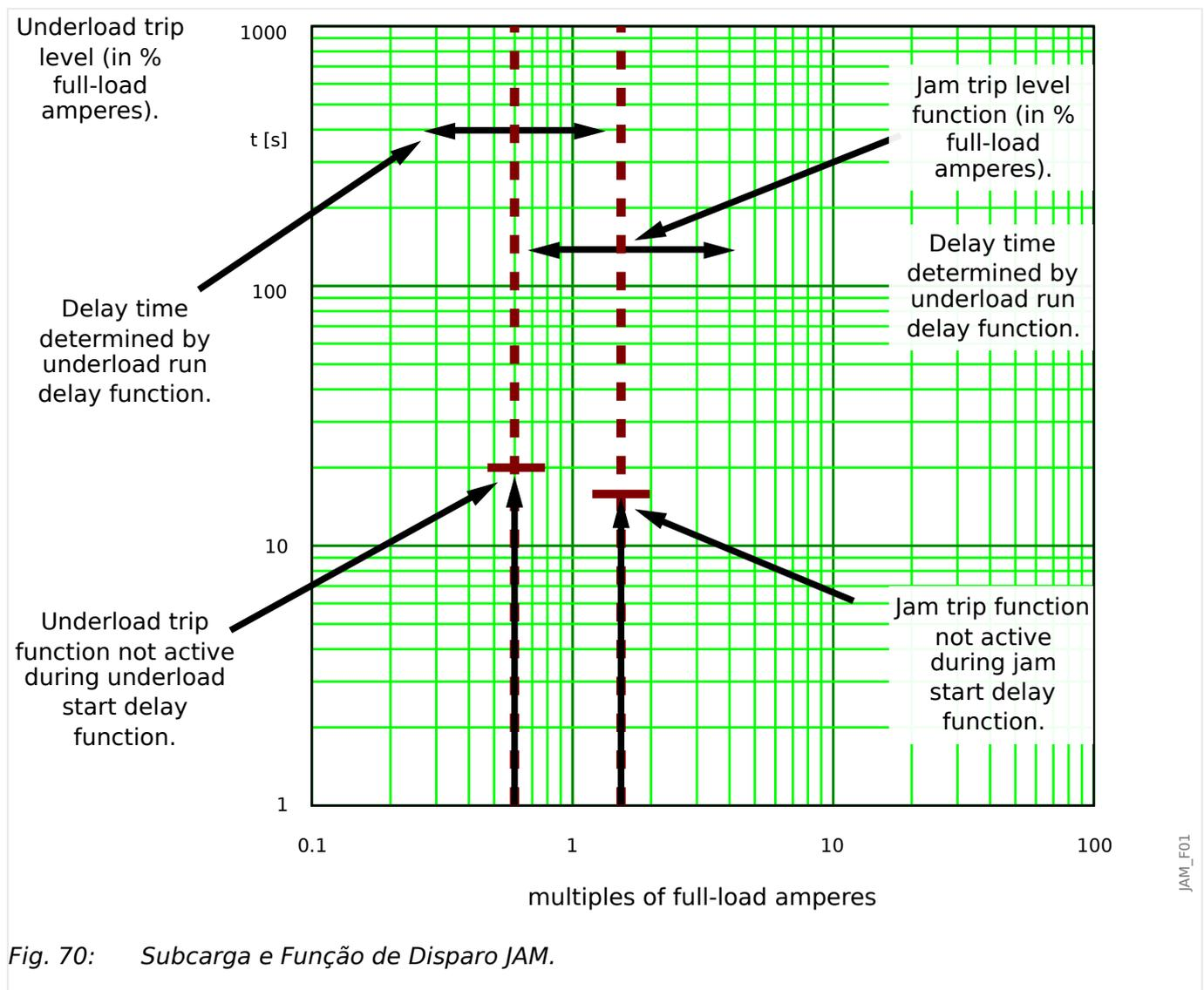
O MRMV4 emite um alarme quando o arranque [Parâm Proteção / Def 1...4 / JAM-Prot / Jam[x]] "Operaç" foi excedido. Se o temporizador [Planej disposit] Jam[x] . "Modo" = "ativo" e [Parâm Proteção / Def 1...4 / JAM-Prot / Jam[x]] "t" tiver decorrido, um sinal de disparo será emitido.
