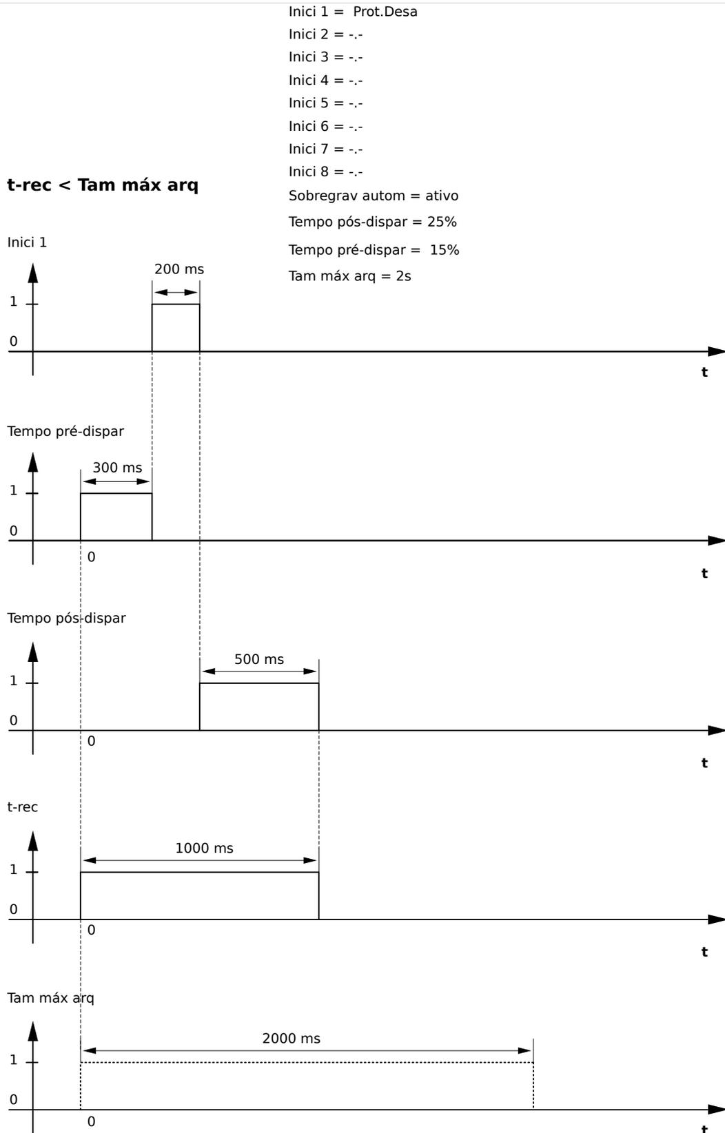
Fig. 100: Exemplo de Gráfico de Prazo do Gravador de Perturbação II
