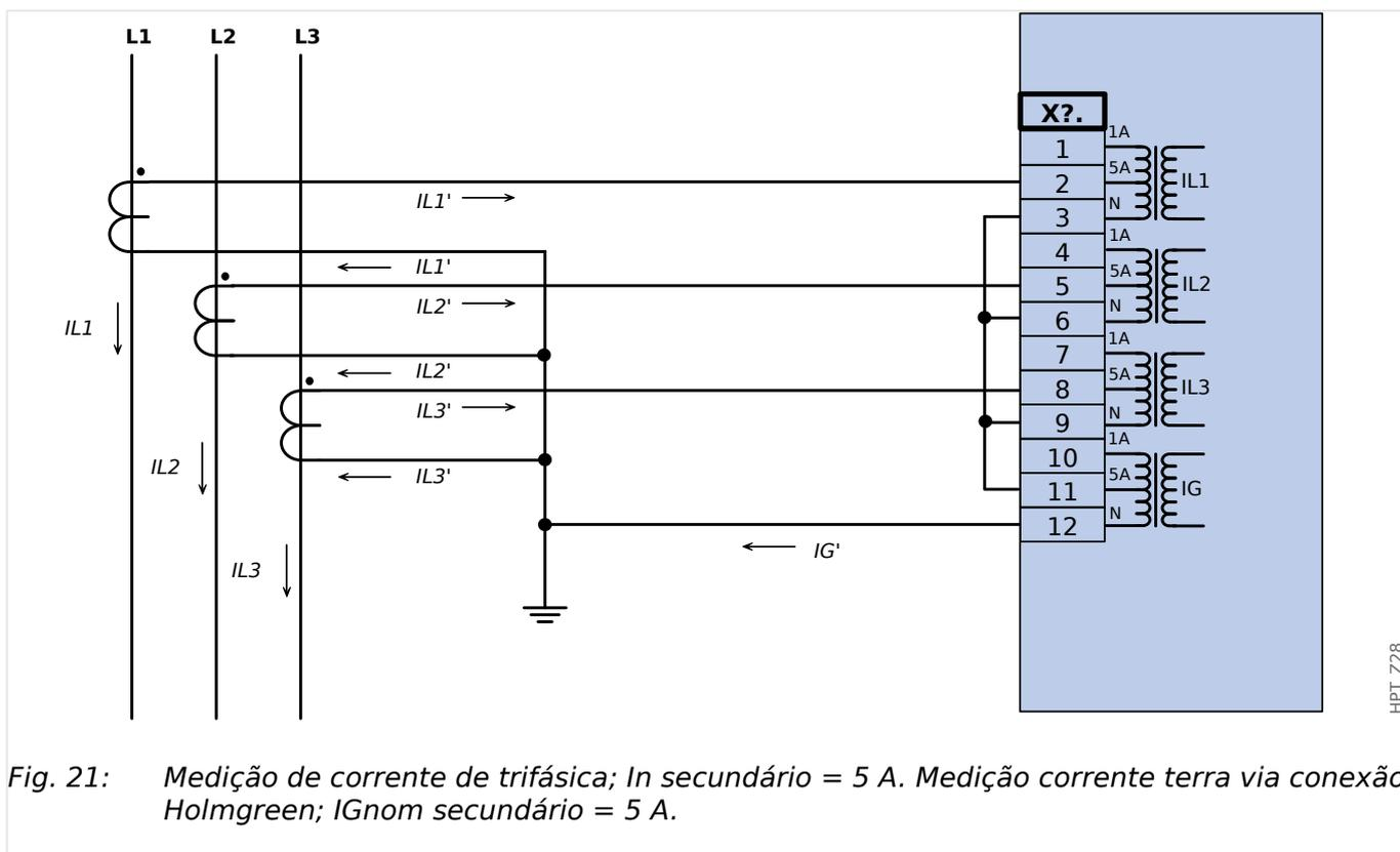
Fig. 21: Medição de corrente de trifásica;  $I_n$  secundário = 5 A. Medição corrente terra via conexão Holmgren;  $IG_{nom}$  secundário = 5 A.
