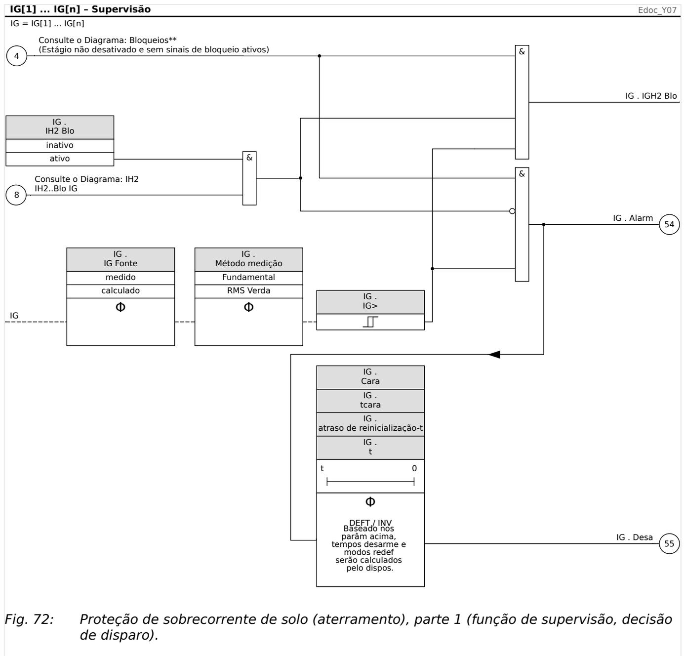
Fig. 72: Proteção de sobrecorrente de solo (aterramento), parte 1 (função de supervisão, decisão de disparo).
