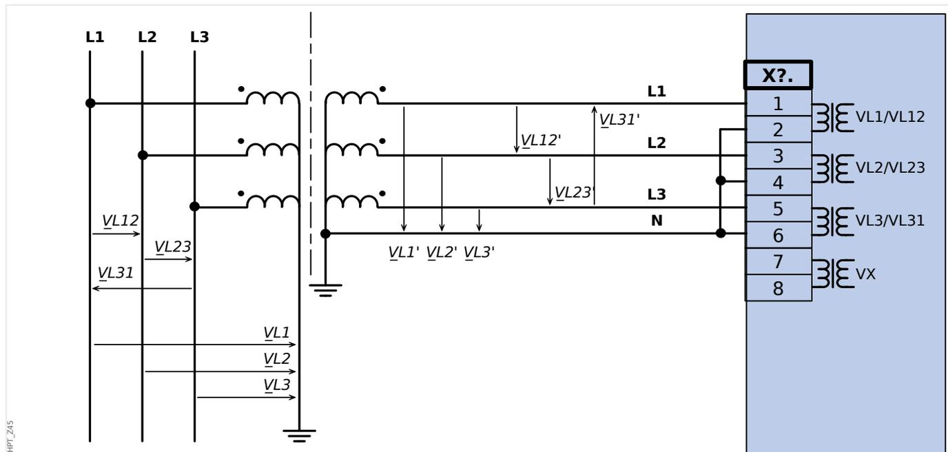
Fig. 28: VT Wye: Medição de voltagem trifásica - fiação das entradas de medição: "conexão estrela"
