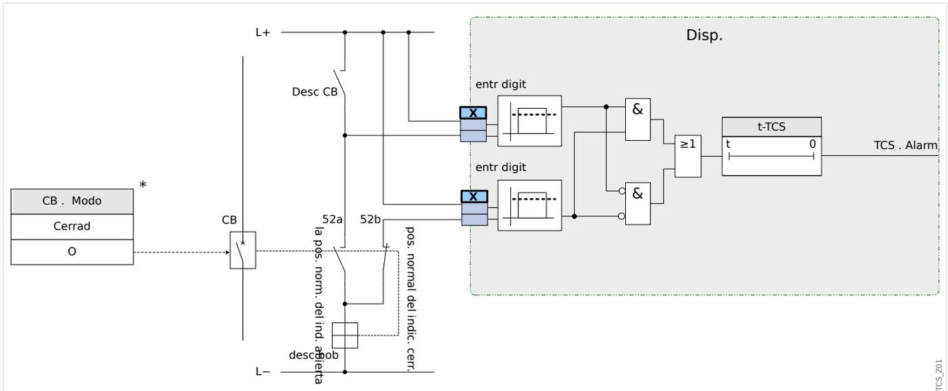
Fig. 61: Ejemplo de conexión: Supervisión del circuito de desconexión con dos contactos auxiliares CB »Aux ON« (52a) and »Aux OFF« (52b).
