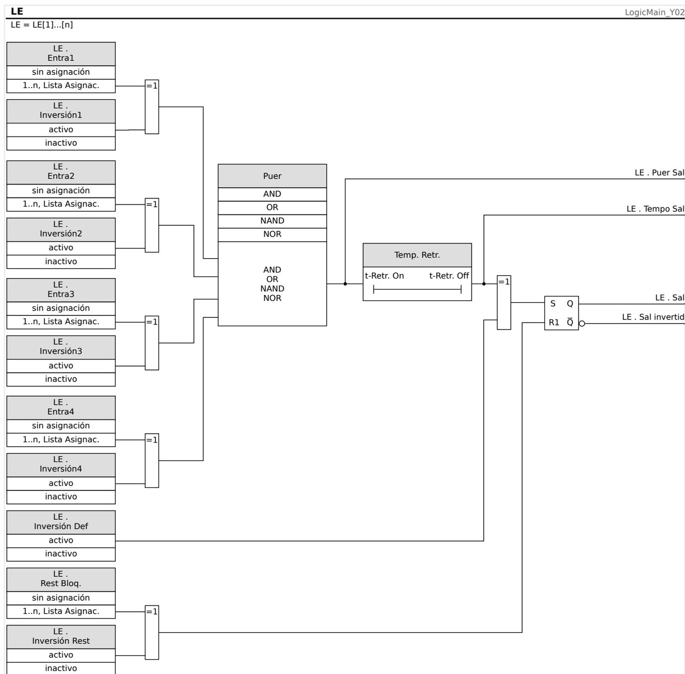
Fig. 74: Descripción detallada - Diagrama de lógica general.
