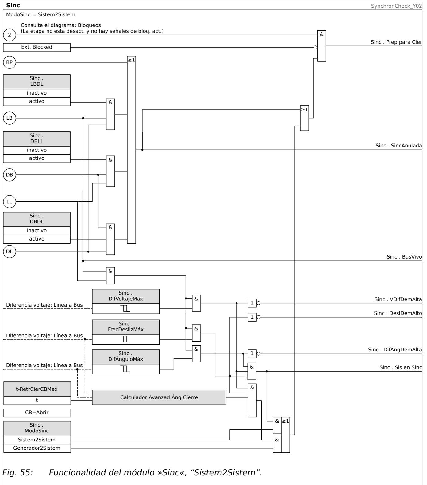
Ajuste: [Parám protec / Def x / Intercon-Prot / Sinc / Modo/Veces] »ModoSinc« = "Sistem2Sistem"
