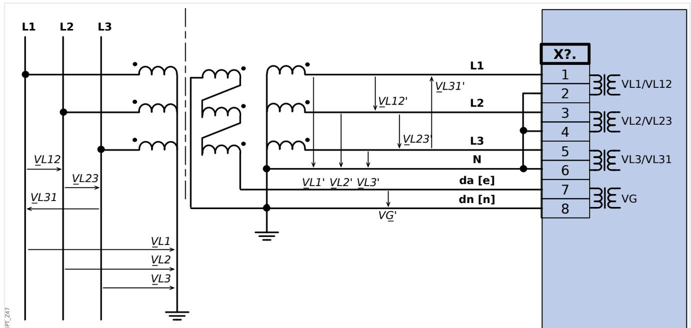
Fig. 18: VT Wye con conexión delta interrumpida.
