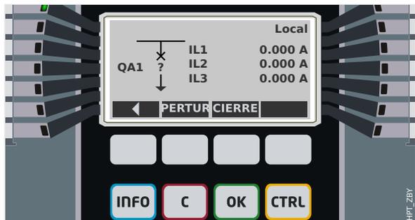
Fig. 65: Ejemplo de página de control, con el circuito en posición de fallo (o improbable).
