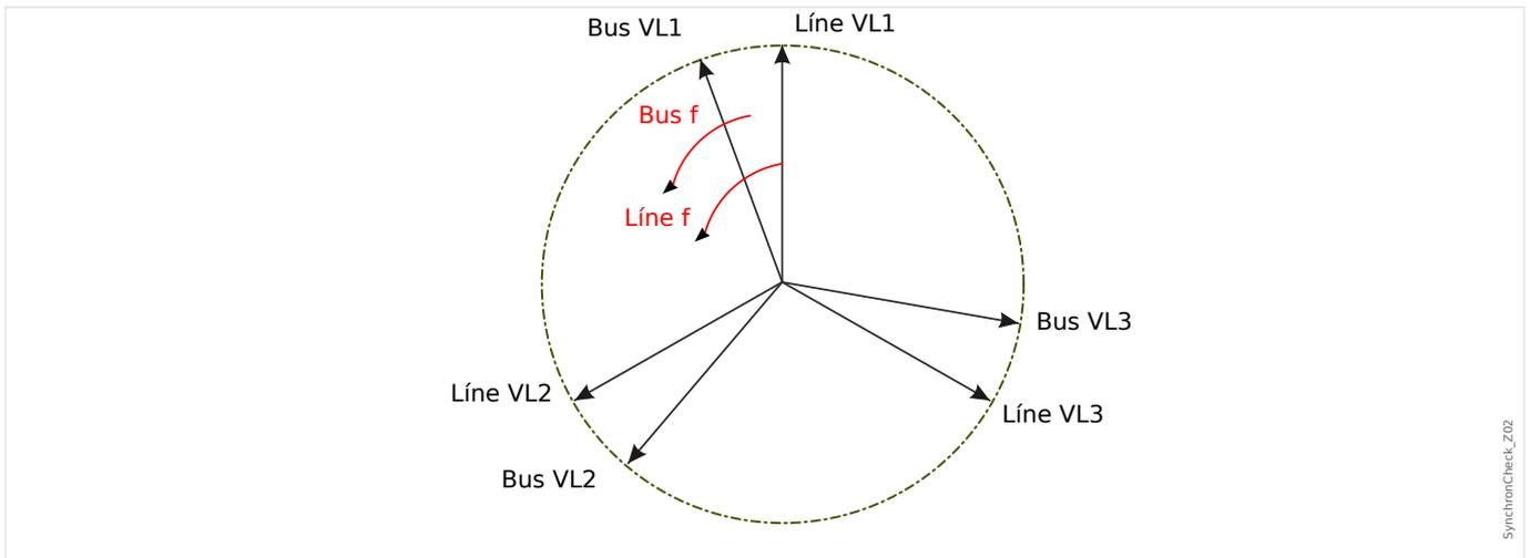
Si la frecuencia del generador  $f_{\text{Bus}}$  no es igual a la frecuencia de la red  $f_{\text{Line}}$ , provoca una frecuencia de deslizamiento  $\Delta f = |f_{\text{Bus}} - f_{\text{Line}}|$  entre las dos frecuencias del sistema.
