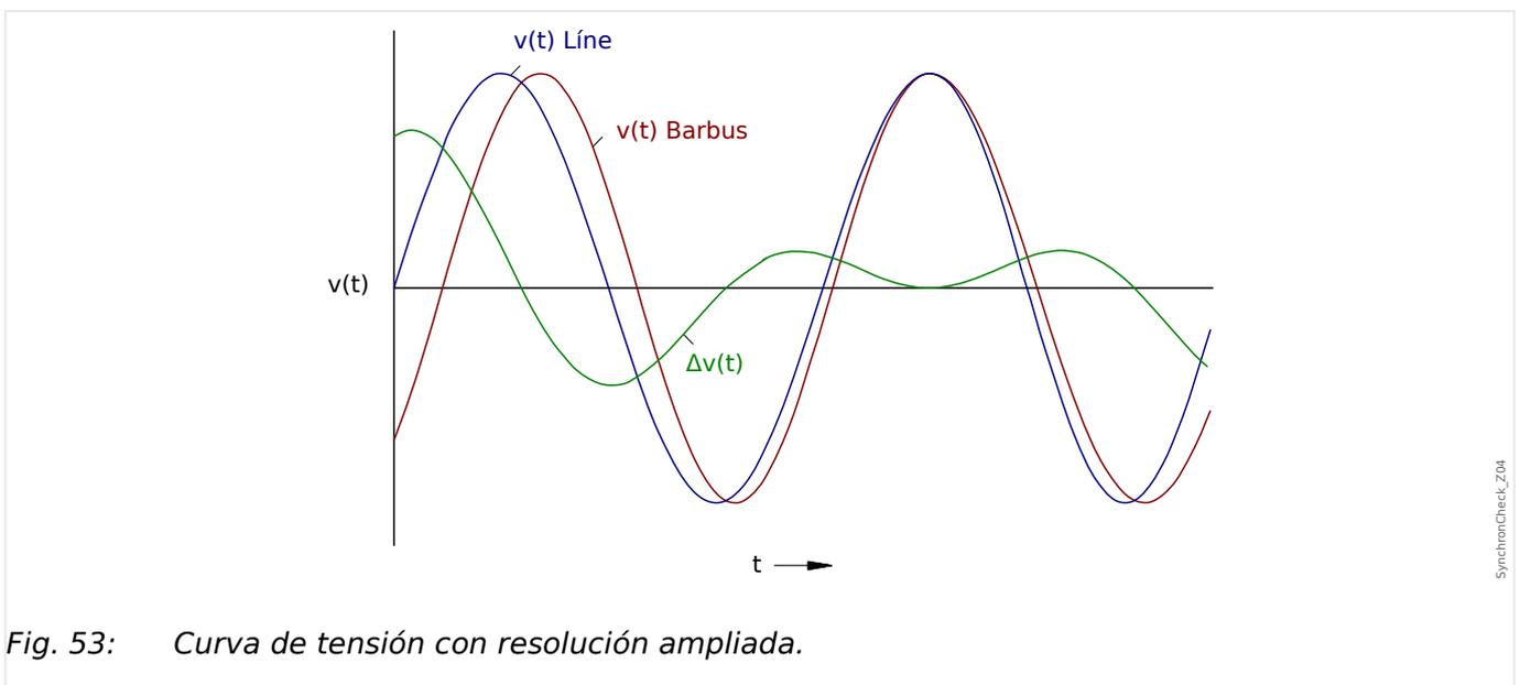
Fig. 53: Curva de tensión con resolución ampliada.
