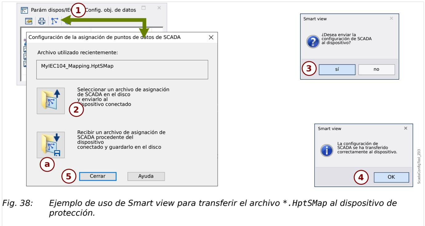
Fig. 38: Ejemplo de uso de Smart view para transferir el archivo \*.HptSMap al dispositivo de protección.
