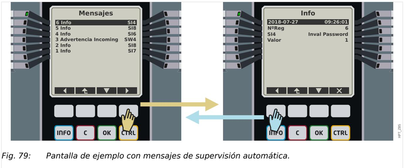
Fig. 79: Pantalla de ejemplo con mensajes de supervisión automática.
