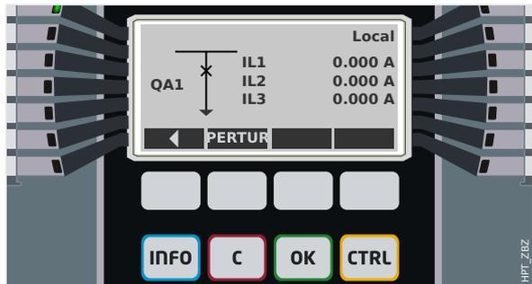
Fig. 64: Ejemplo de página de control, con el circuito en posición cerrada.
