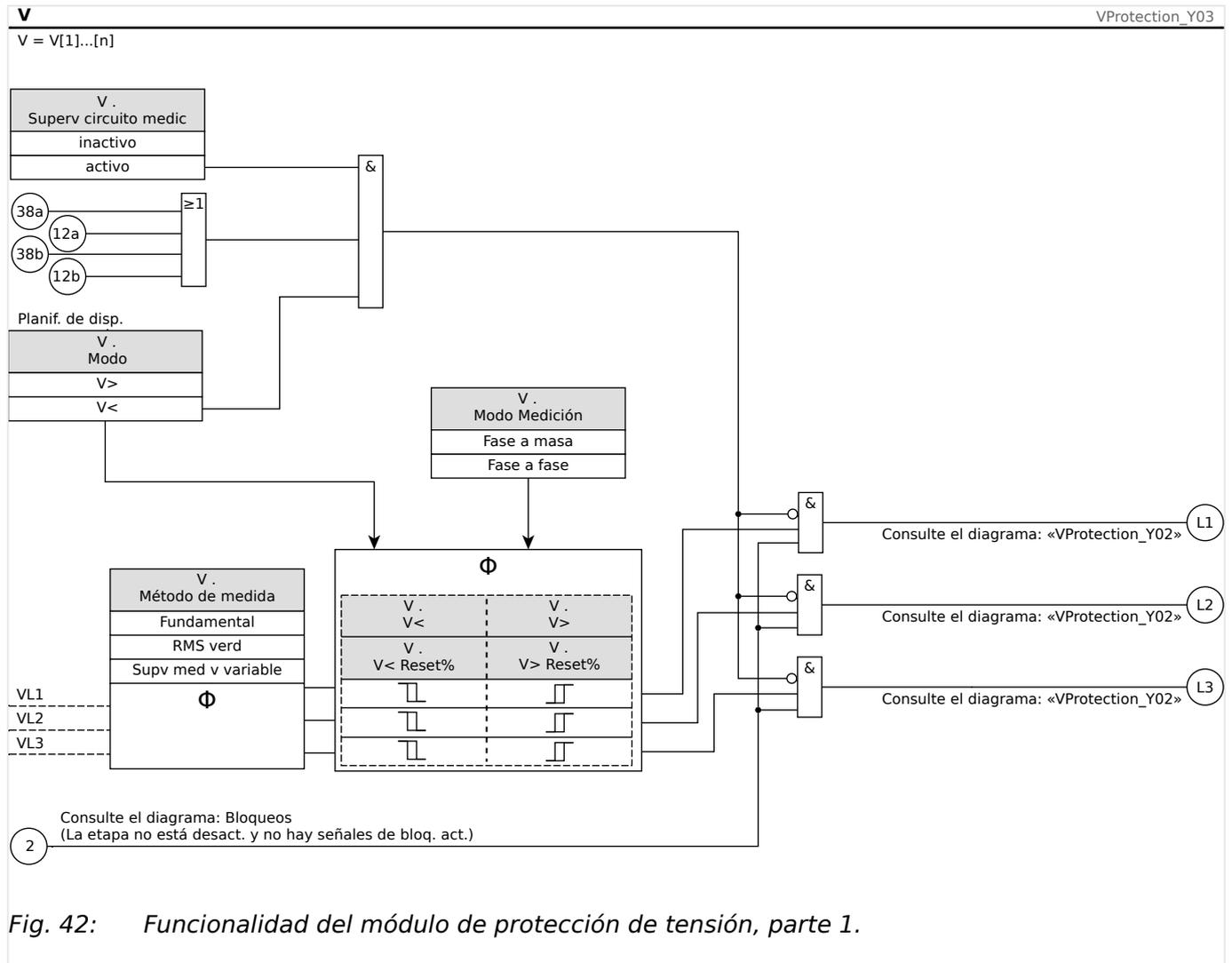
Fig. 42: Funcionalidad del módulo de protección de tensión, parte 1.
