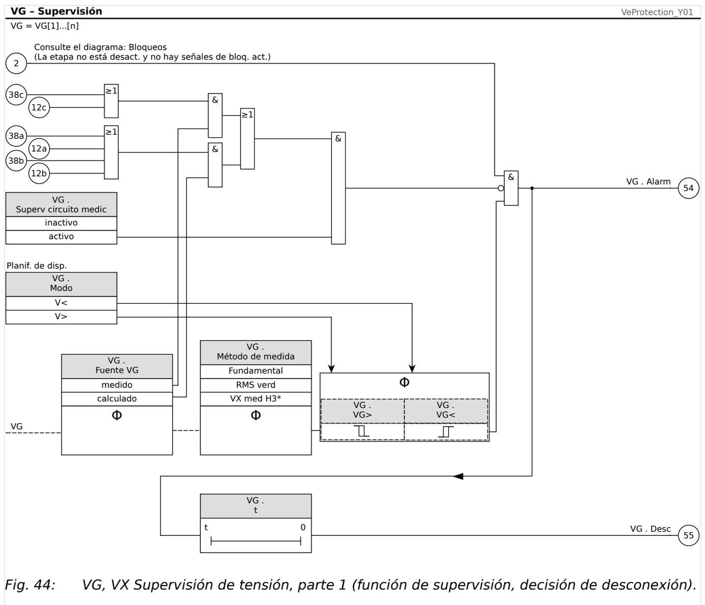
Fig. 44: VG, VX Supervisión de tensión, parte 1 (función de supervisión, decisión de desconexión).
