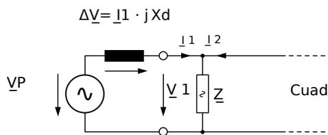
Fig. 46: Circuito equivalente en generador síncrono en paralelo con la red de suministro eléctrico.
