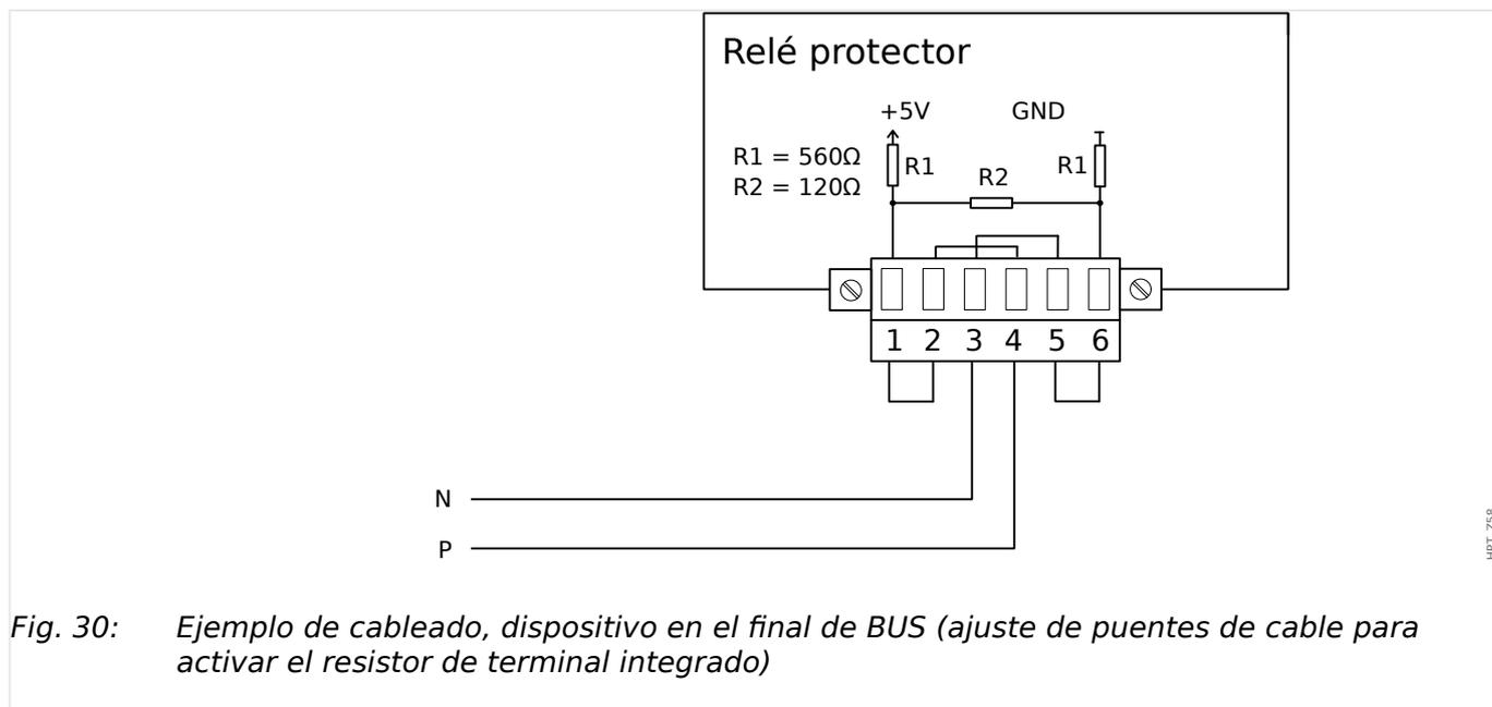
Fig. 30: Ejemplo de cableado, dispositivo en el final de BUS (ajuste de puentes de cable para activar el resistor de terminal integrado)
