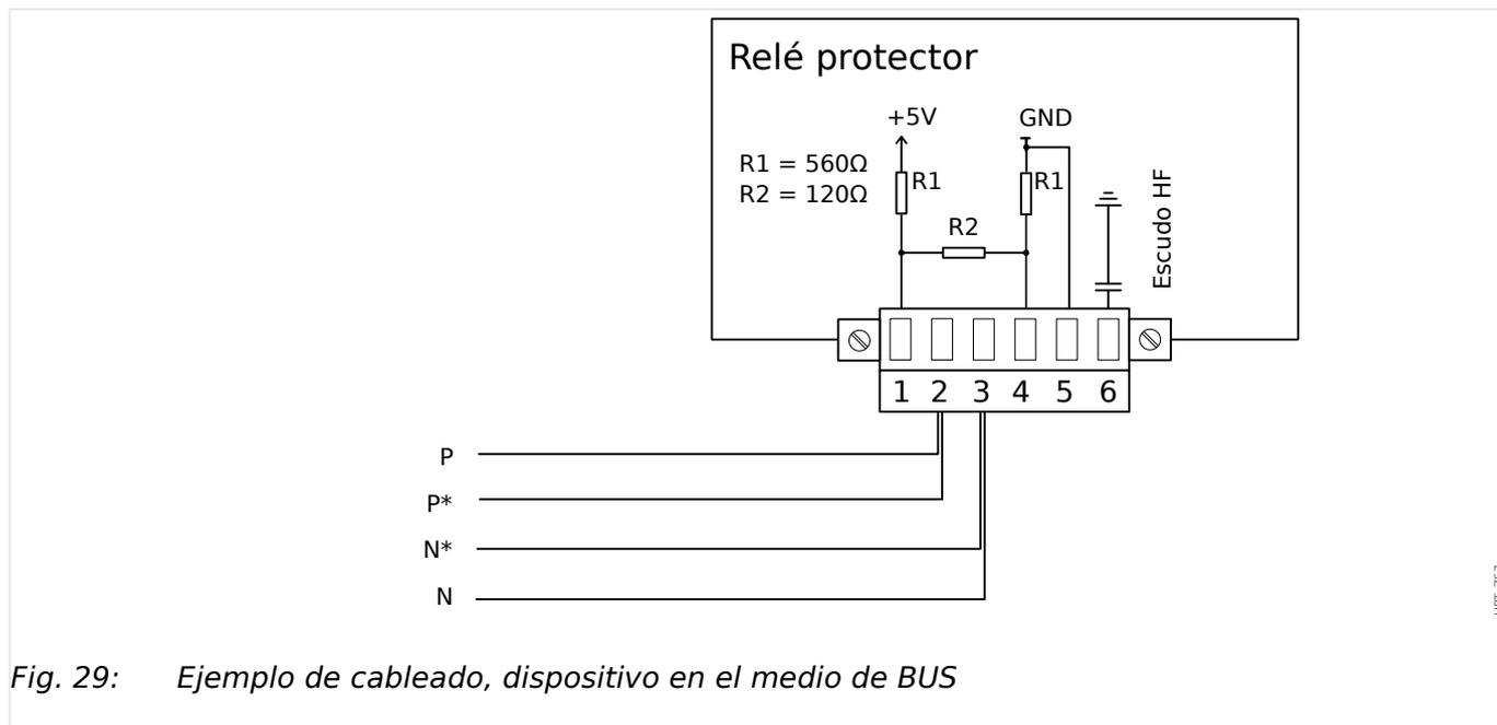
Fig. 29: Ejemplo de cableado, dispositivo en el medio de BUS
