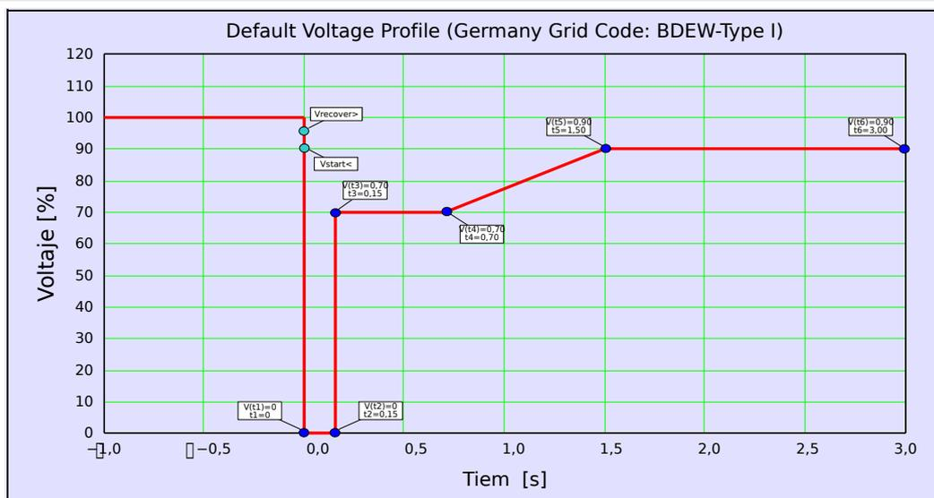
Fig. 59: Perfil de LVRT predeterminado (Tipo I de BDEW).
