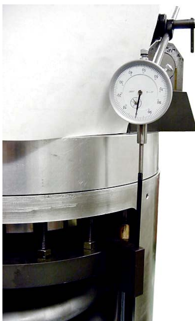
Rysunek 5-2. Pasek do pomiaru skoku
