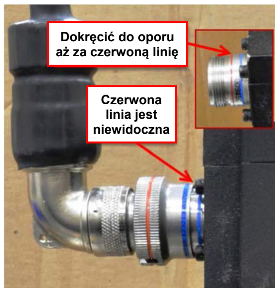
Rysunek 3-9. Złącza resolwera silnika
