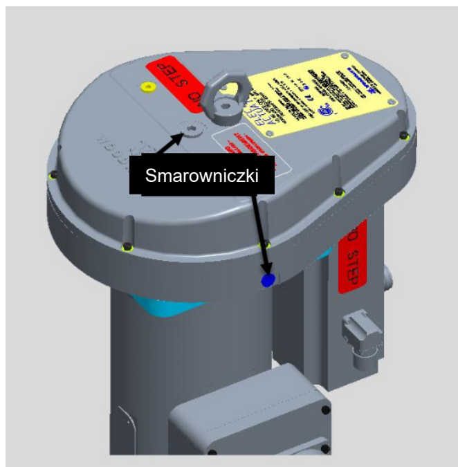
Rysunek 3-1. Lokalizację smarowniczek 2-calowego LESV II
