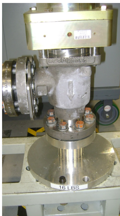
Rysunek 3-6. Kołnierz podpierający przymocowany śrubami do kołnierza wylotowego
